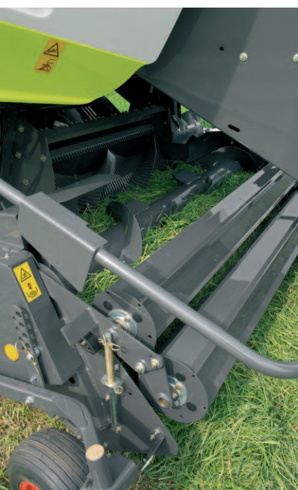
Das «Power Feeding»-System der neuen Quadrant-Pressen.
