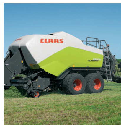
Die neue «Quadrant 3300 RC» hat ein 25-Messer-Schneidwerk.
