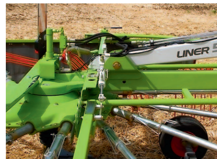
Der «Liner 500 Profil» hat eine kardanische Kreiselaufhängung.
