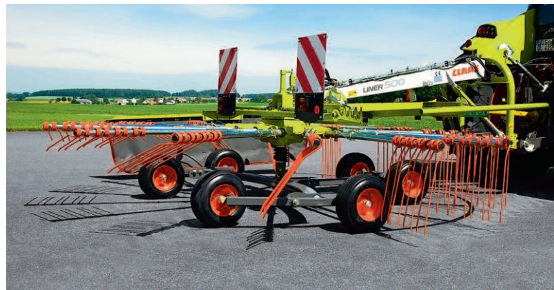
Das Dreipunkt-Modell «Liner 500 Profil» ist auf Wunsch mit einem Sechsrاد-Konturfahrwerk ausrüstbar.
