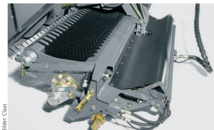
Die beidseitig ausziehbare Schublade der Quadrant-Pressen ermöglicht einen schnellen und mühelosen Zugang zu den Messern.
