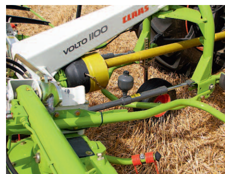
Hydropneumatische Kraftflusslenker stabilisieren den «Volto 1100»
