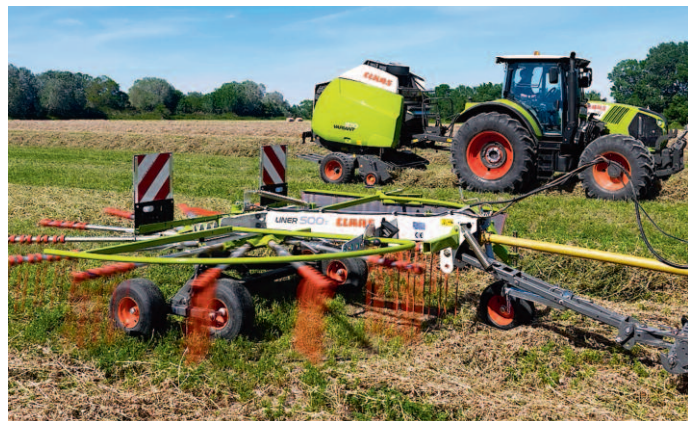
Beim gezogenen Modell «Liner 500 T» wird die Bodenführung des 4-Rad-Fahrwerks durch ein zusätzlich erhältliches Tastrad verbessert.
