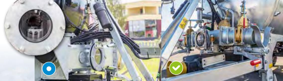
Pumpenkasten mit Schauglas und Fremdkörperabscheider
