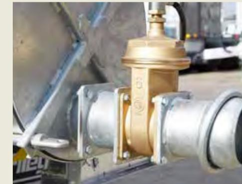
Glockenschieber hydraulisch für Vakuumfass, robust und unempfindlich gegen Rückstände (ideal für Strohgülle)
