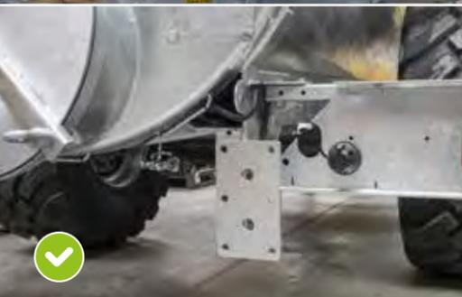
Anbaukonsole für Schlepptschlauch- oder Schlepptschuhverteiler SERIE ab 5000L
