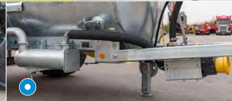
Schalldämpfer mit Ölabscheider
