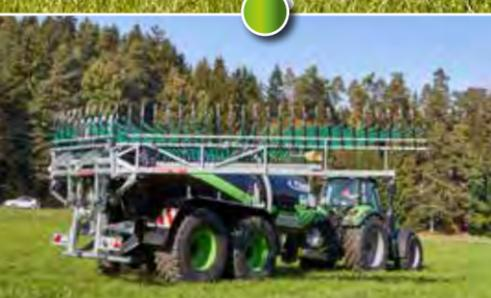
Keine abknickende Auslaufschläuche durch speziellen Klappmechanismus
