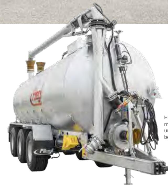
HFW 27.500 Tridem mit mechanischer Druckschleuder und Überladearm 6 m, beidseitig schwenkbar
