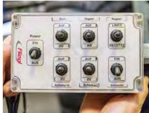
Bedienpult zur Fasssteuerung ohne Skate-Verteiler, bis zu 6 Sektionen
