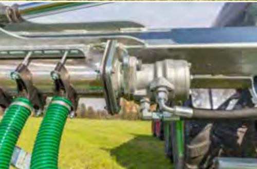
Ölmotor für Schneckenverteiler mit geringen Verschleiß und langer Lebensdauer. (erforderliche Ölmenge max. 20l)
