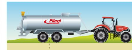
Optimale Anpassung der Stützlast durch mechanische Achsverschiebung oder stufenlos hydraulisch (optional). Auch bei Montage von Gülleverteilern wie z.B. Schleppschuh
