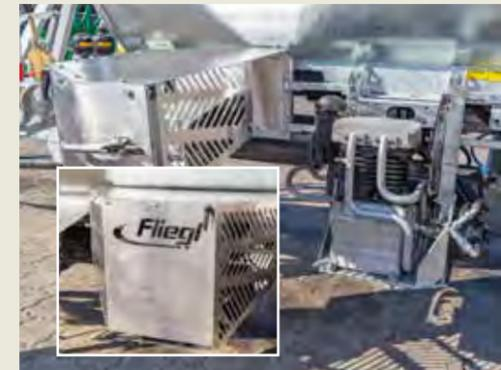
Kolbenkompressor mit bis 3,3 m<sup>3</sup> Luftleistung
