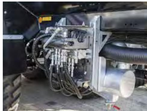
Steuerblock Load Sensing oder Konstantstrom
