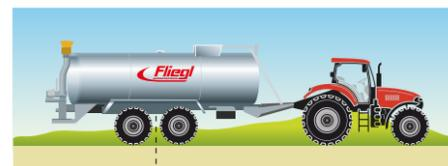
Optimale Anpassung der Stützlast durch mechanische Achsverschiebung (Serienausstattung) oder stufenlos hydraulisch (optional). Auch bei Montage von Gülleverteilern wie z.B. Schleppschuh
