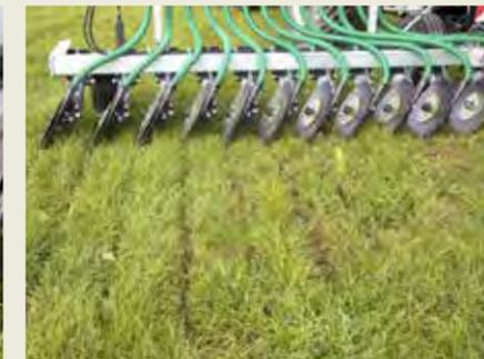
Durch die schräglage der Scheiben wird der Boden für die Direkteinbringung der Gülle geöffnet
