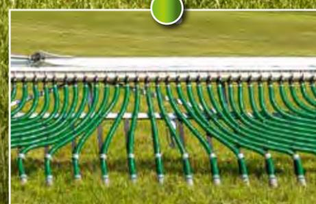
Gleichmäßige Verteilqualität durch kurze Auslaufschläuche
