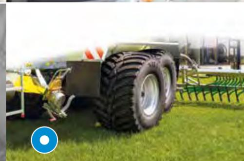
Teleskopachse (nur bei Pendelaggregat Boogie SB möglich)
