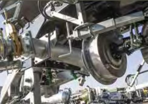
**Turbobefüller mittig unter Fass**
