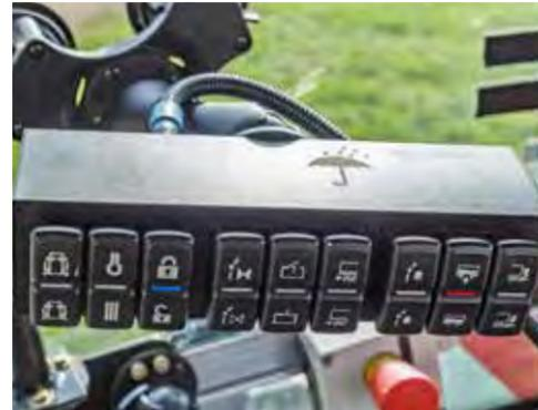
Bedienpult für Skate-Verteiler und Fass
