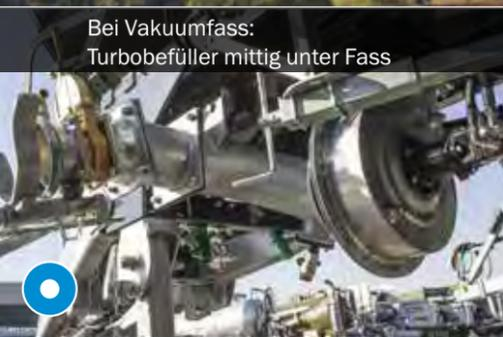
Bei Vakuumfass: Turbobefüller mittig unter Fass
