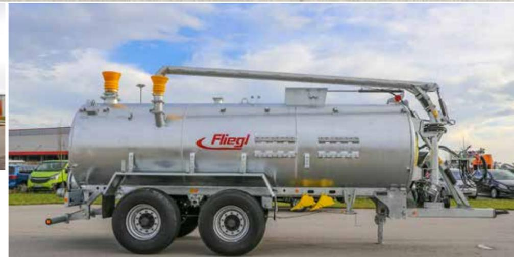
HFW 16.000 Tandem mit Kreiselpumpe und Überladearm, beidseitig schwenkbar
