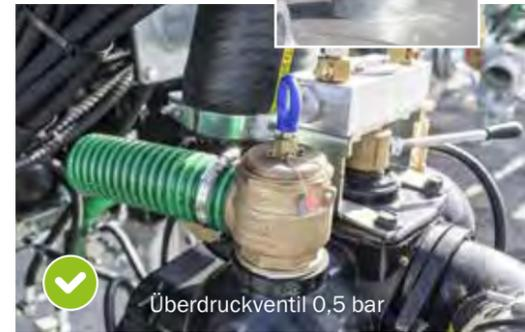
Überdruckventil 0,5 bar
