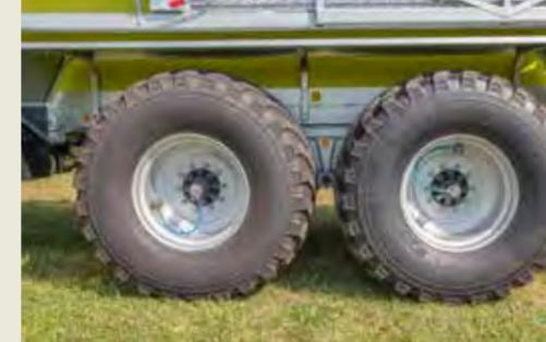
Reifendruckregelanlage für bodenschonenden Feldeinsatz mit und Zweileiteranlage
