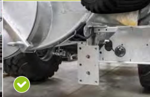
Anbaukonsole für Schleppl Schlauch- oder Schlepplschuhverteiler SERIE ab 5000 Liter
