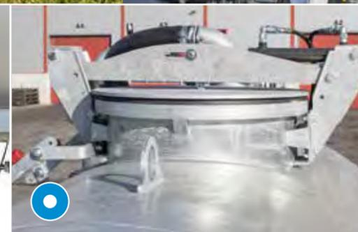
Hydraulischer Einfülldom (400 mm oder 600 mm)
