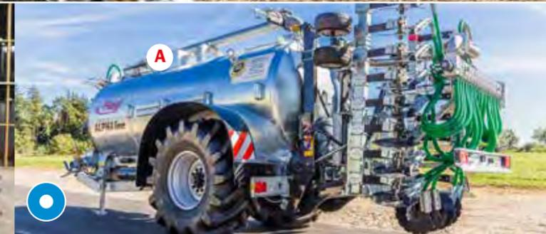
**A: Absaugarm** 4500mm Länge, beidseitig schwenkbar
