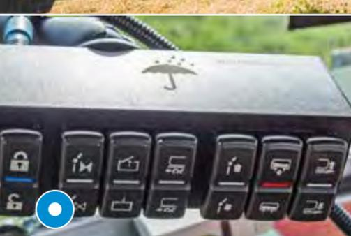
Bedienpult für Fass + Verteiler
