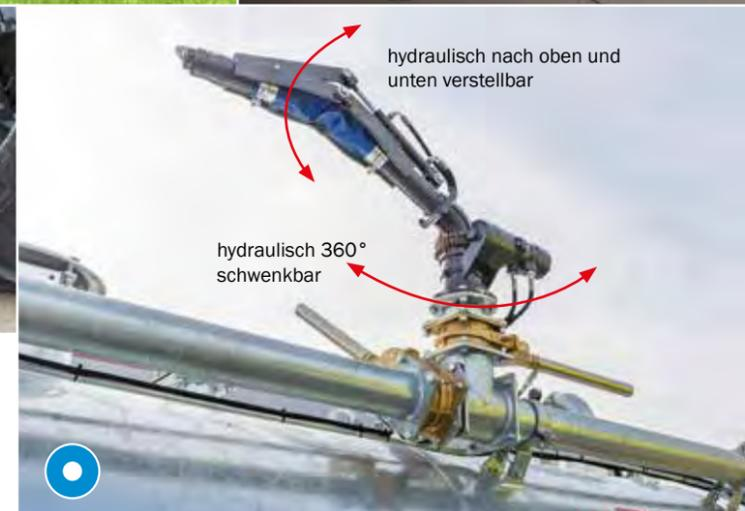
hydraulisch nach oben und unten verstellbar
