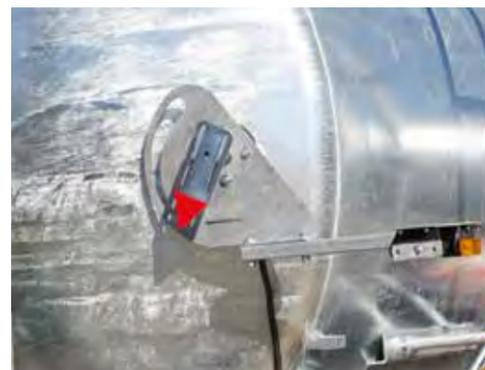
Füllstandsanzeiger mit Schwimmerkugel
