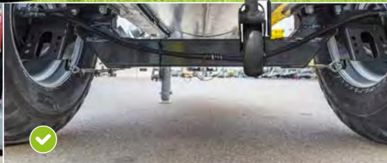
Ab 5000 Liter mit gekröpfter Achse: Niedriger Schwerpunkt sorgt für optimales Fahrverhalten am Hang
