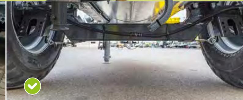
Ab 5000 Liter mit gekrüppter Achse: Niedriger Schwerpunkt sorgt für optimales Fahrverhalten am Hang
