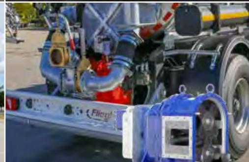
in Pumpausführung mit Vogelsang-Drehkolbenpumpe
