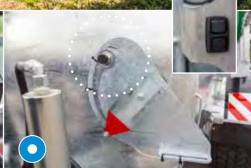
Sensor für automatische Pumpenumschaltung
