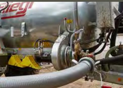
**Turbobefüller mit Schnellkuppler (6" oder 8")**
