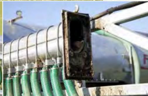
Staukastenentleerung bei Maulwurf, Güllegrubber und Scheibenschlitzgerät
