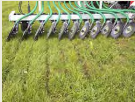
La position inclinée des disques permet d'ouvrir le sol pour l'insertion directe du lisier
