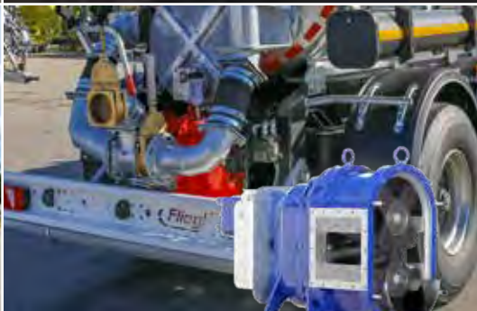
en variante à pompe avec pompe à piston rotatif Vogelsang
