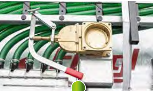
Collecteur à ouverture mécanique ou hydraulique
