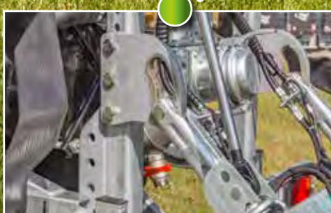
Compensation automatique de dévers pour une adaptation optimale au sol
