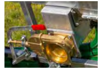
Collecteur de séparation des corps étrangers
