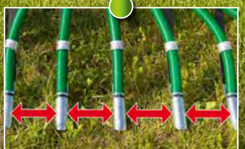
Écart de 250 mm entre les tuyaux
