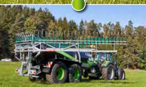
Tuyaux d'écoulement protégés contre les plis par le mécanisme de basculement spécial
