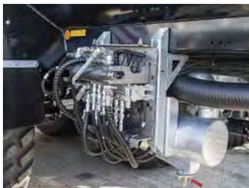
Bloc de commande Load Sensing ou courant constant
