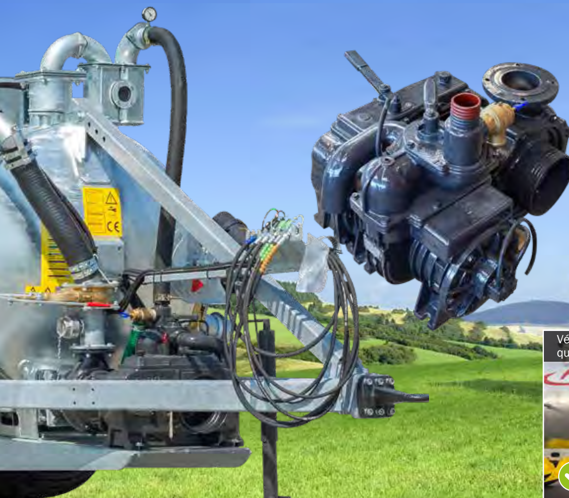
Combinaison entre compresseur et pompe centrifuge
