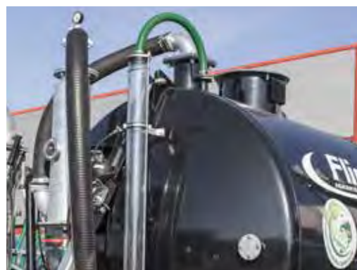
Indicateur du niveau de remplissage en plexiglas
