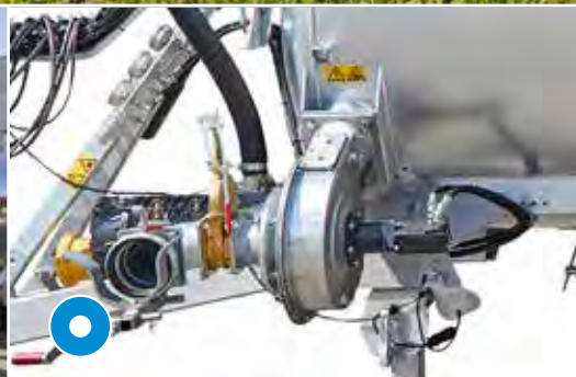
Remplisseur turbo latéral possible à gauche ou à droite
