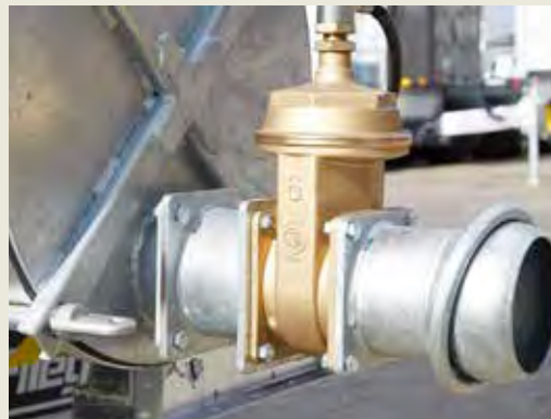
Coulisseau en cloche hydraulique pour citerne sous vide, robuste et insensible aux résidus (idéal pour le lisier de paille)
