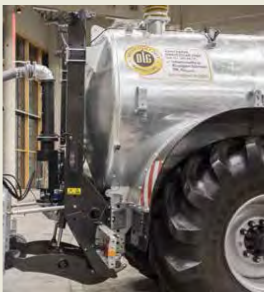
Hydraulique à quatre points avec une capacité de levage de 4500 kg
