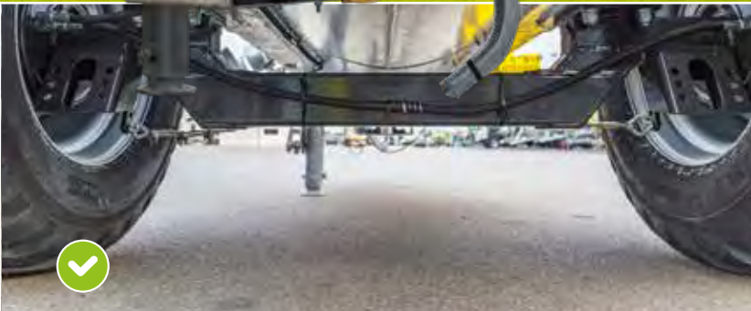
À partir de 5000 litres avec essieu coudé : le centre de gravité bas garantit un comportement de conduite optimal dans les pentes
