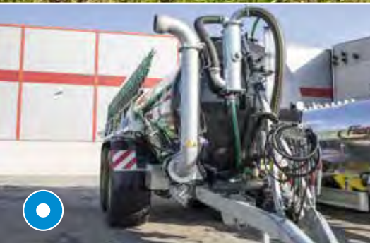
Embout d'aspiration – à gauche ou à droite – pour un usage pratique
