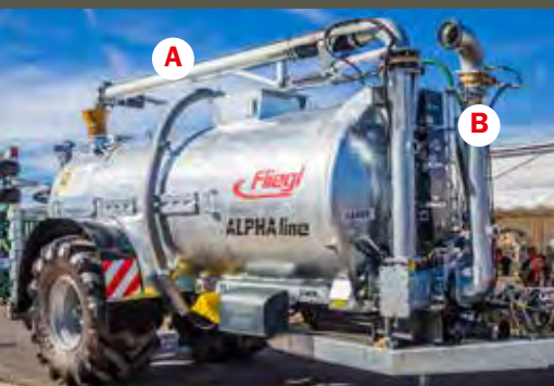
A : bras d'aspiration, longueur 4500 mm, pivotant des deux côtés
