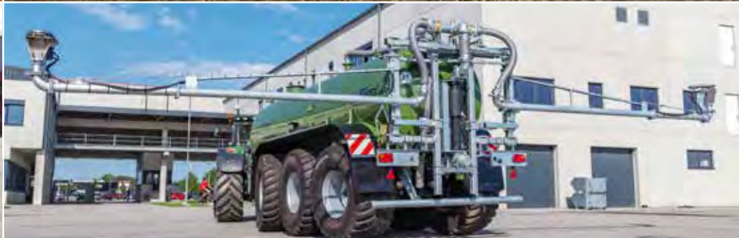
Le distributeur à buses avec une largeur de travail maximale de 21 à 30 m
