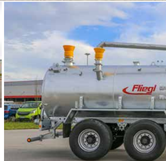
HFW 16 000 Tandem avec pompe centrifuge et bras de transbordement pivotant des deux côtés
