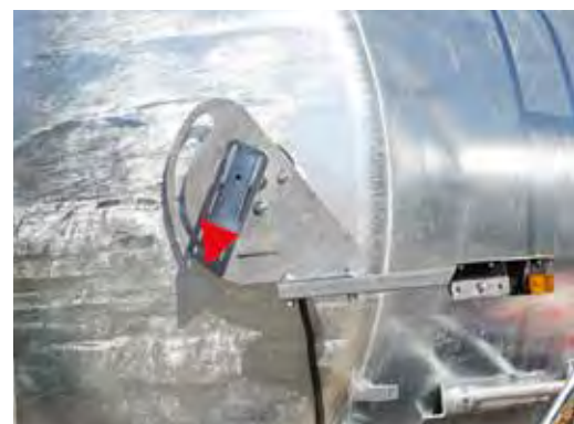
Indicateur du niveau de remplis- sage avec flotteur
