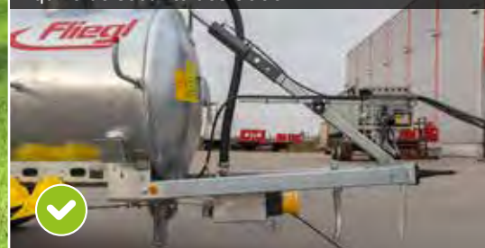
Vérin de basculement de la citerne avec béquille de sécurité dès 5000 L
