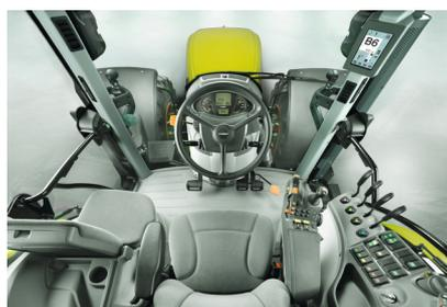
Mit der CIS Ausstattung bietet der ARION schon in Serie eine Ausstattungslinie für höchste Ansprüche. Hier werden mechanische Steuergeräte mit der Multifunktionsarmlehne gepaart. Häufig benötigte Funktionen wie Getriebebesteuerung und Heckkraftheber befinden sich auf der Multifunktionsarmlehne. Die Anzeige erfolgt über das CIS Display im rechten A-Holm. Abbildung ARION 500/600.
