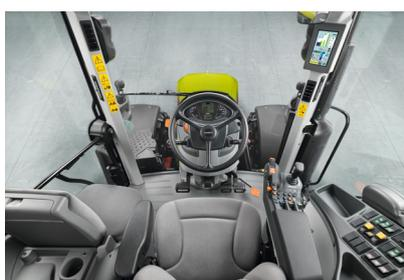
Das in den A-Holm integrierte, 7" grosse CIS+ Farbdisplay kombiniert Anzeige und Einstellmöglichkeiten von Getriebe, elektronischen Steuergeräten, F-Tasten und dem CSM Vorgewendemanagement. Neben der CEBIS Version bietet auch CIS+ die Möglichkeit der Kombination mit dem CMATIC Stufenlosgetriebe. Abbildung ARION 500/600.
