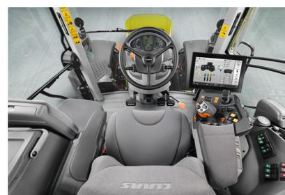
Mit der CEBIS Touchbedienung und CMOTION bietet CLAAS ein einzigartig komfortables und effizientes Bedienkonzept. Durch die CMOTION Bedienung mit Daumen, Zeige- und Mittelfinger ermüdet die Hand beim Arbeiten nicht, weil der Arm auf der gepolsterten Lehne ruht. Sie steuern alle wichtigen Funktionen mit einer Hand. Abbildung ARION 500/600.
