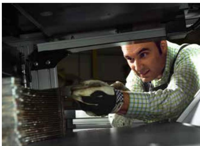
Die Bedienung des AQUA NON STOP COMFORT erfolgt schnell und einfach über ein Bedienterminal. Hier können die Anzahl der Schleifzyklen und der Schleifdruck eingestellt werden. Für die logische Schaltung der Abläufe und die Sicherheit während des Schleifens sorgen zahlreiche Sensoren im Gerät. Darüber hinaus können jederzeit wichtige Informationen über Betriebsstunden, Anzahl geschliffener Messer und Schleifzyklen abgerufen werden.
