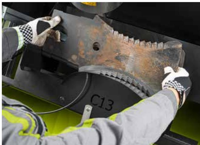
Nachdem die Messer einzeln gemäß ausgewähltem Schleifdruck und Anzahl der Schleifzyklen geschärft wurden, verbringt das Gerät die fertigen Messer automatisch in die hintere Ablage verbracht. Eine Entnahme ist bei Bedarf während des Schleifvorganges gefahrlos möglich, da eine Sicherheitsschaltung dafür Sorge trägt, dass bei geöffneten Seitenklappen keine fertig geschliffenen Messer nachgelegt werden.
