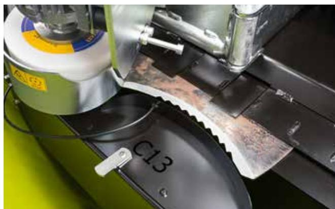
Als weitere Innovation arbeitet das Gerät mit messertypenspezifischen Konturschablonen, die es ermöglichen, die Schneidmesser der verschiedensten Hersteller immer exakt entlang ihrer Original-Schneidkonturen zu schleifen – sogar Messer mit gerader Schneide kann das neue AQUA NON STOP COMFORT exakt schleifen.
