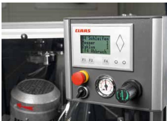
Die besonderen Vorteile des Nassschleifens wurden schon beim Vorgängergerät AQUA NON STOP genutzt und haben sich dort sehr gut bewährt. Das neue Gerät bietet hier eine weitere Verbesserung. So kommt eine Schleifemulsion aus Wasser und Schleifmittel zum Einsatz, die über eine ganze Saison im Gerät verbleiben kann. Die Emulsion wird direkt auf den Schleifpunkt gegeben. Das optimiert den Schleifvorgang und verhindert eine Überhitzung der Messer.
