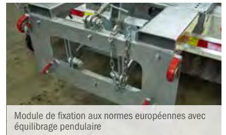
Module de fixation aux normes européennes avec équilibrage pendulaire
