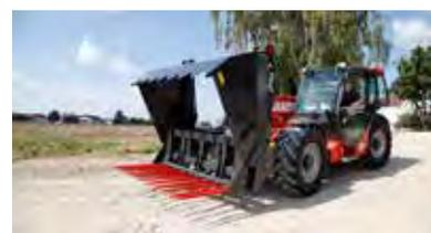
À fixer sur un chargeur sur pneus ou télescopique
