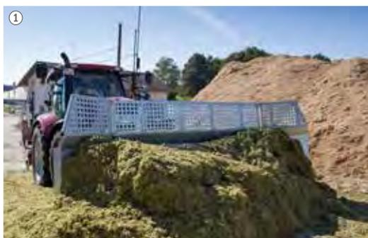
Grillage supplémentaire : surélévation (400 mm) sur toute la largeur de travail de la lame de nivellement. Le dispositif de surélévation est tout simplement vissé sur la lame de nivellement.
