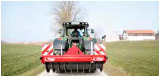
Illustration avec set de panneaux d'avertissement, en option pour les engins excessivement larges
