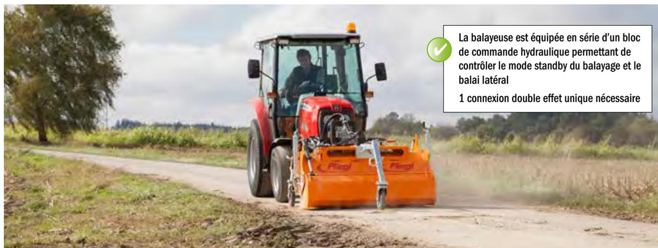
La balayeuse est équipée en série d'un bloc de commande hydraulique permettant de contrôler le mode standby du balayage et le balai latéral
