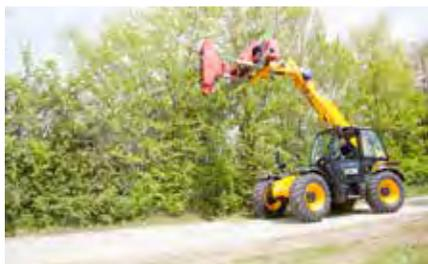
Lamier à scies à 3 lames sur chargeur télescopique avec attelage JCB
