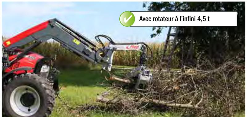
Grappin hydraulique Combi Plus RZ 185 avec rotateur à l'infini
