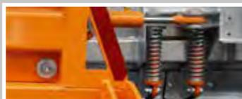
Limiteur de charge par clapets à ressorts
