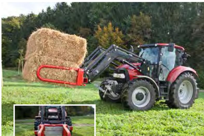
Pour des balles rectangulaires de 715 à 2450 mm, largeur de transport : 1350 mm
