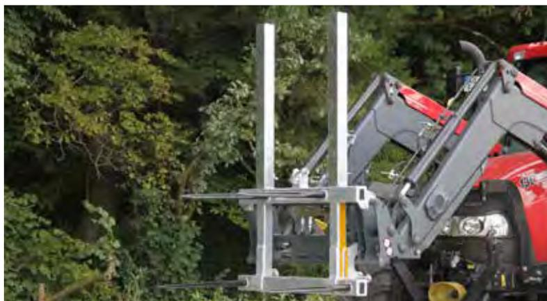
Illustration : tubes à emboîter pour pique botte à fond poussant Combi avec dispositif de surélévation
