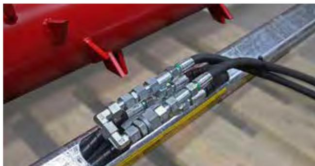
Guidage des tuyaux à l'intérieur, tubes de maintien robustes, donc protection optimale des tuyaux
