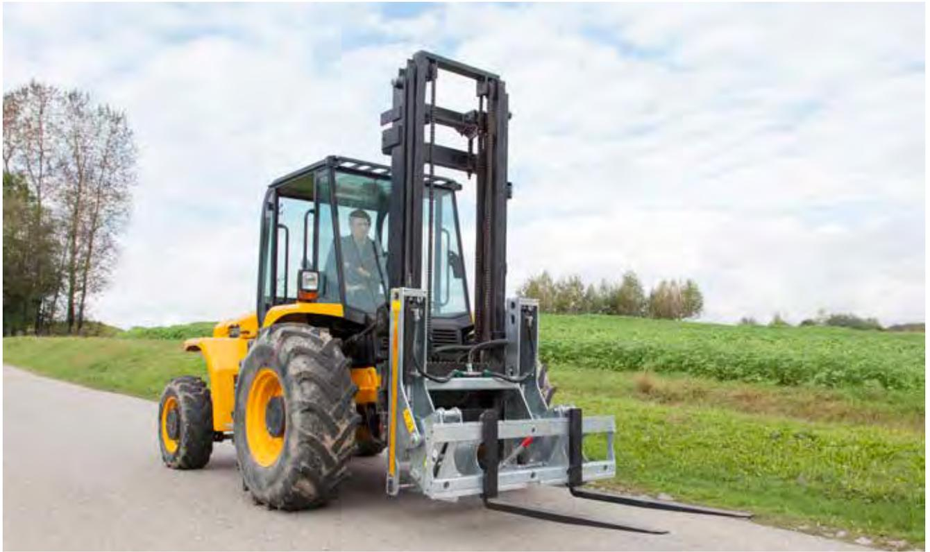
Adaptateur de basculement Combi Universal sur le chariot élévateur avec fourche à palette Freisicht
