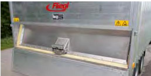
Les joints d'étanchéité en polyuréthane assurent une vidange propre et sans résidus de la cuve
