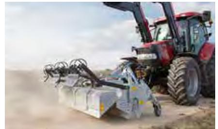
KEH Type 500 sur le relevage avant avec mode standby du balayage et dispositif de raclage
