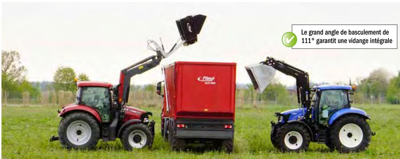
Représentation des différentes hauteurs de basculement avec le même chargeur frontal
