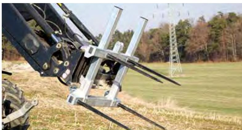
Illustration : pique botte à fond poussant avec quatre broches pour balles rondes et dispositif de surélévation (2 broches - supplément)
