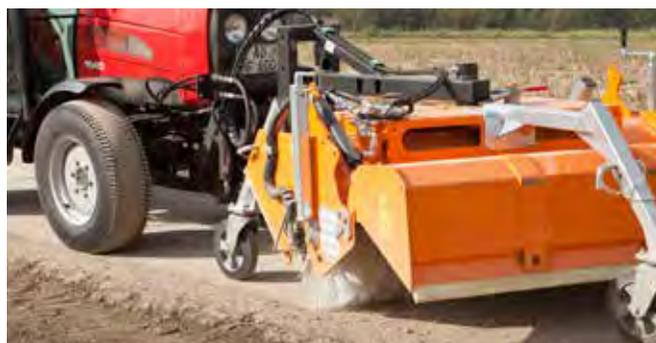
Mode standby du balayage en série : balayage avec cuve de collecte des déchets ouverte
