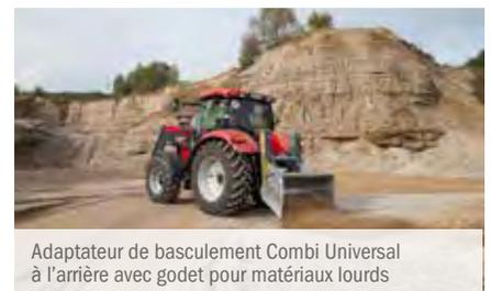
Adaptateur de basculement Combi Universal à l'arrière avec godet pour matériaux lourds
