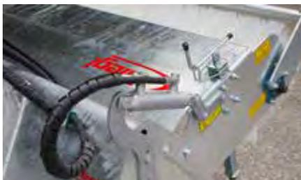
Dispositif de levage hydraulique
