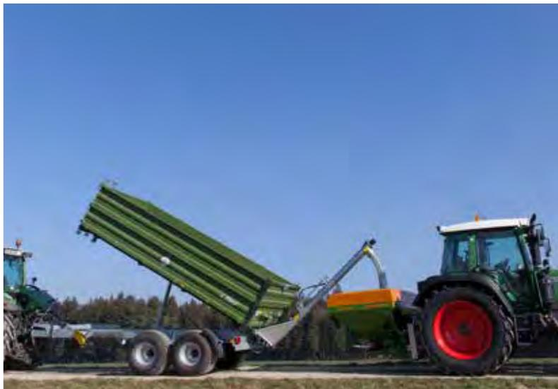
La vis de transbordement peut être fixée très facilement à toute sorte de remorque basculante. Le maniement s'effectue facilement. Réglage en continu de l'angle de déversement par un treuil à câble. Connexion hydraulique double effet requise !
