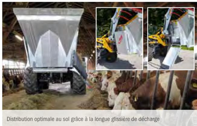
Distribution optimale au sol grâce à la longue glissière de décharge
