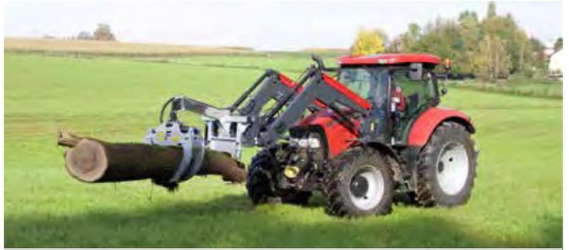
Grappin hydraulique Combi RZ 185 avec articulation pivot mécanique
