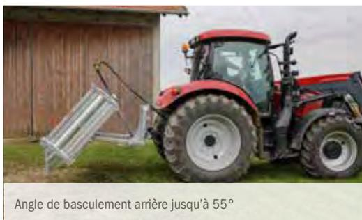
Angle de basculement arrière jusqu'à 55°
