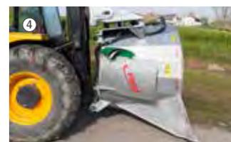
Adaptateur de basculement pour l'attelage sur chariot élévateur FEM 2 et FEM 3
