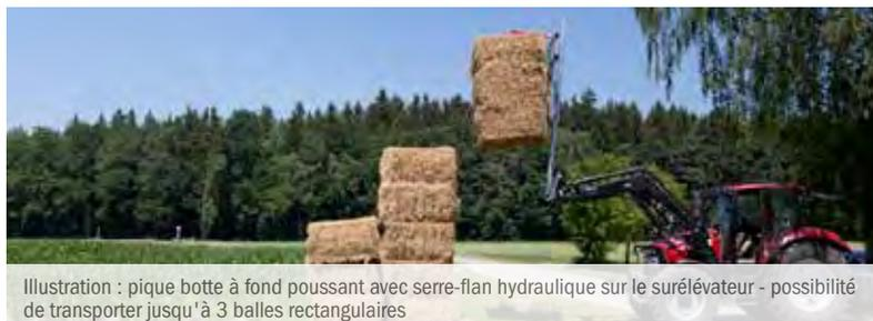
Illustration : pique botte à fond poussant avec serre-flan hydraulique sur le surélévateur - possibilité de transporter jusqu'à 3 balles rectangulaires
