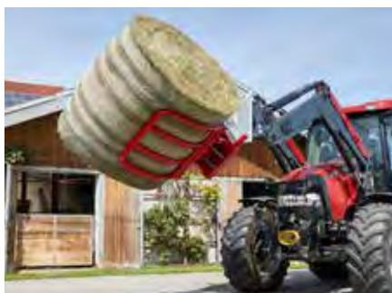
Adaptateur pivotant Mono : illustration avec pince à balle, non comprise dans la livraison
