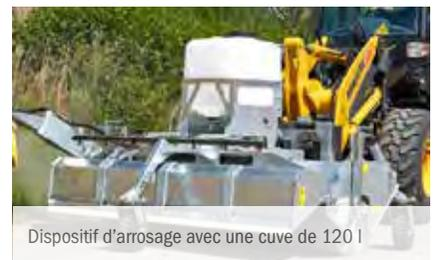
Dispositif d'arrosage avec une cuve de 120 l
