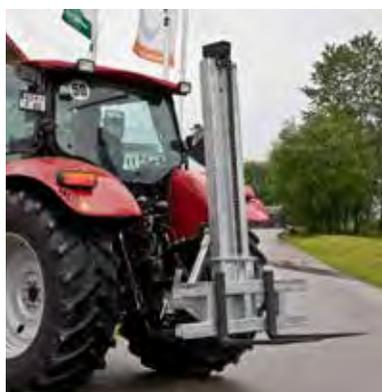
Illustration : dispositif d'élévation pour chariot élévateur avec fourches de 900 mm
