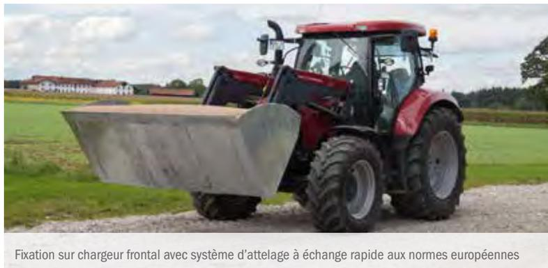
Fixation sur chargeur frontal avec système d'attelage à échange rapide aux normes européennes
