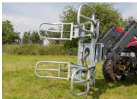
Adaptateur pivotant Duo, pour faire pivoter 2 engins en même temps. Illustration avec pince à balle Small
