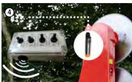
Contrôle de la vitesse de rotation : un signal avertit le conducteur en cas de blocage d'une lame de scie, ce qui protège la courroie
