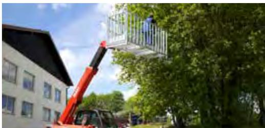
Plateforme de travail en variante large pour chargeur sur pneus ou télescopique
