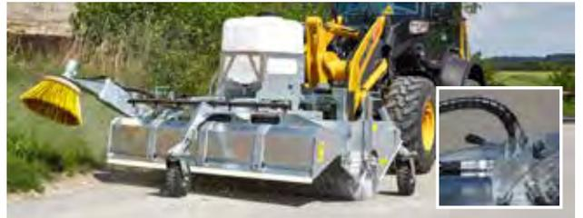
Mode standby contrôlable par un bloc de commande hydraulique en série. Dispositif d'arrosage avec une cuve de 120 l
