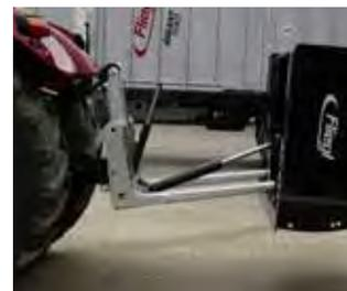
Système à 2 cylindres pour un angle de basculement optimal
