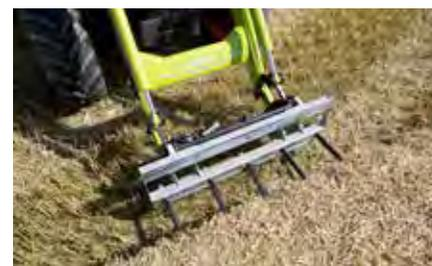
Montage et démontage très faciles en cas d'utilisation avec des broches pour balles rondes grâce aux douilles coniques existantes (à visser). Nombre plus ou moins important de broches en fonction des exigences de l'application.
