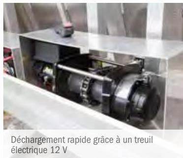
Déchargement rapide grâce à un treuil électrique 12 V
