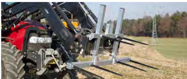
Illustration : pique botte à fond poussant avec dispositif de surélévation et six broches pour balles rondes (2 broches - supplément)
