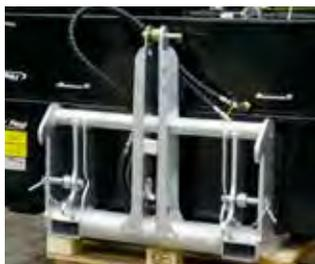
À fixer sur un attelage trois points, aux normes européennes et les éclisses de chariot élévateur, de série
