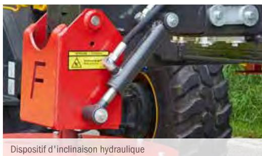
Dispositif d'inclinaison hydraulique
