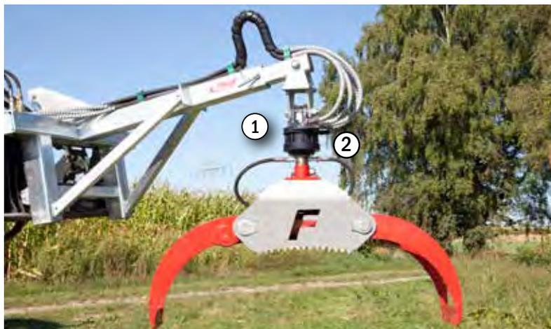
Notre gamme inclut également des coupleurs-inverseurs électromagnétiques supplémentaires adaptés à un 3ème ou 4ème circuit de circulation d'huile. Aucune vanne de commande supplémentaire n'est donc nécessaire pour la pince de transbordement ou le moteur couple.
