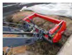
Les 2 grands cylindres hydrauliques permettent une coupe avec une faible pression hydraulique
