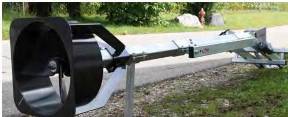
Malaxeur - pour le mélange dans les canaux, pour pale mélangeuse Ø 500 et Ø 600 mm
