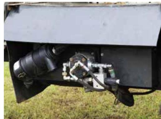
Kolbenkompressor mit bis 3 m³ Luftleistung
