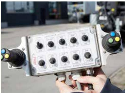
Bedienpult mit Joystick-Steuerung für Saugrüssel oder Güllekran
