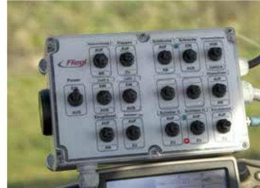
Bedienpult zur Fasssteuerung (Steuerblock)
