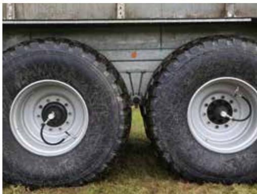
Reifendruckregelanlage für bodenschonenden Feldeinsatz mit Ein- und Zweileiteranlage
