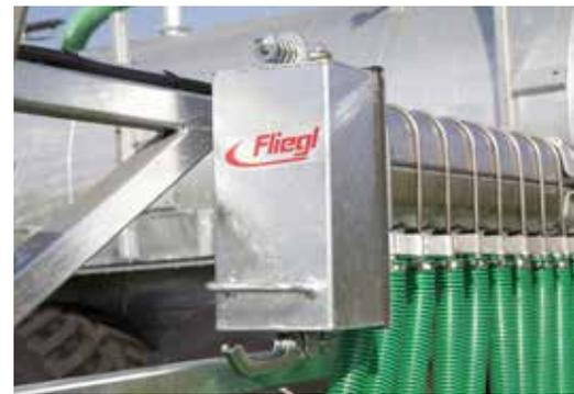
Staukasten für Fremdkörper – mechanische oder hydraulische Entleerung
