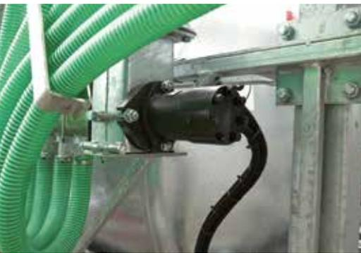
Ölmotor für Schneckenverteiler mit wenig Verschleiss und langer Lebensdauer.
