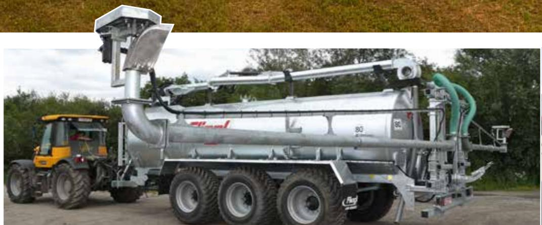
Der Düsenbalkenverteiler mit einer maximalen Arbeitsbreite von 21 – 30 m
