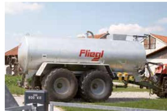
Schleuderfass »Light« 18.000 Liter mit Bereifung 700/30,5; Eigengewicht 5700 kg
