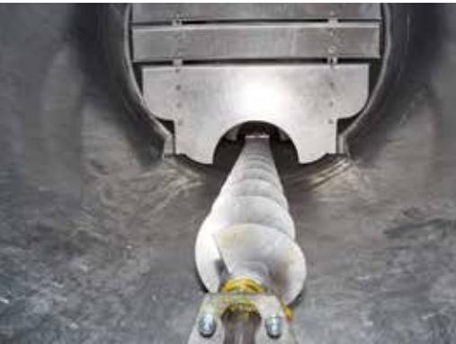
Hydraulisches Innenrührwerk über Rührschnecke, dadurch beste Homogenisierung der Gülle (bei Schweinegülle empfehlenswert)
