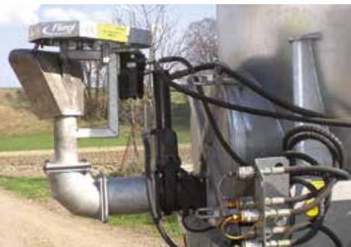
Gezielt und besser verteilen mit dem hydraulischen Pendelverteiler. Arbeitsbreite von 12 bis 18 m.
