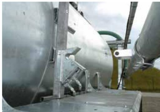
Transportsicherung für Straßenverkehr mit hydraulischer Ver- und Entriegelung.
