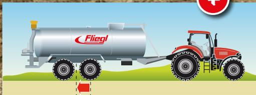
Bei den Tandem- und Tridem-Fässern ist das Achsaggregat mechanisch (optional hydraulisch) verschiebbar, so kann auch bei schweren Anbaugeräten zur Gülleearbeit eine ausreichende Stützlast gewährleistet werden.
