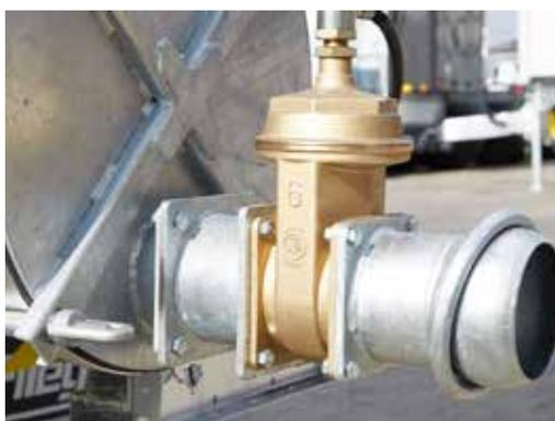
Glockenschieber hydraulisch, robust und unempfindlich
