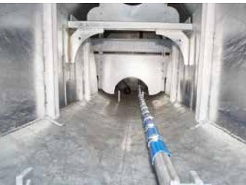
Innenrührwerk Luft, nur in Verbindung mit Kompressor möglich. Homogenisiert die Gülle
