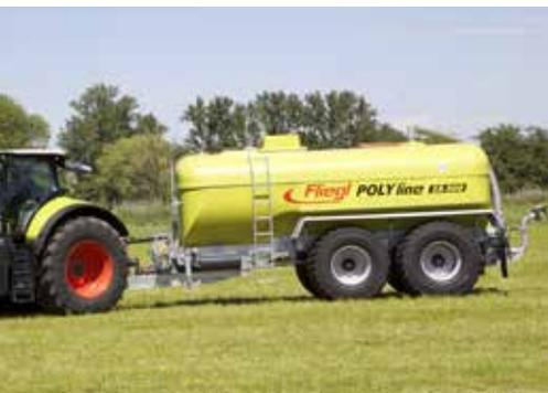
Hohe Fahrsicherheit bei allen PolyLine-Fässern: Durch die besondere Rahmenkonstruktion wird in Verbindung mit dem Boogi-Aggregat ein sehr niedriger Schwerpunkt erreicht
