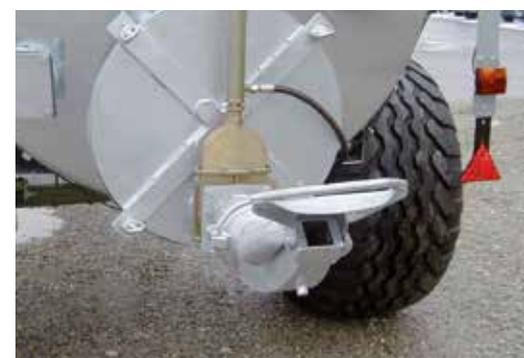
Kombiverteiler – klappbar
