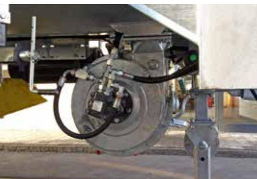
**Turbobefüller mit Schnellkupppler (6" oder 8")**
