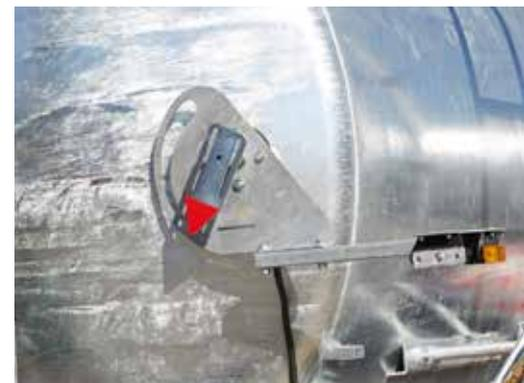
Füllstandszeiger mit Schwimmerkugel (Serienauführung)
