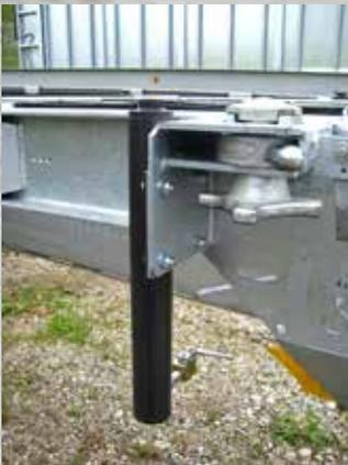
Zylinder für hydraulische Hebeeinrichtung
