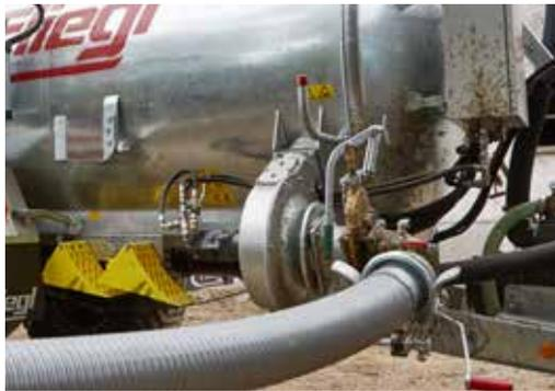
**Turbobefüller mit Schnellkupppler (6" oder 8")**
