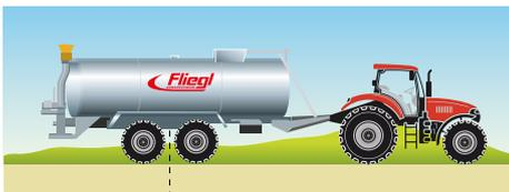
Optimale Anpassung der Stützlast durch mechanische Achsverschiebung (Serienausstattung) oder stufenlos hydraulisch (optional)
