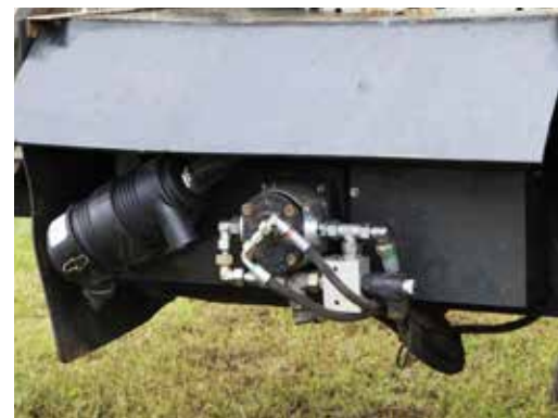
Compresseur à piston avec jusqu'à 3 m 3 de débit d'air
