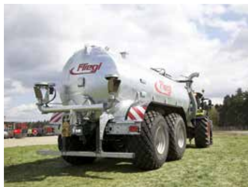
PFW 18 000 L avec distributeur pendulaire double hydraulique
