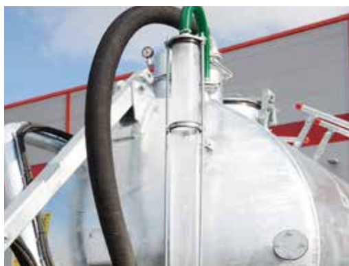
Indicateur du niveau de remplissage en plexiglas
