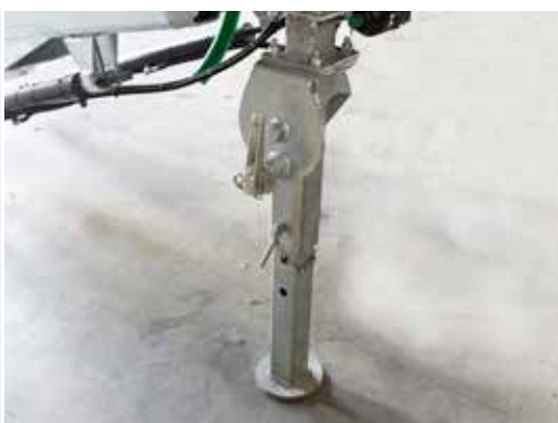
Béquille de sécurité robuste De série en combinaison avec la suspension de timon
