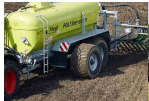
PolyLine disponible en différentes variantes d'équipement, par ex. avec essieu télescopique
