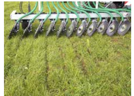
Disques à encoches pour une meilleure qualité d'insertion
