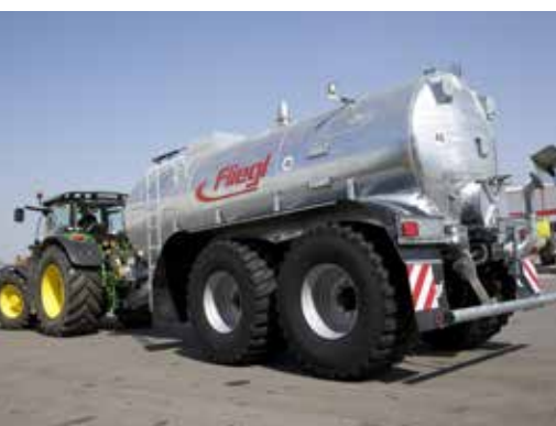
Passage de roue de série pour pneumatiques 30,5"
