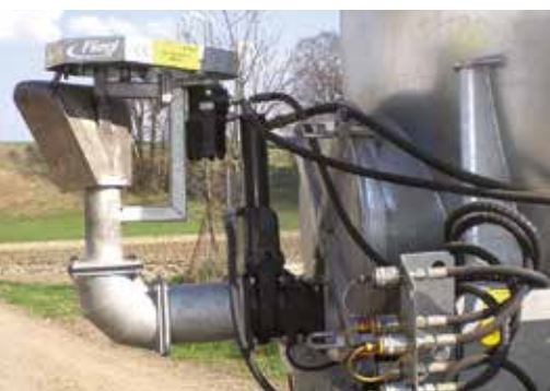
Meilleure répartition ciblée grâce au répartisseur pendulaire hydraulique. Largeur de travail de 12 à 18 m
