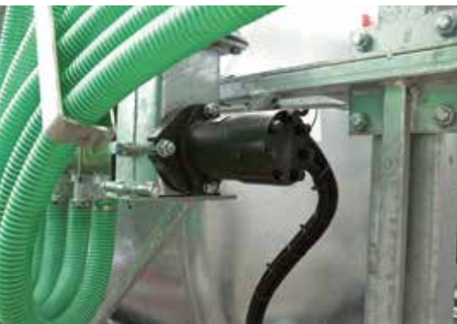
Moteur hydraulique pour distributeur à vis présentant peu d'usure et une longue durée de vie
