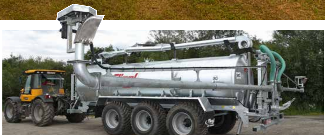
Le distributeur à buses avec une largeur de travail maximale de 21 à 30 m
