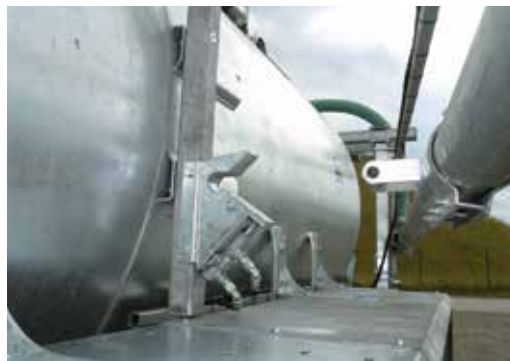
Sécurité de transport pour le transport sur route avec verrouillage et déverrouillage hydrauliques
