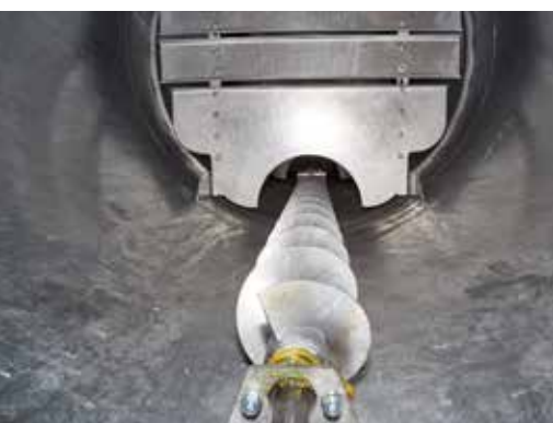
Mélangeur interne hydraulique via vis de mélange, offrant une excellente homogénéisation du lisier (conseillé pour le lisier de porc)
