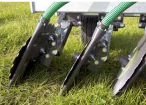
Réglage en continu dans la verticale
