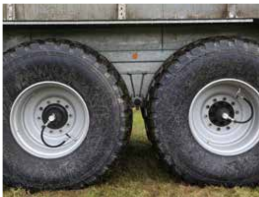
Régulateur de la pression des pneumatiques pour une utilisation ménageant le sol avec installation à une échelle ou deux échelles
