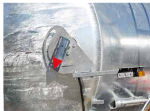
Indicateur du niveau de remplissage avec flotteur (version de série)
