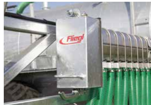
Collecteur pour corps étrangers – vidange mécanique ou hydraulique
