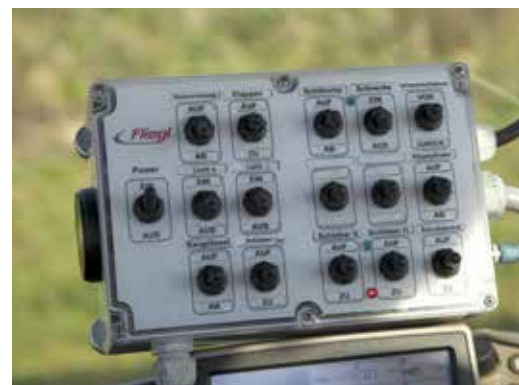
Pupitre de commande pour la commande de la citerne (bloc de commande)
