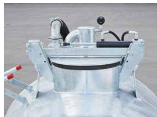
Dôme de remplissage hydraulique Tailles disponibles : Ø 500 et Ø 600 mm
