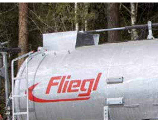
couvercle de poussée hydraulique, ouverture 700 x 700 mm
