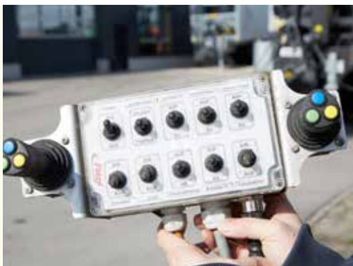
Pupitre de commande avec commande à joystick pour embout d'aspiration ou grue de lisier
