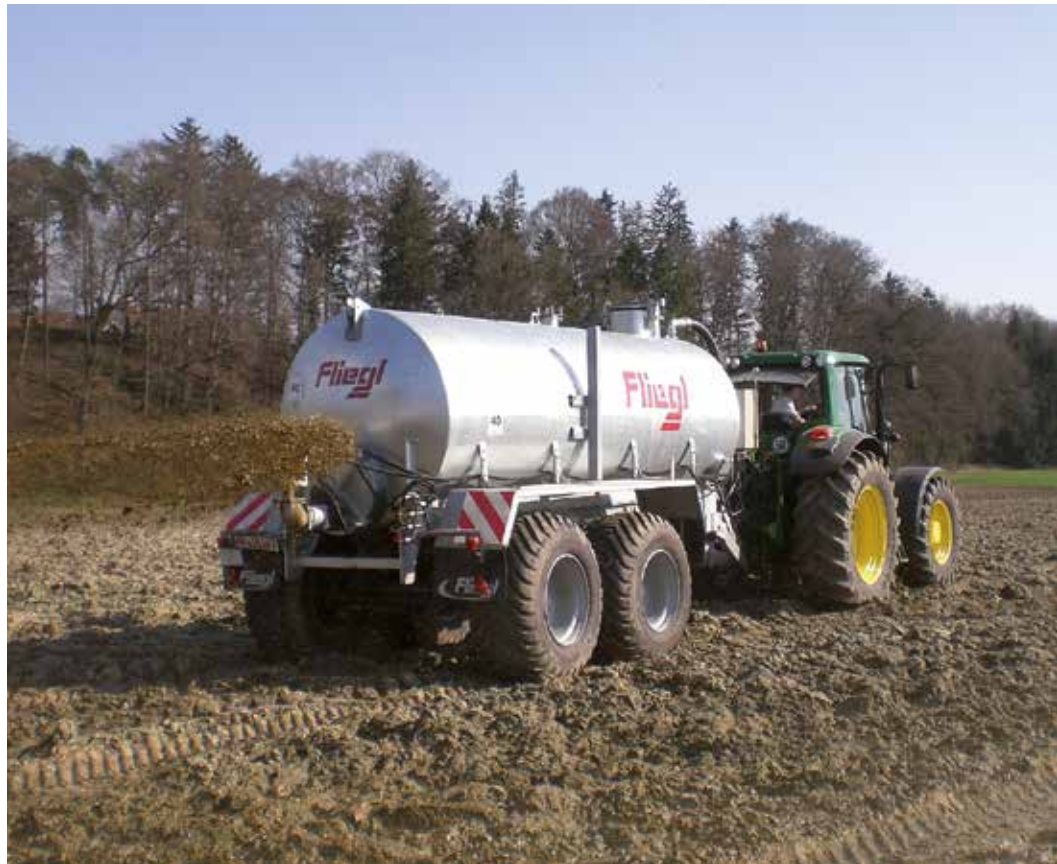
Répartisseur pendulaire pour un apport à grosses gouttes
