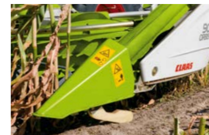
AUTO CONTOUR : régulation de la pression d'appui avec compensation transversale
