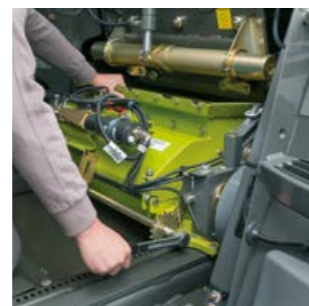
Montage et démontage rapides de l'éclateur
