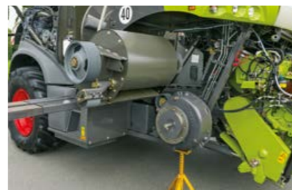
Rapidité et simplicité pour le montage ou le démontage de l'accélérateur
