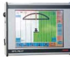
Der GPS PILOT S3 für automatisches Lenken bietet einen 8,4 Zoll großen Touchscreen-Farbbildschirm für perfektes Know-how auf dem Feld, viel Bedienkomfort und einer Lenkgenauigkeit von +/- 2 bis 3 cm beim Einsatz mit RTK-Korrektursignalen.
