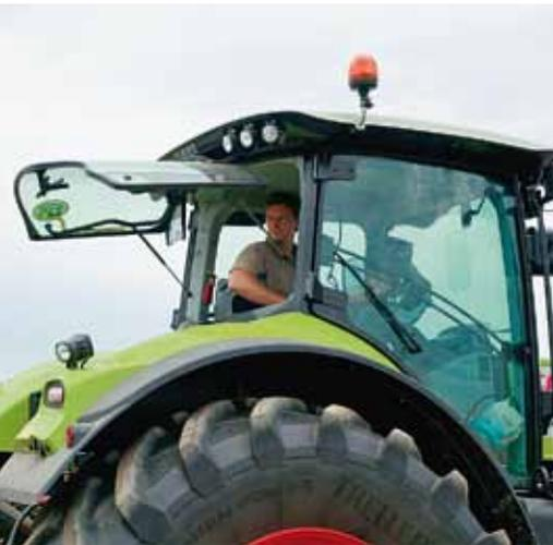
Die B-Holme sind für eine gute Sicht auch bei großen Arbeitsbreiten weit nach vorne gezogen und die (weit öffnende!) Heckscheibe entsprechend gebogen. Zwei Lichtmaschinen und bis zu 20 Zusatzscheinwerfer machen die Nacht zum Tag.
