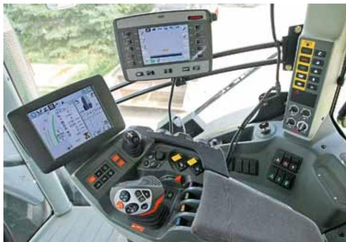
**Kontrollzentrum:** Die Bedienarmlehne wurde neu entwickelt, nur der Multifunktionsgriff und das Terminal sind vom großen Xerion bekannt. Weniger wichtige Knöpfe sitzen am B-Holm, und für die GPS-Lenkung sowie die ISO-Bus-Gerätesteuerung gibt es einen zweites Terminal.
