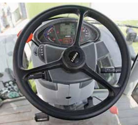
Der neue Armaturenräger ragt nicht mehr so weit in den Fußbereich, das Lenkrad wirkt aber immer noch etwas klobig. In den Wendeschalthebel ist die Parkbremse integriert (die leider die Anhängerbremse nicht ansteuert).
