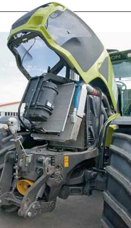
Gasdruckdämpfer unterstützen die Kühlerklappung, sonst ist von dem FPT-Motor mit 8,7 l Hubraum nicht viel zu sehen. Das integrierte Fronthubwerk hebt auf Wunsch bis zu 6,8 t.
