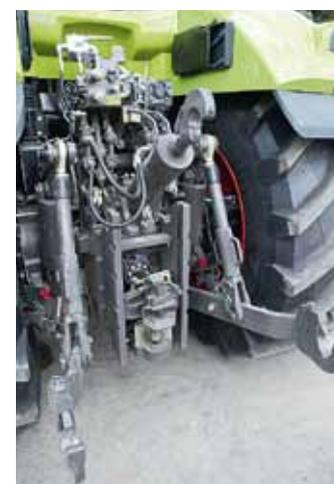
Das Gestänge gibt es als Kat. III oder IV N. Hinten sind bis zu sechs Ventile möglich, vorne zwei. Die Axialkolbenpumpe gibt es mit 150 oder 220 l/min.
