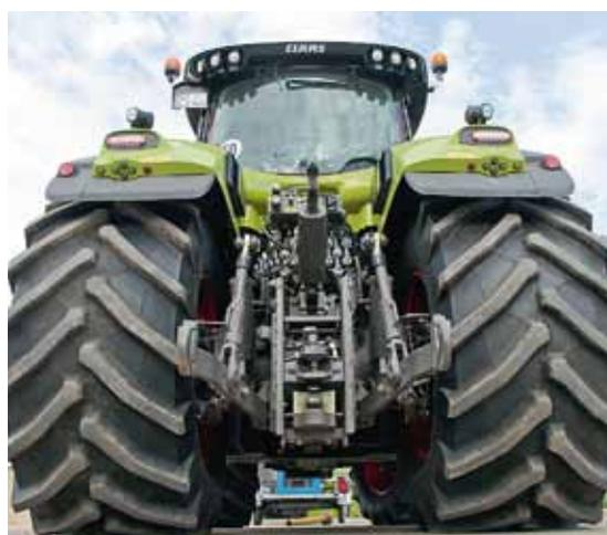
Um mehr als 400 PS auf den Boden zu bringen, braucht man Aufstandfläche. Mit den 2,15 m hohen 900er Rädern und 12,5 t Leergewicht kann der Axion 950 hier schon einiges bewegen. Das Hubwerk stemmt mehr als 11 t und hat ein Gestänge samt Schnellkupplern von Walterscheid.
