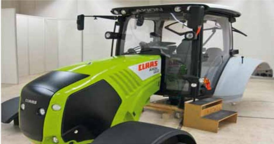
Um mit Praktikern z. B. einen neuen Kabinen-Entwurf zu testen, werden so genannte „mock ups“ gebaut. Aufwändig, aber sehr realitätsnah.
