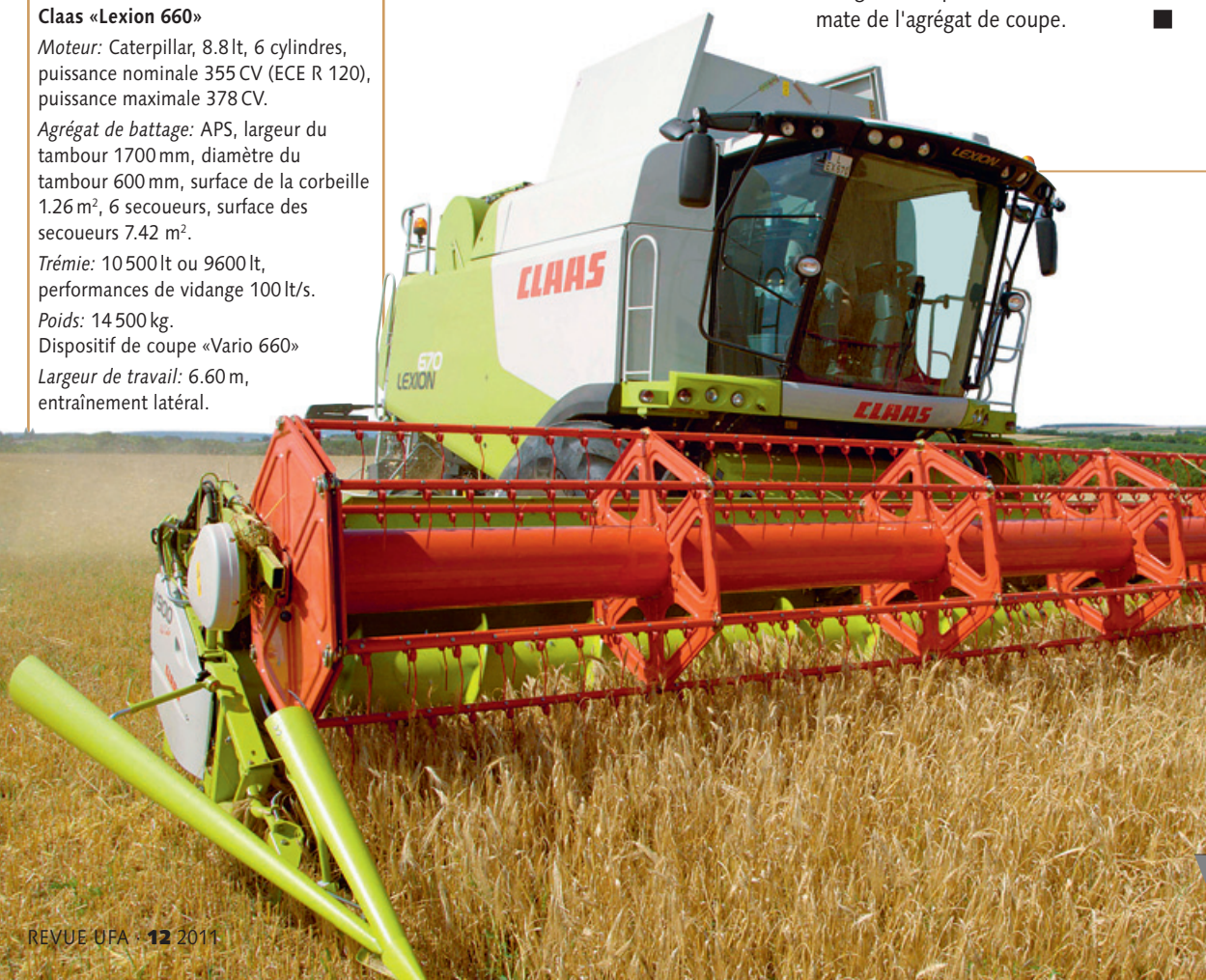
La «Lexion 660» est entraînée par un moteur 6 cylindres de 8.8 l de marque Caterpillar.
