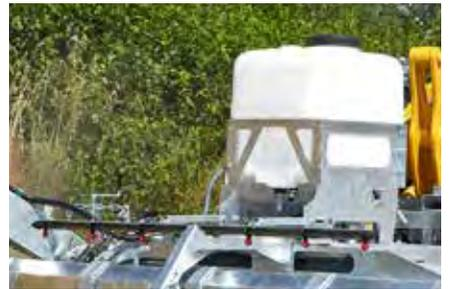
Mit Sprüheinrichtung (120 l Tank)
