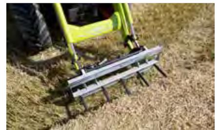
Einfachste Umrüstung bei Verwendung von Rundballenzinken durch vorhandene Konusbuchsen (verschraubbar). Je nach Anwendungsbedarf mit mehr oder weniger Zinken.
