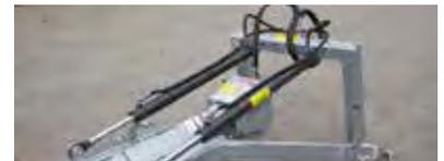
Abb. hydraulisch klappbar, einfaches und schnelleres Einführen in die Grube
