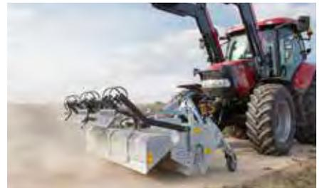
KEH Typ 500 an der Fronthydraulik mit Freikehrmodus und Kratzvorrichtung
