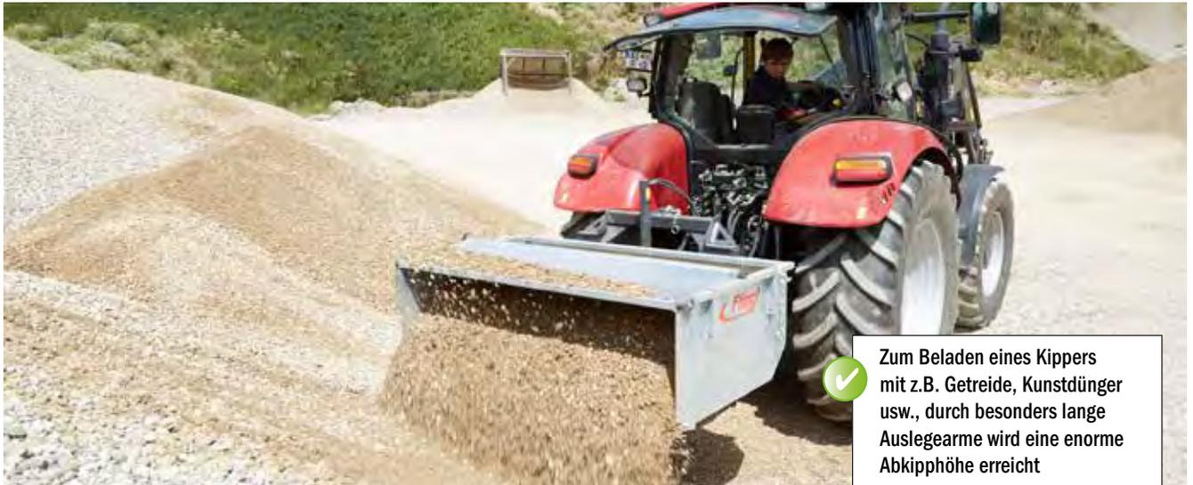
✓ Zum Beladen eines Kippers mit z.B. Getreide, Kunstdünger usw., durch besonders lange Auslegearme wird eine enorme Abkipphöhe erreicht
