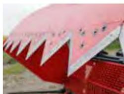
Wechselbare Schneidmesser aus hochfestem Verschleißstahl (HB 450)
