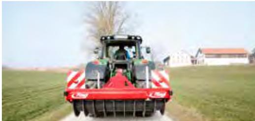
Abb. mit Warntafel-Set, optional für Geräte mit Überbreite
