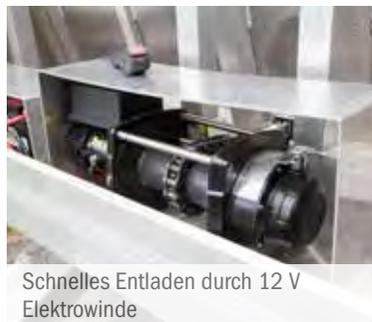
Schnelles Entladen durch 12 V Elektrowinde
