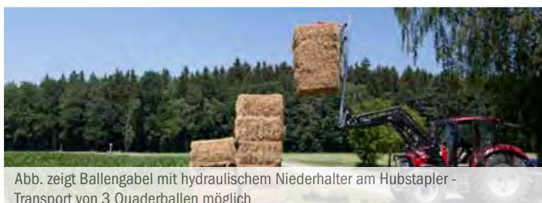
Abb. zeigt Ballengabel mit hydraulischem Niederhalter am Hubstapler - Transport von 3 Quaderballen möglich
