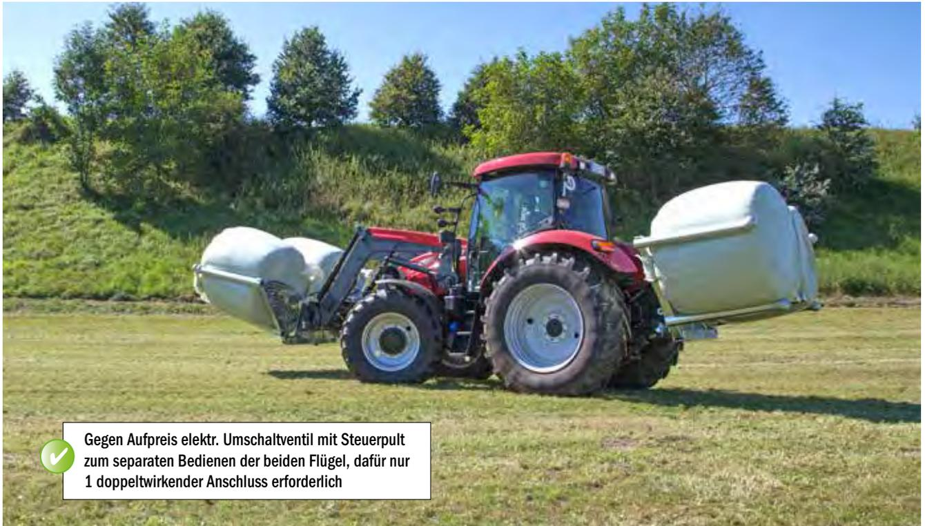
**✓** Gegen Aufpreis elektr. Umschaltventil mit Steuerpult zum separaten Bedienen der beiden Flügel, dafür nur 1 doppelwirkender Anschluss erforderlich
