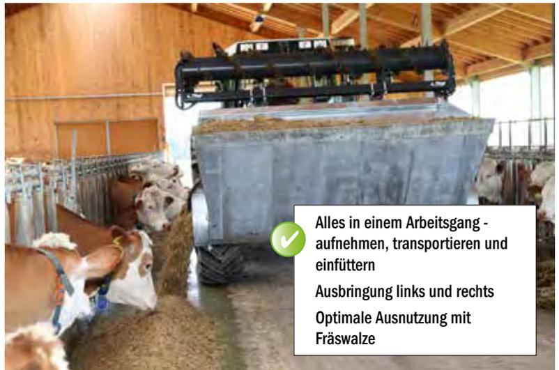
✓ Alles in einem Arbeitsgang - aufnehmen, transportieren und einfüttern
