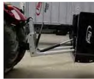
2-Zylinder-System für besten Kippwinkel
