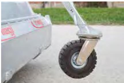
Optional: Schwerlastrad mit superelastischen Vollgummireifen (Ø 300 mm), Breite: 105 mm, kugelgelagert, abriebfeste Lauffläche, stahlgeschweißte Schwerlastrolle, schwere Drehkranzausführung, Spindel verstellbar
