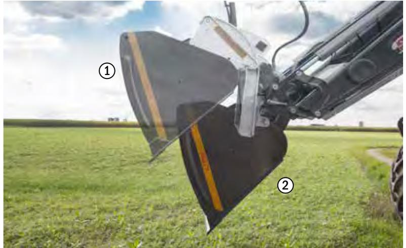
① Mit Hochkippeinrichtung - deutlich zu sehen: Bis zu 1000 mm Höhengewinn möglich (abhängig von der Frontladerschaufel). ② ohne Hochkippeinrichtung (gleicher Frontlader, gleicher Kippwinkel abgebildet)
