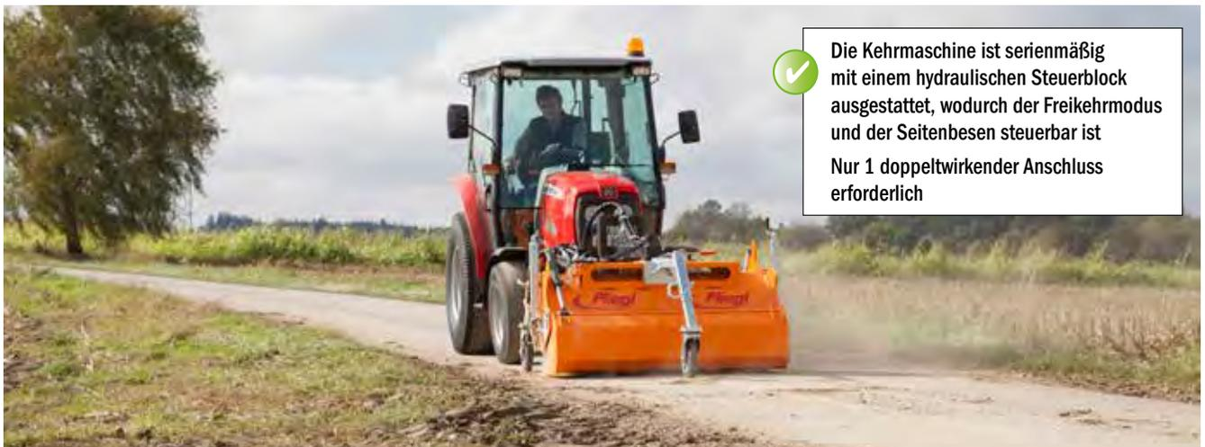
Die Kehmaschine ist serienmäßig mit einem hydraulischen Steuerblock ausgestattet, wodurch der Freikehrmodus und der Seitenbesen steuerbar ist. Nur 1 doppelwirkender Anschluss erforderlich.
