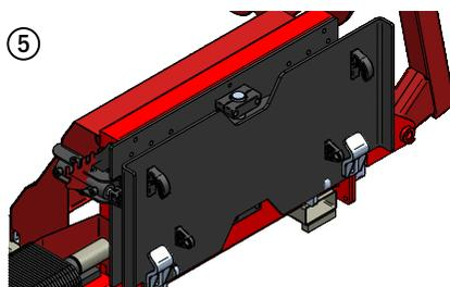
Überlastsicherung: Regelt den optimalen Anpressdruck und neigt sich bei einem Blockieren der Sägeblätter zum Schutz nach hinten.
