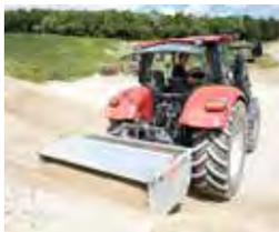
Abb. Pendelwand nach oben geklappt
