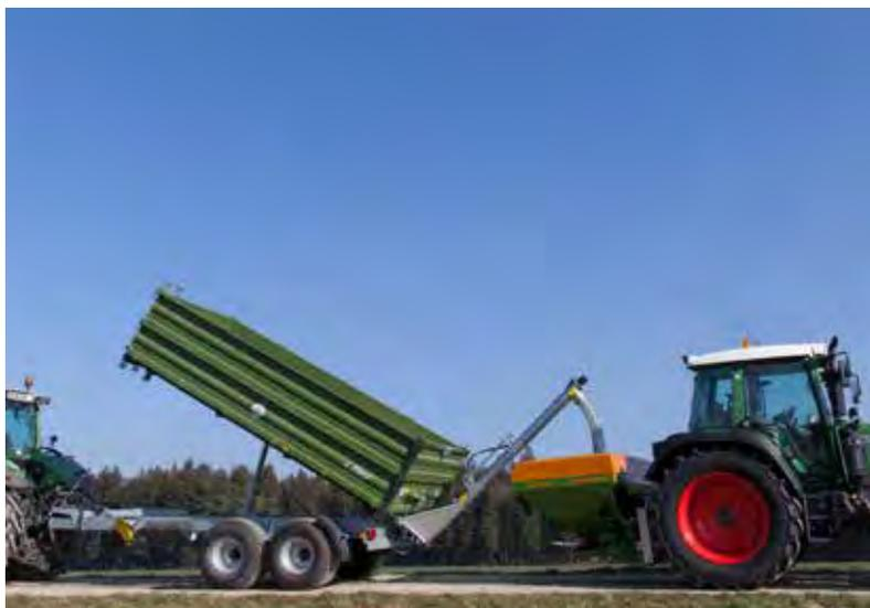
Die Überladeschnecke kann an jeden Kipper mit einfachster Montage angebracht werden. Die Bedienung ist mühelos. Stufenlose Verstellung des Austragewinkels mittels Seilwinde. Doppeltwirkender Hydraulikanschluss erforderlich!
