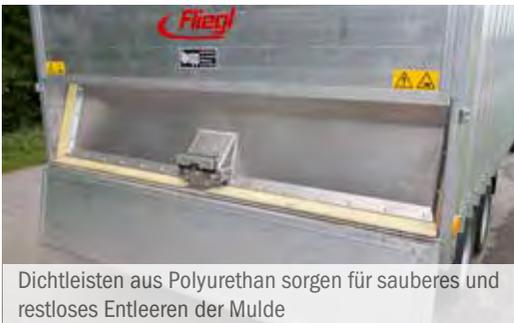
Dichtleisten aus Polyurethan sorgen für sauberes und restloses Entleeren der Mulde
