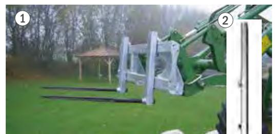
Verstellbare Aufnahme für Rundballenzinken (Schwerlastzinken; M28 x 1,5).
