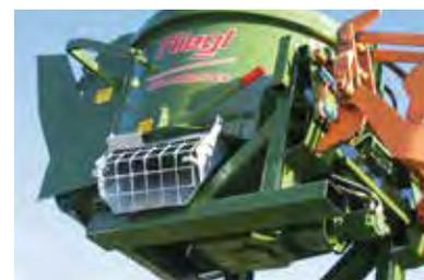
Abb. Auslaufrutsche schwenkbar
