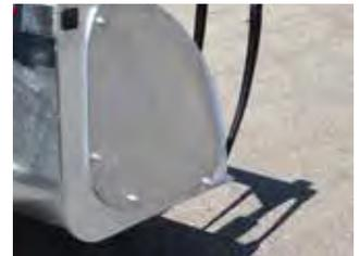
Seitenverstärkte Schaufelkrümmung erhöht die Stabilität
