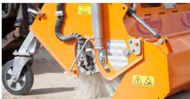
Stufenlose Kehrbesenverstellung durch Stützspindel
