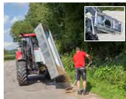
Drehadapter Mono mit Schwergutschaufel zum präzisen Ausleeren von Schüttgut
