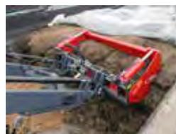
Dank 2 großen Hydraulikzylindern ist das Schneiden mit wenig Hydraulikdruck möglich
