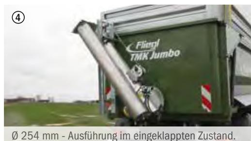
Ø 254 mm - Ausführung im eingeklappten Zustand.
