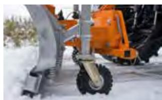
Schwerlastrad mit Superelastik-Vollgummireifen (Ø: 306 mm), Breite: 105 mm
