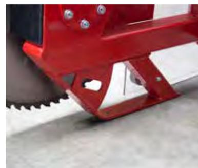
Ein Schutzbügel verhindert eine Berührung des untersten Sägeblattes mit dem Erdreich.
