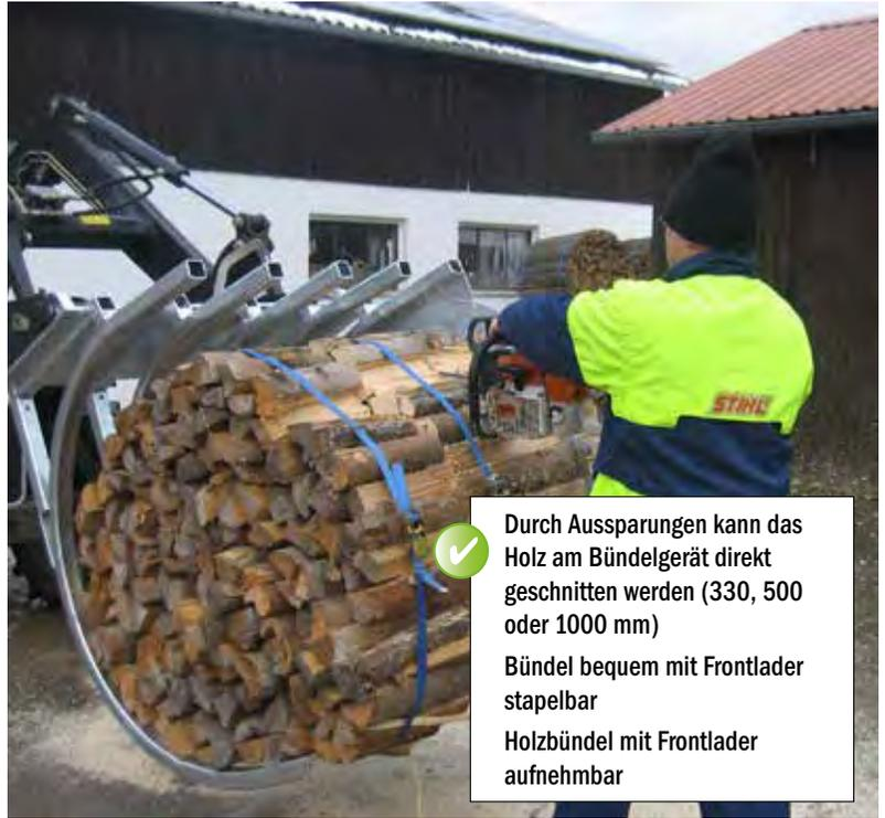
✓ Durch Aussparungen kann das Holz am Bündelgerät direkt geschnitten werden (330, 500 oder 1000 mm)
