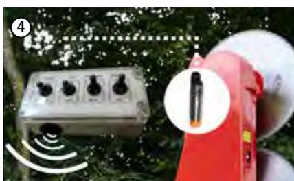
Drehzahlüberwachung: Ein Signal informiert den Fahrer beim Klemmen eines Sägeblattes und schont dadurch die Riemen
