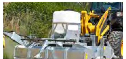
Sprüheinrichtung mit einem 120 l Tank
