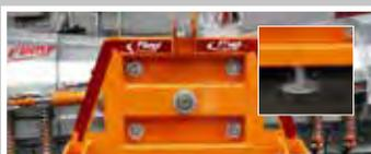
Innovativer Dreipunktbock mit Niveaugleich und Abstellstütze - gleicht Bodenebenen aus
