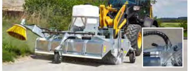
Steuerbarer Freikehrmodus durch serienmäßigen hydraulischen Steuerblock. Sprüheinrichtung mit einem 120 l Tank
