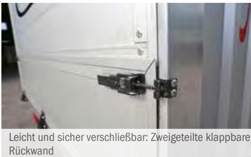
Leicht und sicher verschließbar: Zweigeteilte klappbare Rückwand
