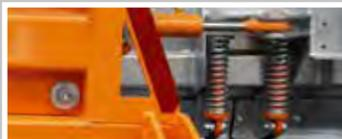
Überlastsicherung durch Federklappen gewährleisten beschädigungsfreies Fahren
