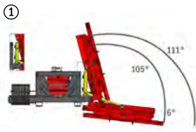
Neigevorrichtung 111° - zum Senkrecht- und Waagrechtsschneiden. Passen Sie den Winkel stufenlos den Gegebenheiten an.
