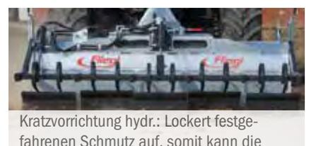
Kratzvorrichtung hydr.: Lockert festgefahrenen Schmutz auf, somit kann die Straße in einem Arbeitsgang gereinigt werden.
