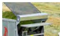
Schutzvorrichtung gegen Verschmutzung und Beschädigung
