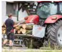
Ausklappbare Pendelwand dient als Muldenverlängerung
