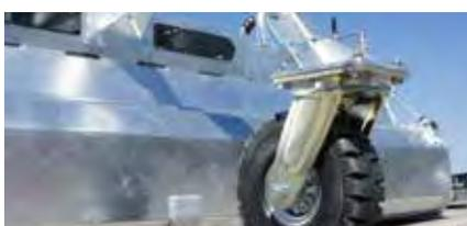
Schwerlastrad mit superelastische Vollgummireifen (Ø 300 mm)
