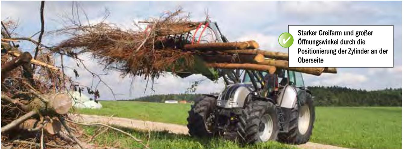
✓ **Starker Greifarm und großer Öffnungswinkel durch die Positionierung der Zylinder an der Oberseite**
