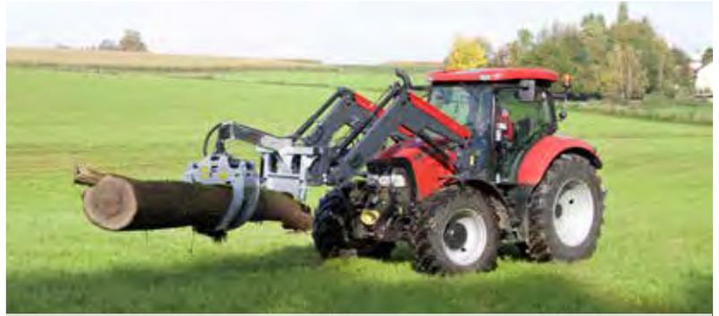
Hydraulische Rückezange Combi RZ 185 mit mechanischem Drehgelenk
