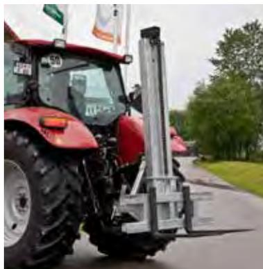
Abb. Staplerhubgerüst mit 900 mm Gabeln
