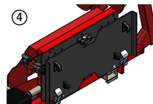
Überlastsicherung: Regelt den optimalen Anpressdruck und neigt sich bei einem Blockieren der Sägeblätter zum Schutz nach hinten.
