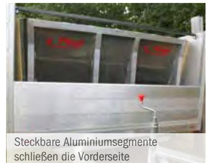
Steckbare Aluminiumsegmente schließen die Vorderseite
