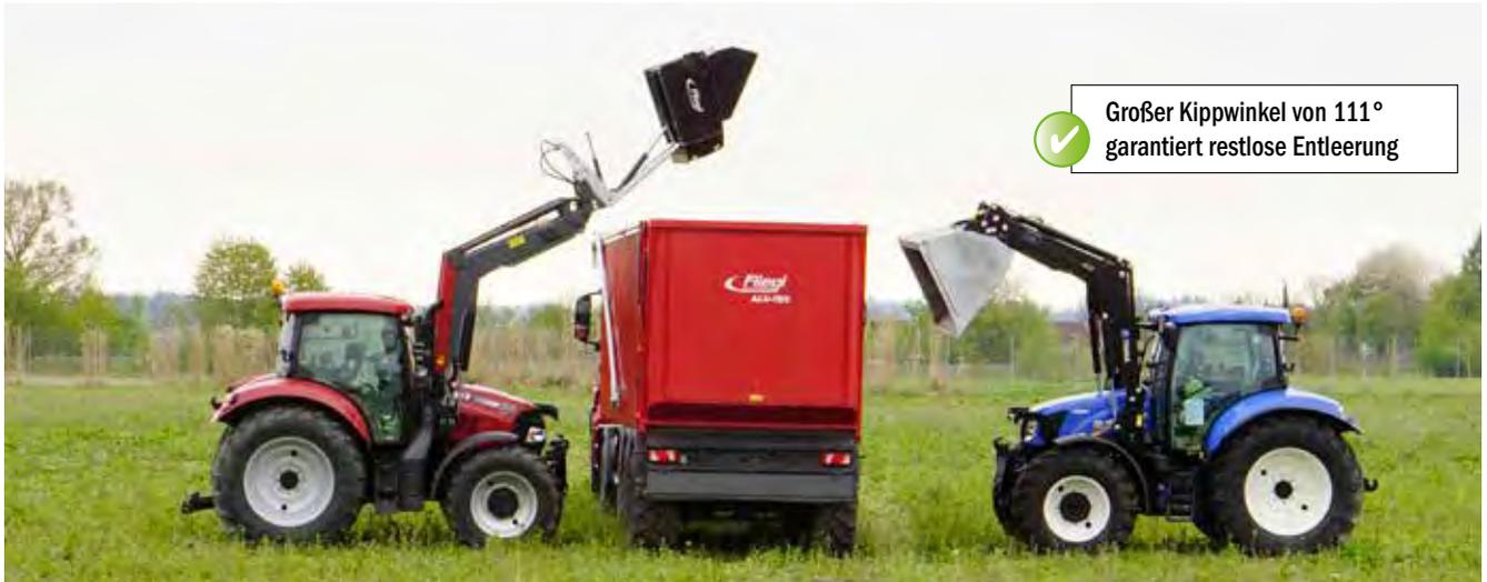
Darstellung der unterschiedlichen Kipphöhen bei gleichem Frontlader
