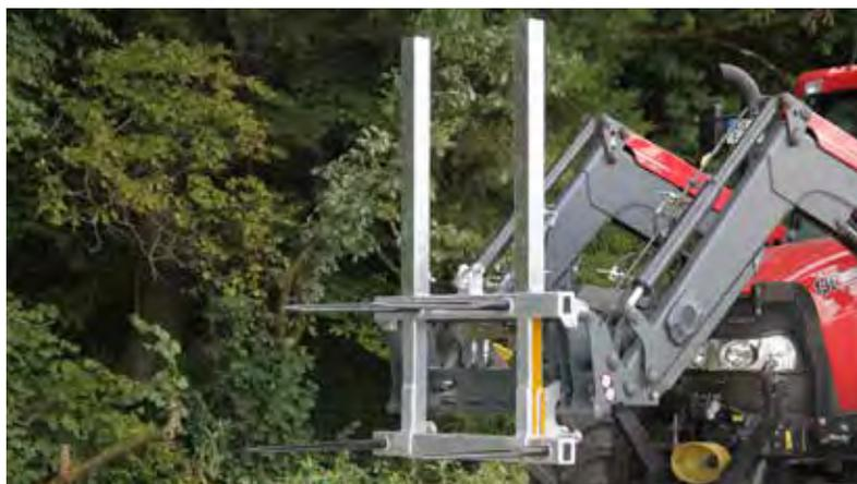
Abb. Aufsteckrohre für Ballengabel Combi mit Erhöhung
