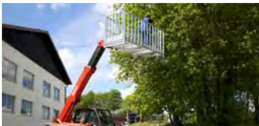
Arbeitsbühne breite Ausführung für Rad- und Teleskoplader
