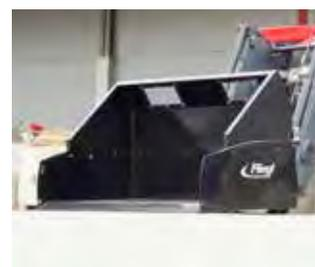
Aufbau mit Sichteausschnitt für maximales Volumen
