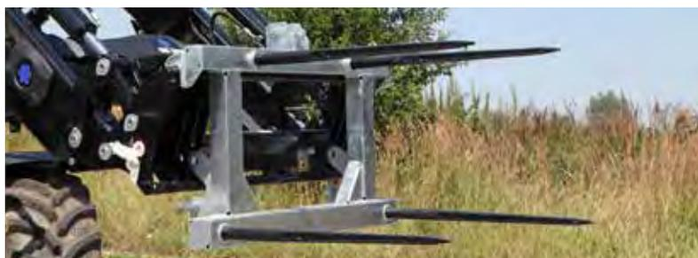
Abb. Ballengabel ohne Erhöhung mit vier Rundballenzinken (2 Zinken - Aufpreis)
