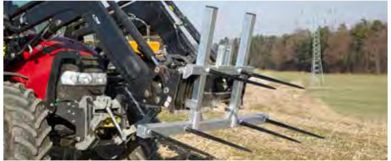
Abb. Ballengabel mit Erhöhung und sechs Rundballenzinken (2 Zinken - Aufpreis)
