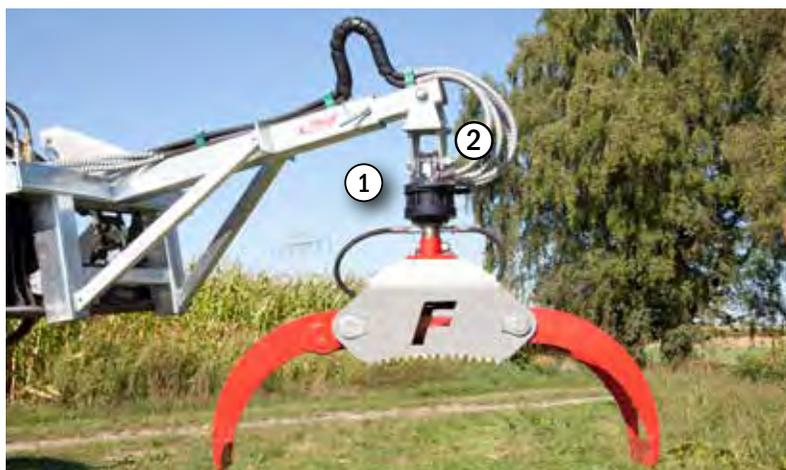
Außerdem bieten wir zusätzlich passende elektromagnetische Umschaltventile für einen 3. bzw. 4. Ölkreislauf an, wodurch kein zusätzliches Steuerventil für die Verladezange bzw. für den Drehmotor erforderlich ist.
