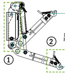
Verriegelungshaken für Fronthydraulik mit Bolzen
