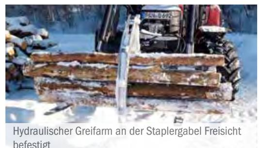
Hydraulischer Greifarm an der Staplergabel Freisicht befestigt
