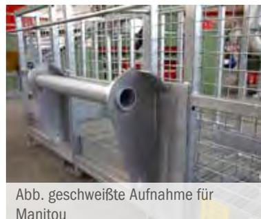
Abb. geschweißte Aufnahme für Manitou
