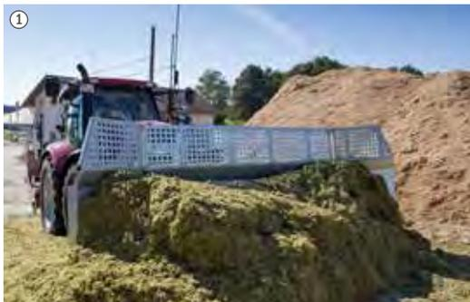
① Aufbaugitter: Eine Erhöhung (400 mm) über die gesamte Arbeitsbreite des Planierschildes. Die Erhöhung wird einfach auf das Planierschild aufgeschraubt.
