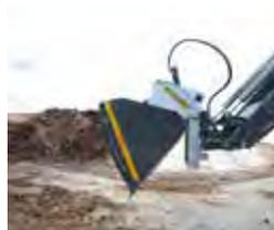
Abb. mit Volumenschaufel von Fliegl am Frontlader
