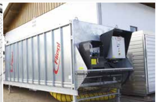
Armoire de commande intégrée/API et groupe hydraulique
