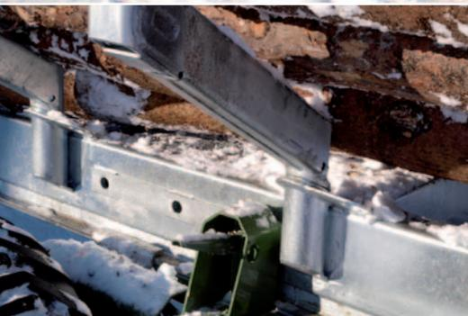
Verschiebbares Achsaggregat (0,5 m verschiebbar), serienmäßig
