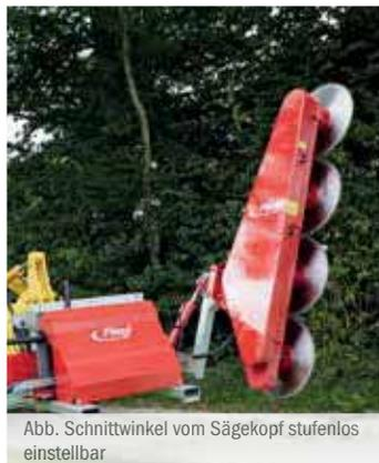
Abb. Schnittwinkel vom Sägekopf stufenlos einstellbar
