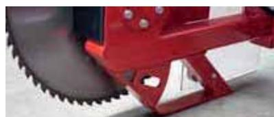
Ein Schutzbügel verhindert eine Berührung des untersten Sägeblattes mit dem Erdreich.
