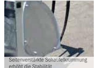
Seitenverstärkte Schaufelkrümmung erhöht die Stabilität
