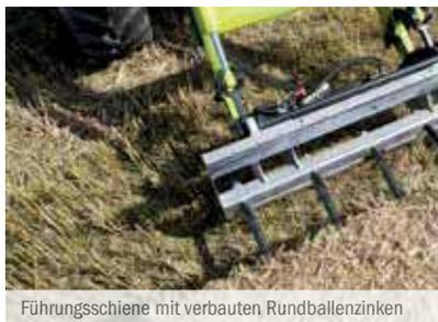
Führungsschiene mit verbauten Rundballenzinken
