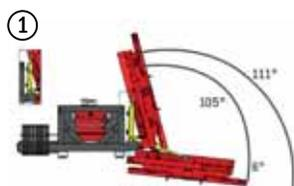
Neigevorrichtung 111° - zum Senkrecht- und Waagerechtschneiden. Passen Sie den Winkel stufenlos den Gegebenheiten an.
