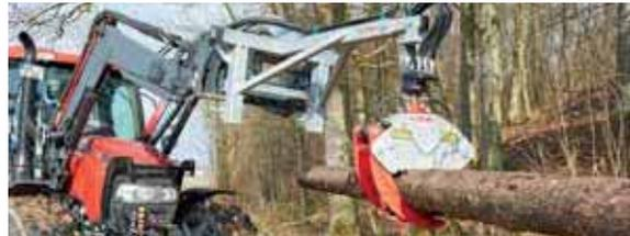
Abb. mit Lasthakenverlängerung (Euronorm-), Drehmotor mit Verladezange
