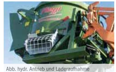
Abb. hydr. Antrieb und Laderaufnahme
