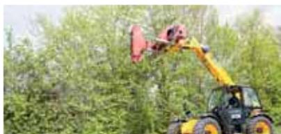
3-Blatt Astsäge am Teleskoplader mit JCB-Aufnahme
