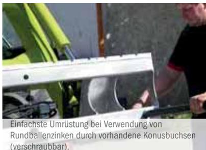
Einfachste Umrüstung bei Verwendung von Rundballenzinken durch vorhandene Konusbuchsen (verschraubbar).
