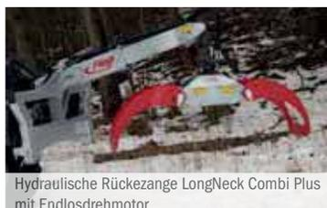
Hydraulische Rückezege LongNeck Combi Plus mit Endlosdrehmotor
