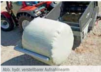
Abb. hydr. verstellbarer Aufnahmearm
