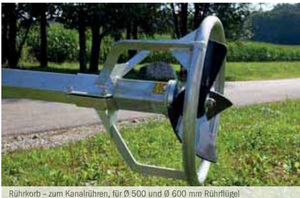
Rührkorb - zum Kanalröhren, für Ø 500 und Ø 600 mm Rührflügel
