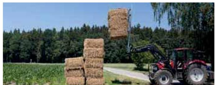
Abb. zeigt Ballengabel mit hydraulischem Niederhalter am Hubstapler - Transport von 3 Quaderballen möglich
