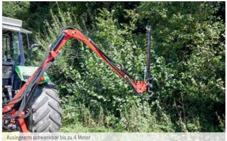
Auslegearm schwenkbar bis zu 4 Meter
