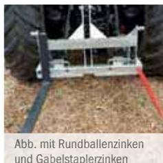
Abb. mit Rundballenzinken und Gabelstaplerzinken
