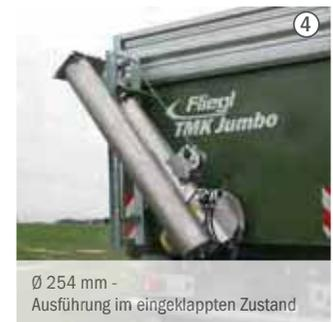
Ø 254 mm - Ausführung im eingeklappten Zustand
