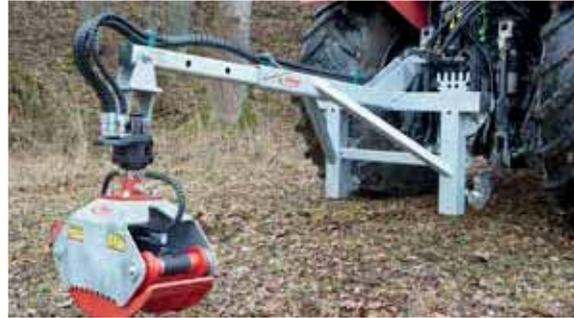
Abb. mit Lasthakenverlängerung (Dreipunkt), Drehmotor mit Verladezange
