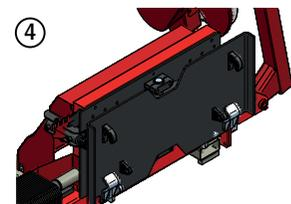
Überlastsicherung als Dämpfadapter: Bei zu hohem Anpressdruck neigt sich der Kopf nach hinten zum Schutz vor Blockieren der Sägeblätter.
