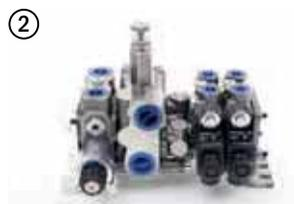
Steuerblock mit integrierten Drucksensoren gibt bei zu hohem Öldruck akustisches Signal in die Fahrerkabine, so wird ein blockieren der Sägeblätter verhindert. Dieser Steuerblock ermöglicht ein gleichzeitiges Bedienen aller Funktionen während der Arbeit.
