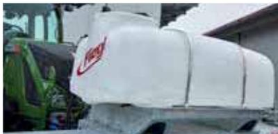
Wassertank 300 l für die Sprüheinrichtung
