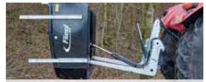
2-Zylinder-System für besten Kippwinkel 111°
