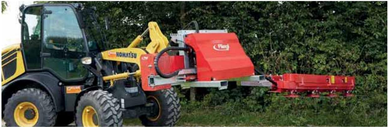
Abb. Mit Radladeraufnahme beim waagrecht schneiden
