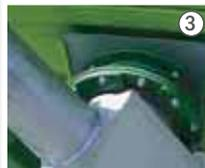
Über Drehgelenk einschiebbar am Fliegl-Kornschieber 400 x 300 mm
