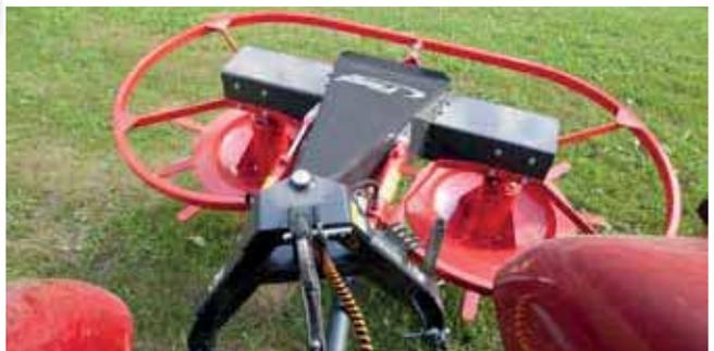
Flachsilverteiler Duo an der Heckhydraulik
