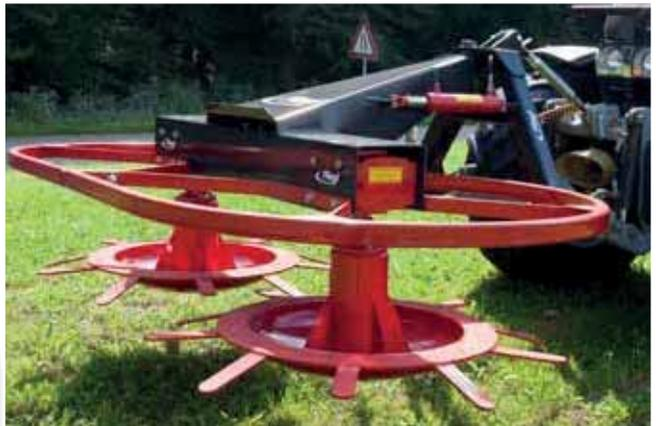
Flachsilverteiler Duo an der Fronthydraulik
