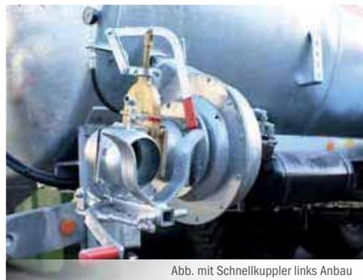
Abb. mit Schnellkuppler links Anbau
