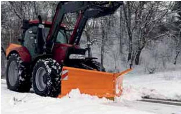
Abb. Verzinkt und zusätzlich Schutzlackiert für besten Rostschutz
