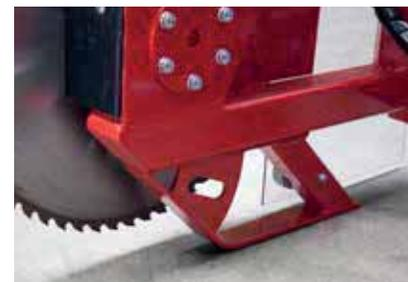
Ein Schutzbügel verhindert eine Berührung des untersten Sägeblattes mit dem Erdreich.
