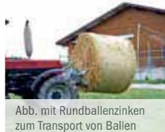
Abb. mit Rundballenzinken zum Transport von Ballen
