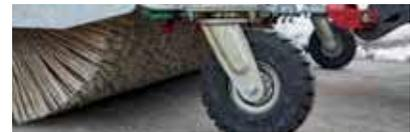
Schwerlastrad mit superelastischen Vollgummireifen (Ø 300 mm), Breite: 105 mm, kugelgelagert, abriebfeste Lauffläche, stahlgeschweißte Schwerlastrolle, schwere Drehkranausführung
