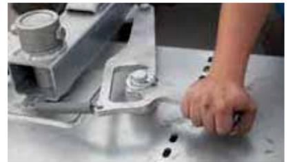
Schwenkbock mechanisch (30° nach links und rechts)
