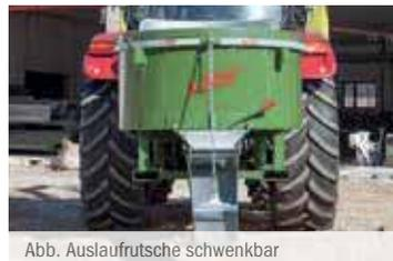
Abb. Auslaufrutsche schwenkbar
