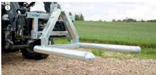
Abb. mit Ballentransportgerät seitlich verstellbar
