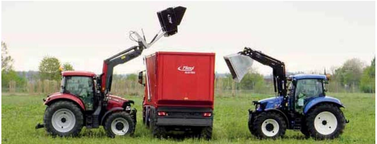
Darstellung der unterschiedlichen Kipphöhen bei gleichem Frontlader
