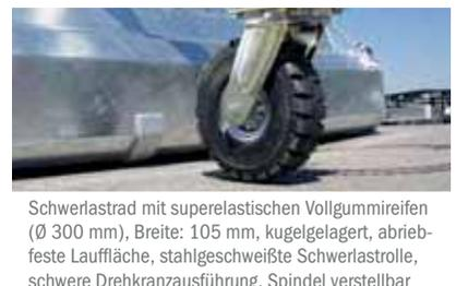
Schwerlastrad mit superelastischen Vollgummireifen (Ø 300 mm), Breite: 105 mm, kugelgelagert, abriebfeste Lauffläche, stahlgeschweißte Schwerlastrolle, schwere Drehkransausführung, Spindel verstellbar
