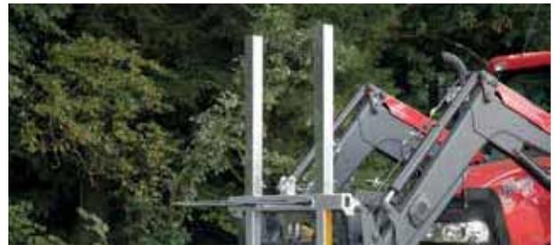
Abb. Aufsteckrohre mit Erhöhung
