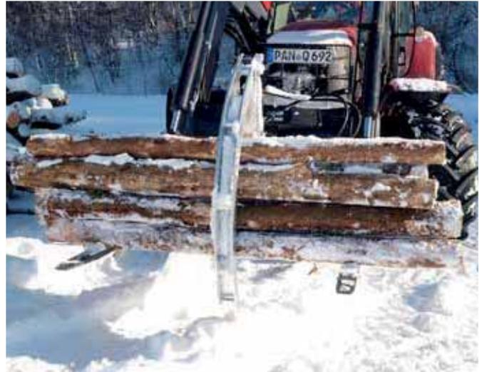
Hydraulischer Greifarm an der Staplergabel Freisicht befestigt
