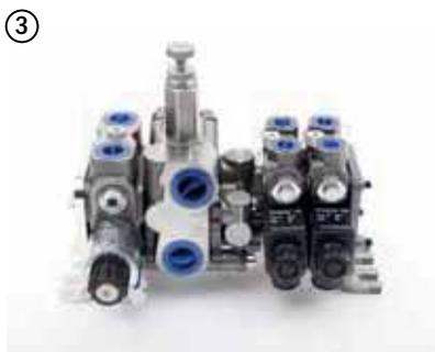
Steuerblock mit integrierten Drucksensor gibt bei hohen Öldruck akustisches Signal in die Fahrerkabine, so wird ein blockieren der Sägeblätter verhindert. Dieser Steuerblock ermöglicht ein gleichzeitiges Bedienen aller Funktionen während der Arbeit.
