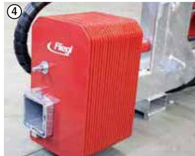
Seitliches Kontergewicht – dadurch minimale Belastung der Schwinge des Trägerfahrzeugs.
