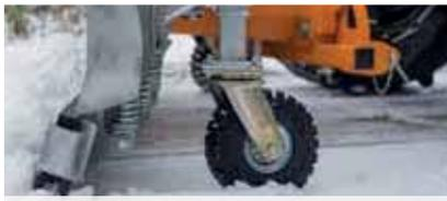
Schwerlastrad mit superelastischen Vollgummireifen (Ø 306 mm), Breite: 105 mm, kugelgelagert, abriebfeste Lauffläche, stahlgeschweißte Schwerlastrolle, schwere Drehkranzausführung, Spindel verstellbar
