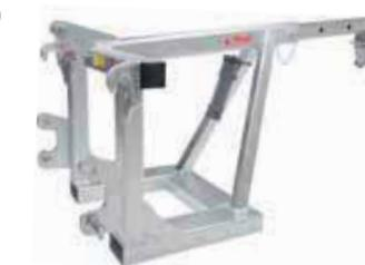
Abb. zeigt Euronorm- und Dreipunktaufnahme, Stapleraufnahme
