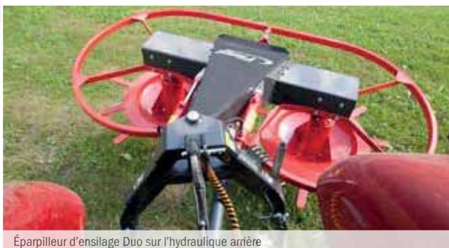
Épargilleur d'ensilage Duo sur l'hydraulique arrière
