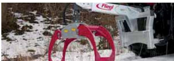
Grappin hydraulique LongNeck Combi avec articulation pivot mécanique
