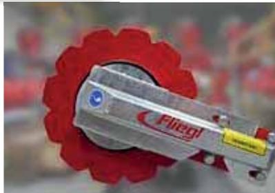
Couvercle de protection du moteur hydraulique
