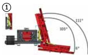
Dispositif d'inclinaison à 111° - pour coupes verticales et horizontales. Ajustez l'angle progressivement en fonction de la situation.
