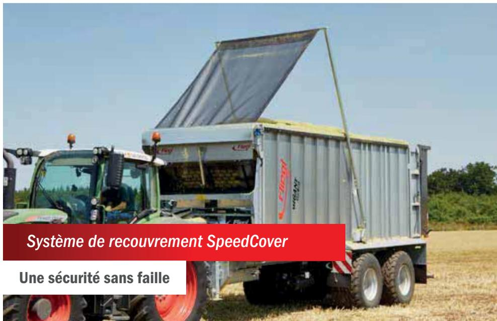
*Système de recouvrement SpeedCover*
