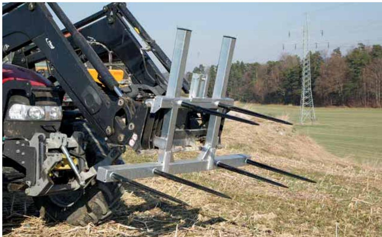
Illustration : pique botte à fond poussant avec dispositif de surélévation et six broches pour balles rondes (2 broches - supplément)
