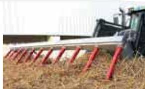
Les douilles coniques sont présoudées dans un support pour broches solide
