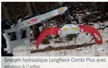
Grappin hydraulique LongNeck Combi Plus avec rotateur à l'infini
