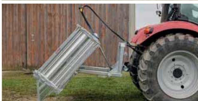
Angle de basculement arrière jusqu'à 55°
