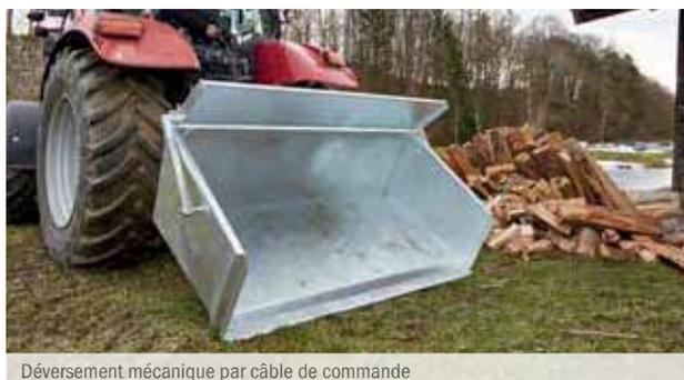
Déversement mécanique par câble de commande
