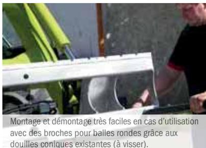
Montage et démontage très faciles en cas d'utilisation avec des broches pour balles rondes grâce aux douilles coniques existantes (à visser).
