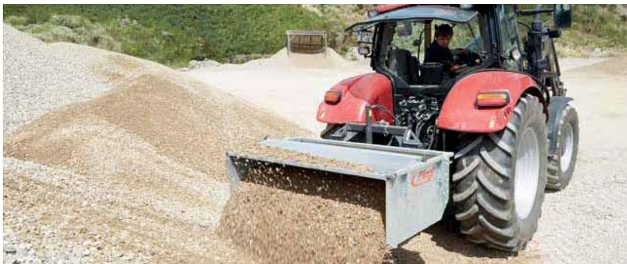
Pour charger une benne par ex. avec des céréales, des engrais chimiques, etc. Le bras d'extension particulièrement long permet d'atteindre une hauteur de basculement très élevée.
