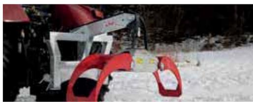
Grappin hydr. Combi RZ 185 avec articulation pivot mécanique
