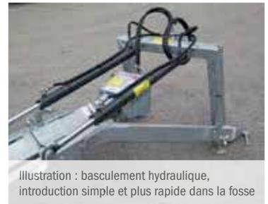
Illustration : basculement hydraulique, introduction simple et plus rapide dans la fosse
