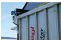
Moteur à huile à entraînement hydraulique pour le déploiement du filet de recouvrement
