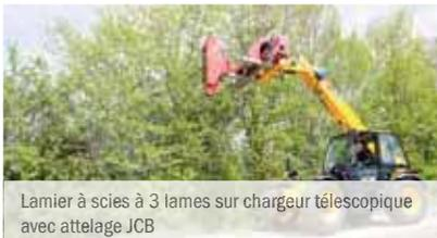
Lamier à scies à 3 lames sur chargeur télescopique avec attelage JCB
