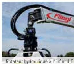
Rotateur hydraulique à l'infini 4,5 t
