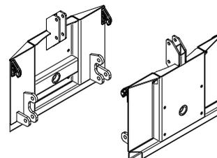
Adaptateur d'attelage pour attelage trois points, aux normes européennes ou sur chargeur agricole, sur pneus ou télescopique
