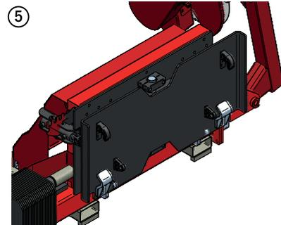
Limiteur de charge comme adaptateur d'amortissement : si la pression d'appui est trop élevée, la tête bascule en arrière pour assurer la protection en cas de blocage des lames de scie.
