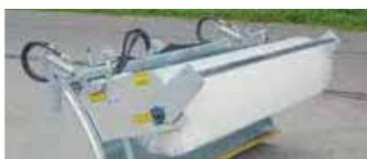
Illustration : dispositif de levage hydr. (2 ED), racloir PU (avec supplément) et godet à chaud (protection optimale contre la corrosion)
