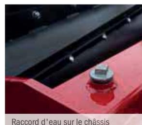
Raccord d'eau sur le châssis
