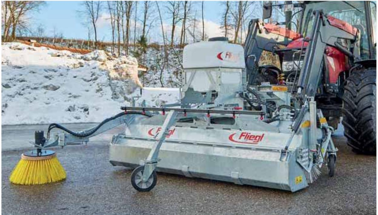
KEH Type 500 avec système de fixation aux normes européennes, cuve de collecte des déchets hydraulique, balai latéral, dispositif d'arrosage 120 l et roue porteuse avant
