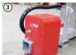
Contrepoids latéral - charge minimisée sur le balancier du véhicule porteur.
