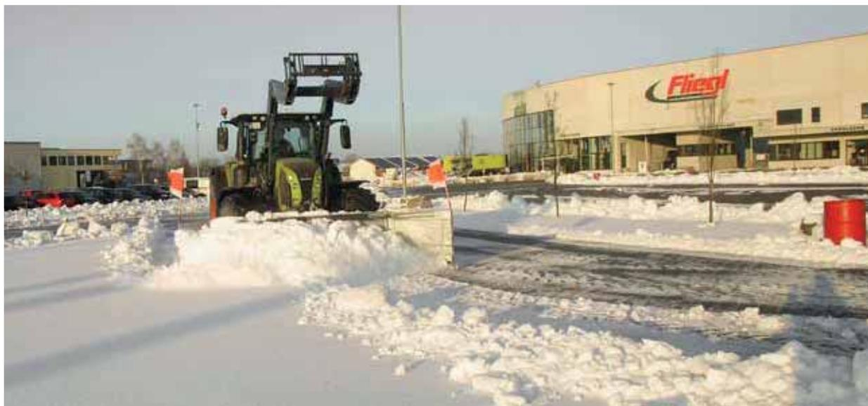
La largeur de déblayage peut être réglée en continu dans la zone définie à l'aide des deux panneaux latéraux.
