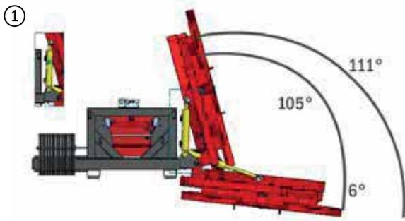
Dispositif d'inclinaison à 111° - pour coupes verticales et horizontales. Ajustez l'angle progressivement en fonction de la situation.
