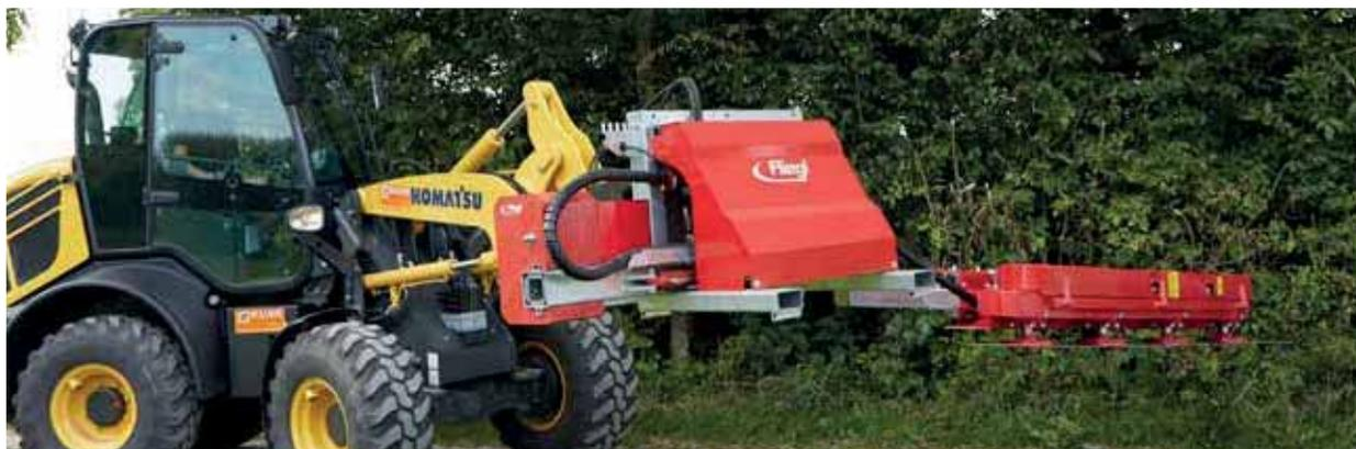
Illustration avec attelage pour chargeur sur pneus en coupe horizontale
