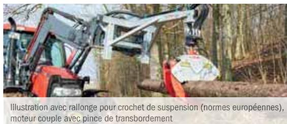
Illustration avec rallonge pour crochet de suspension (normes européennes), moteur couple avec pince de transbordement
