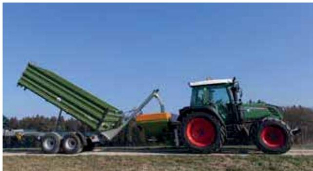
La vis de transbordement peut être fixée très facilement à toute sorte de remorque basculante. Le maniement s'effectue facilement. Réglage en continu de l'angle de déversement par un treuil à câble.
