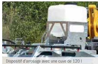
Dispositif d'arrosage avec une cuve de 120 l
