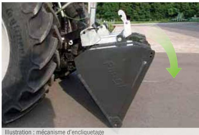
Illustration : mécanisme d'encliquetage
