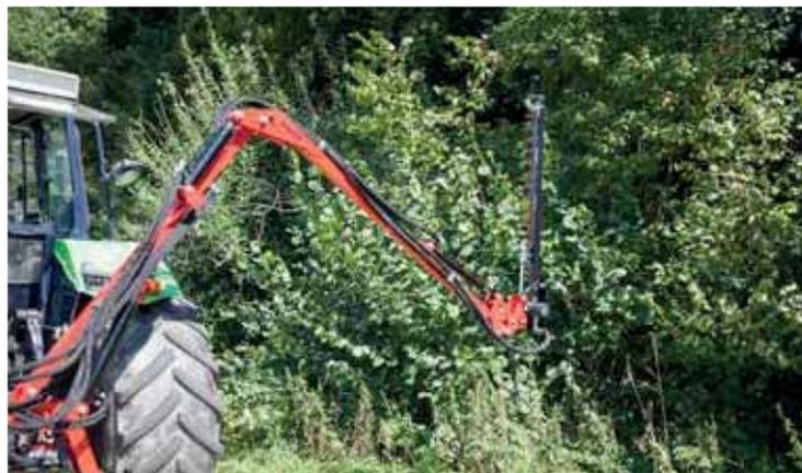
Bras d'extension pivotant jusqu'à 4 mètres
