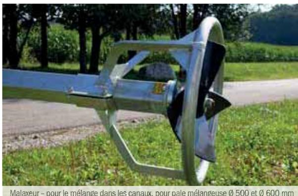
Malaxeur - pour le mélange dans les canaux, pour pale mélangeuse Ø 500 et Ø 600 mm
