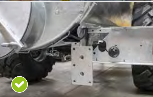
Anbaukonsole für Schleppschlauch- oder Schleppschuhverteiler SERIE ab 5000L
