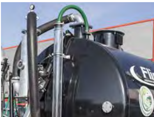
Füllstandsanzeige aus Plexiglas
