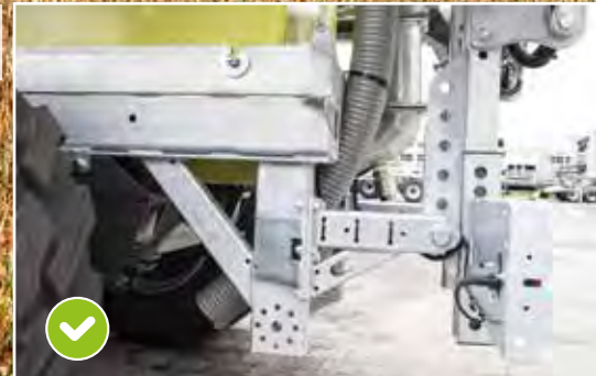
Anbaukonsole für Schleppschuhverteiler und Vierpunkt hydraulik
