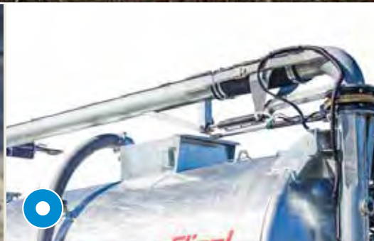
Absaugarm hydraulisch schenkbar 8"
