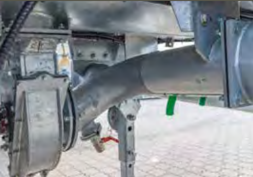
Turbobefüller mittig unter Fass Ansaugvorgang rechts und links möglich
