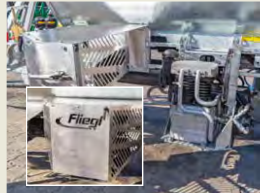
Kolbenkompressor mit bis 3,3 m 3 Luftleistung
