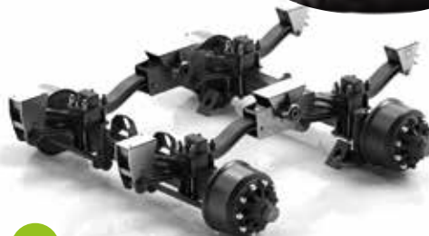
Achsaggregat »Gigant Plus« bei MAXX Line Plus 16.000 L und 18.000 L
