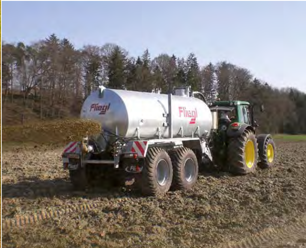
Pendelverteiler für grobtropfiges Ausbringen
