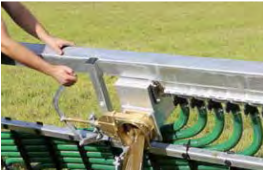
Staukasten (bei SKATE u. GARANT) für Fremdkörper, mechanische oder hydraulische Entleerung
