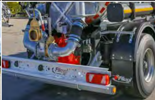
in Pumpausführung mit Vogelsang-Drehkolbenpumpe
