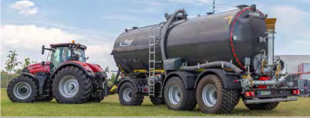
Satteltransportfass STF 27500 mit integriertem Dolly
