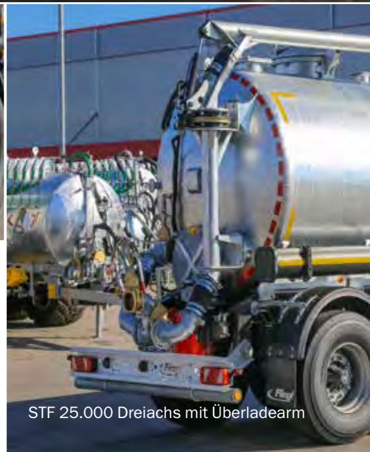
in Pumpausführung mit Vogelsang-Drehkolbenpumpe
