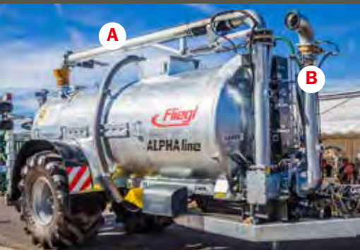
Zu A: Absaugarm 4500mm Länge, beidseitig schwenkbar Zu B: Saugrüssel mittig für beidseitiges Ansaugen einstellbar
