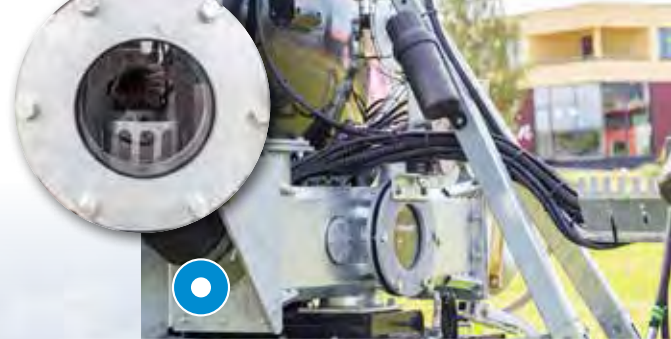
Pumpenkasten mit Schauglas und Fremdkörperabscheider
