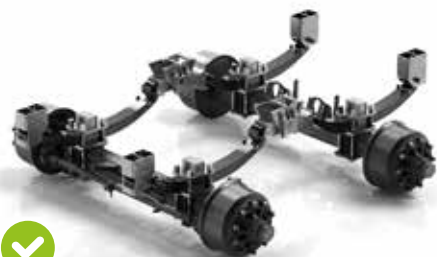
Achsaggregat »Gigant« bei MAXX Line Plus 14.000 L
