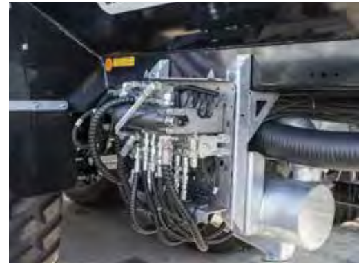
Steuerblock Load Sensing oder Konstantstrom
