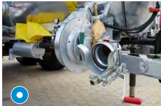
Turbobefüller mit Schnellkuppler
