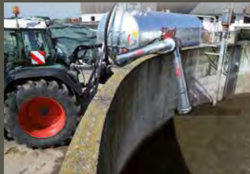
Saugrüssel Elefant 8“ Links und rechts möglich. Länge 5000 mm mit Vierfach-Steuerblock Turbobefüller und Teleskopauschub 1500 optional
