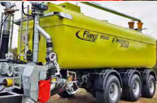
Roadx Poly Line mit mechanisch angetriebener Drehkolbenpumpe zum Ansaugen
