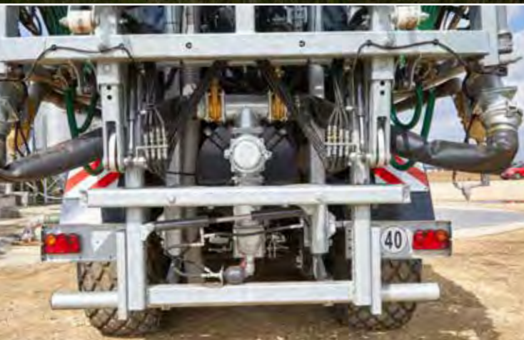
Fliegl SKATE 210 mit Pendelrahmen für verbesserten Hangausgleich (nur bei SKATE 210/240)
