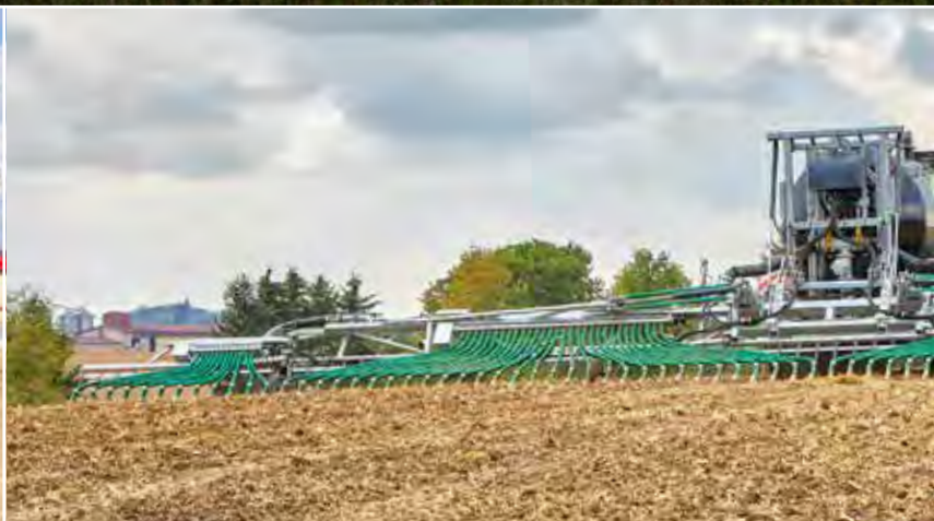
Fliegl SKATE 210 mit Pendelrahmen für verbesserten Hangausgleich (nur bei SKATE 210/240)
