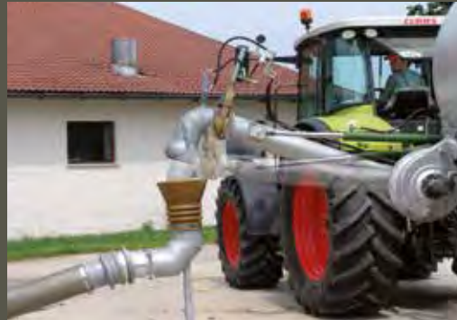
Saugrüssel (optional mit Turbobefüller 8“) Links und rechts möglich. Mit Andockstation; Druckfolgeventil und hydraulische Kompressorumschaltung
