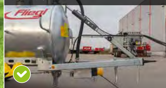
Fasskippzylinder mit Fallstützfuß ab 5000L
