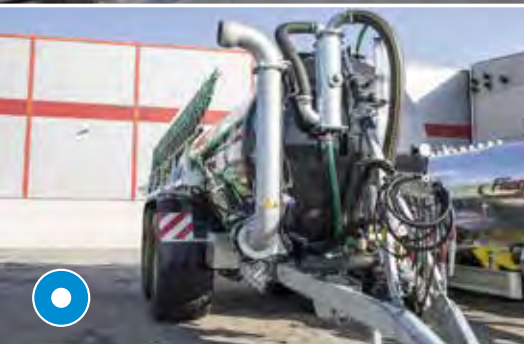
Saugrüssel – links oder rechts – für bequemes Ansaugen
