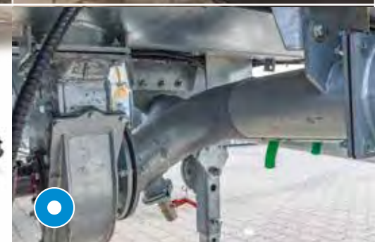
Turbobefüller hydraulisch, mittig unter dem Fass
