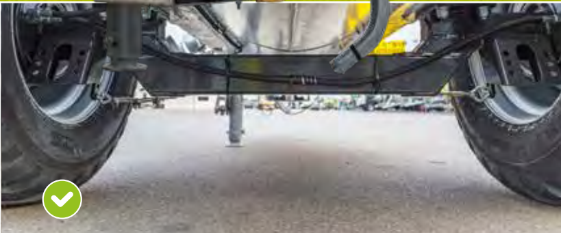
Ab 5000 Liter mit gekröpfter Achse: Niedriger Schwerpunkt sorgt für optimales Fahrverhalten am Hang
