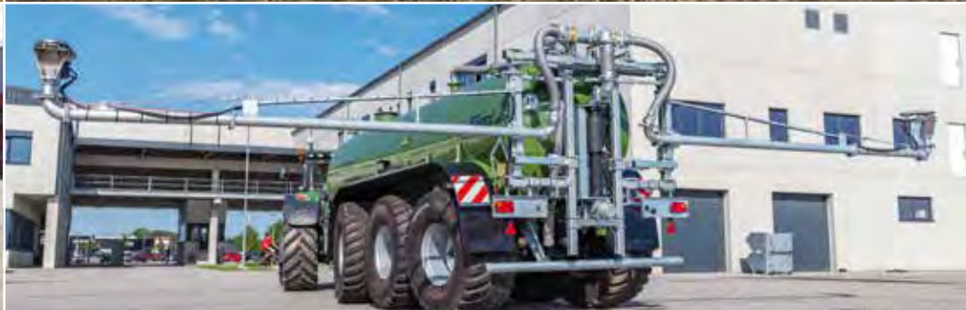
Der Düsenbalkenverteiler mit einer maximalen Arbeitsbreite von 21 – 30 m
