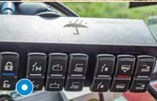
Bedienpult für Fass + Verteiler Abbildung: Rotes Blinklicht zum Schutz der Pumpe vor Trockenlauf
