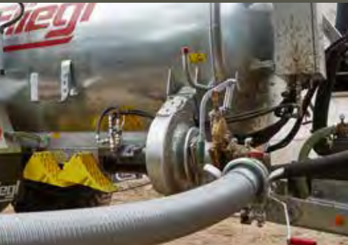
Turbobefüller mit Schnellkuppler (6“ oder 8“) Links, rechts und hinten möglich.
