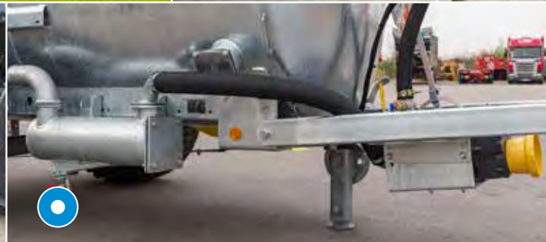
Schalldämpfer mit Ölabscheider
