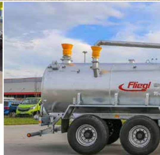
Road X Line 16.000 Tandem mit Kreiselpumpe und Überladearm, beidseitig schwenkbar
