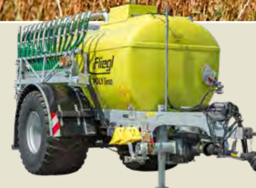
PFW 9000 mit Schleppschuhverteiler Skate 90
