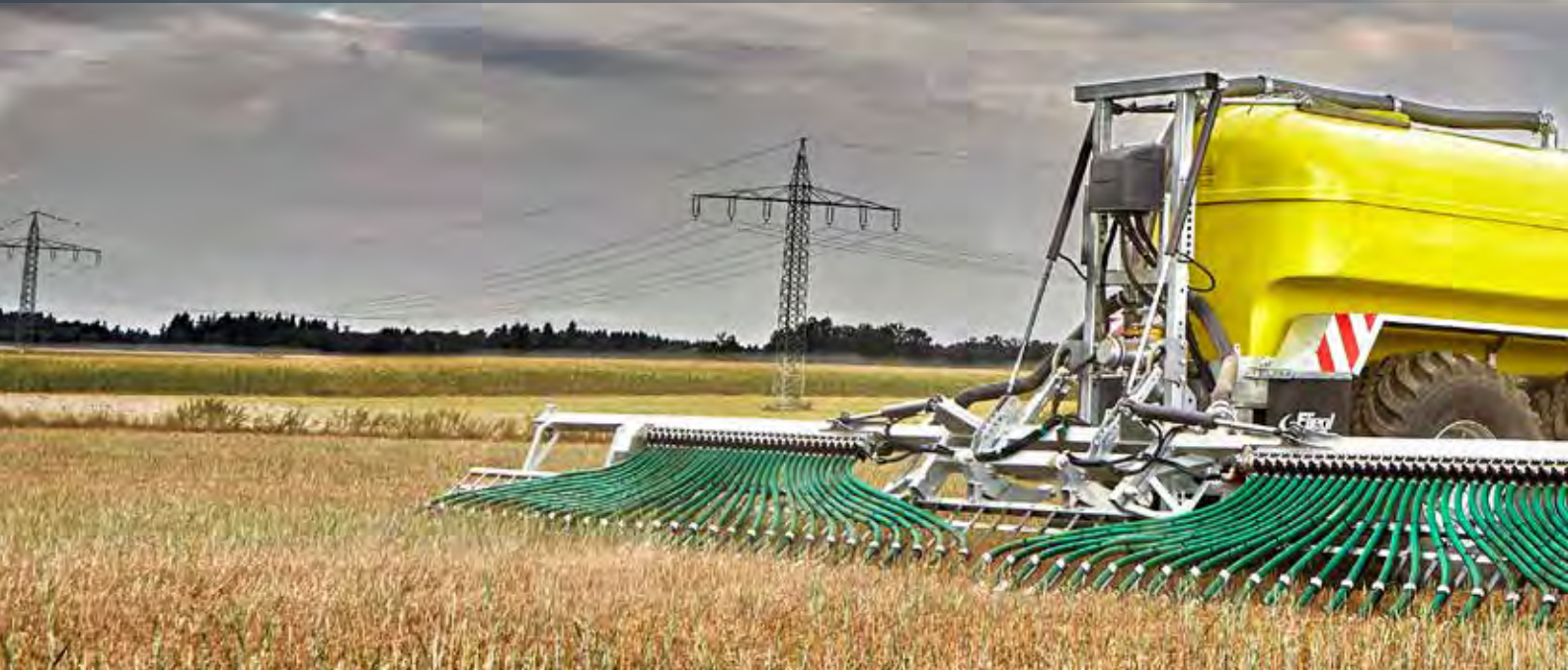
Anbaukonsole für Schleppschuhverteiler und Vierpunkt hydraulik
