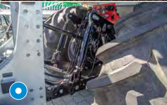
Dreipunkthydraulik wird beim Lenken der Achse mitgeführt
