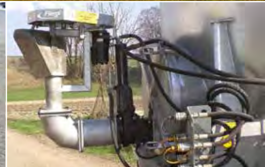
Hydraulischen Pendelverteiler mit einer Arbeitsbreite von 12 bis 18 m.
