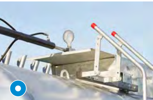
Bei Pumpfass: Hydraulischer Schubdeckel
