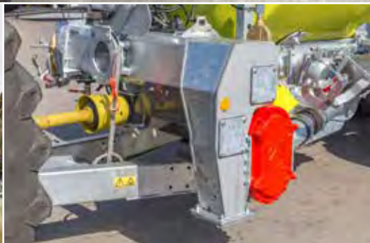
Roadx Poly Line mit mechanisch angetriebener Drehkolbenpumpe zum Ansaugen
