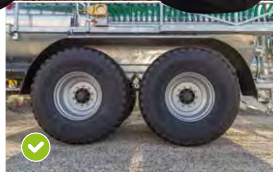
Radausschnitt und Bereifung Bereifung 750/60-R30,5"
