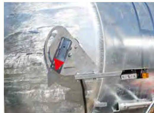
Füllstandsanzeiger mit Schwimmerkugel
