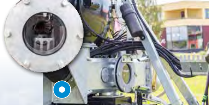
Carter de pompe avec jauge et séparateur de corps étrangers
