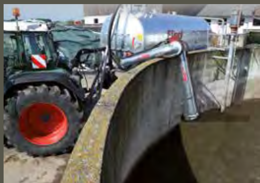
Embout d'aspiration éléphant 8" Possible à gauche et à droite. Longueur 5000 mm avec bloc de commande quadruple Remplisseur turbo et sortie télescopique de 1500 mm en option
