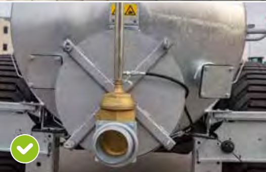
Bride aveugle arrière et préparation pour vidange en pente
