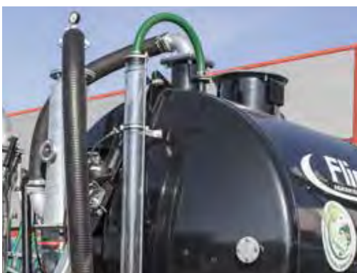
Indicateur du niveau de remplissage en plexiglas
