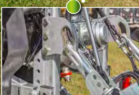
Compensation automatique de dévers pour une adaptation optimale au sol
