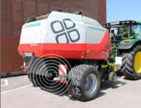
Exemple de fixation de la balise sur une presse à ballots ronds
