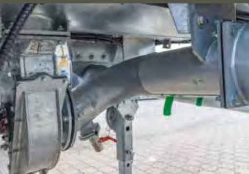
Remplisseur turbo au milieu sous la citerne Aspiration possible à droite et à gauche
