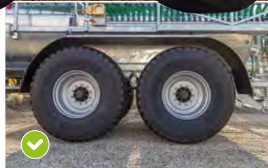
Passage de roue et pneumatiques Pneumatiques 750/60-R30,5"
