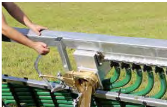
Collecteur (pour SKATE et GARANT) pour corps étrangers, vidange mécanique ou hydraulique
