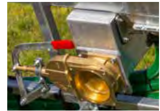
Collecteur de séparation des corps étrangers
