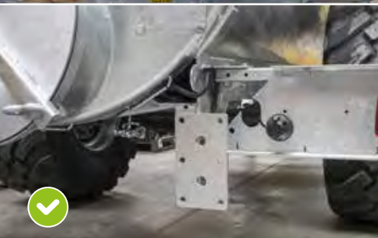
Console de montage pour répartisseur de pendillards de SÉRIE dès 5000 L
