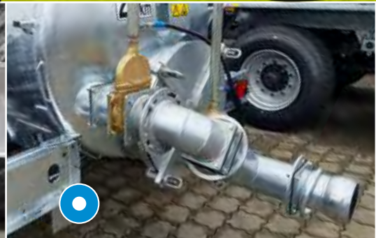
Vidange en pente (avec tube intérieur)
