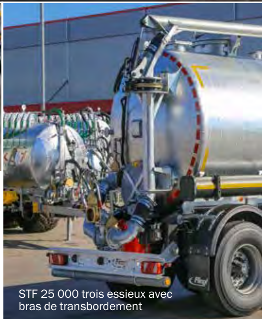
en variante à pompe avec pompe à piston rotatif Vogelsang
