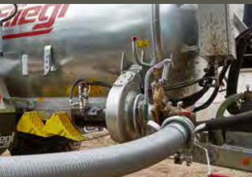
Remplisseur turbo avec système d'accouplement rapide (6" ou 8") Possible à gauche, à droite et à l'arrière.
