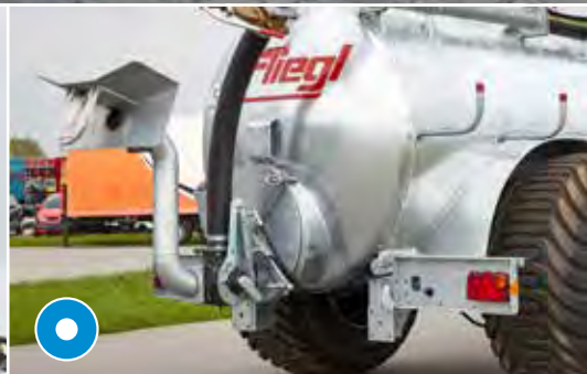
Conduite de rinçage (fonction de mélange)
