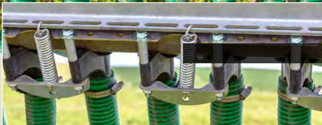
Dispositif de pré-tension à ressort du distributeur à vis FlexFlow
