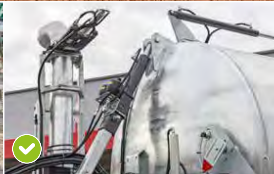
Suspension de timon hydraulique
