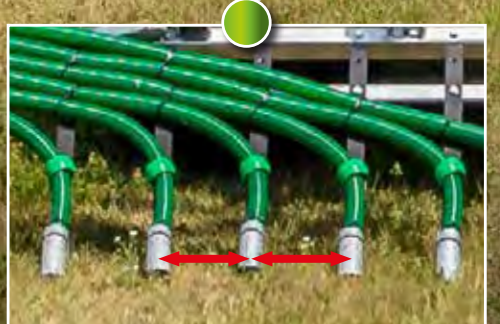
Écart de 250 mm entre les tuyaux
