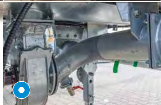
Remplisseur turbo hydraulique, au milieu sous la citerne
