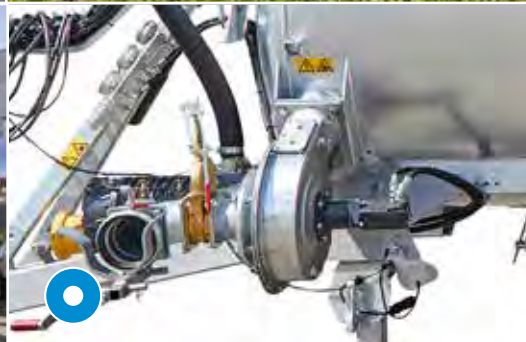
Remplisseur turbo latéral possible à gauche ou à droite
