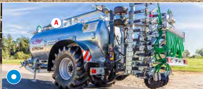
A : bras d'aspiration , longueur 4500 mm, pivotant des deux côtés B : embout d'aspiration central réglable pour aspirer des deux côtés
