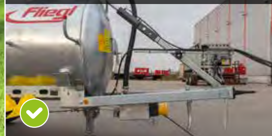
Vérin de basculement de la citerne avec béquille de sécurité dès 5000 L
