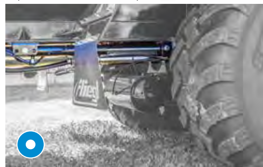
Décalage d'essieu hydraulique
