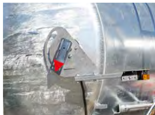
Indicateur du niveau de remplissage avec flotteur
