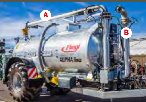
A : bras d'aspiration, longueur 4500 mm, pivotant des deux côtés B : embout d'aspiration central, réglable pour aspirer des deux côtés
