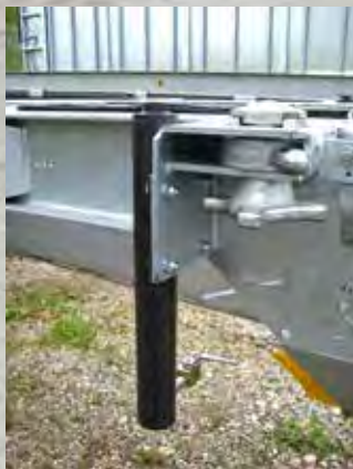
Cylindre pour dispositif de levage hydraulique
