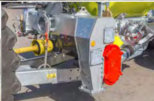
Road X Poly Line avec pompe à piston rotatif à entraînement mécanique pour l'aspiration
