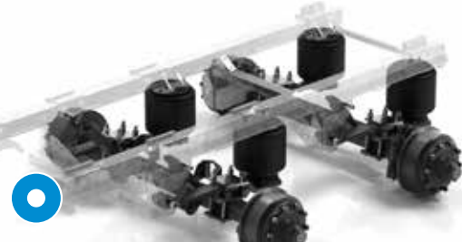
Suspension pneumatique (14 000 – 27 500 litres)
