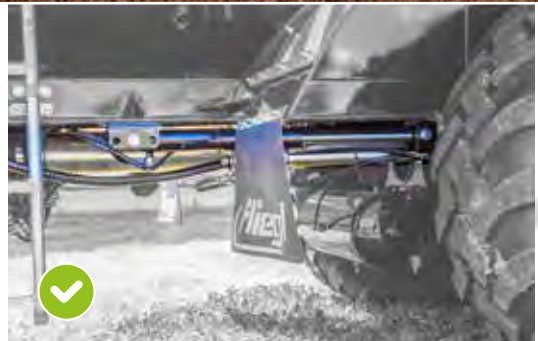
Décalage d'essieu hydraulique
