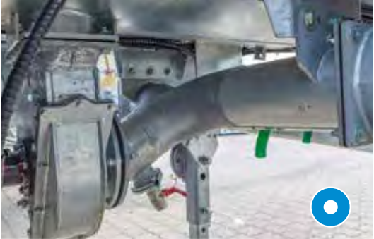
Sur citerne sous vide : remplisseur turbo au milieu sous la citerne
