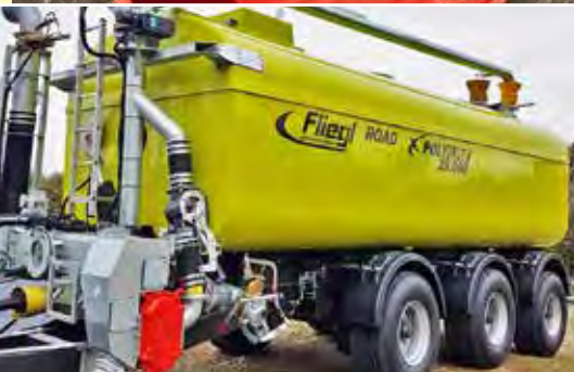
Road X Poly Line avec pompe à piston rotatif à entraînement mécanique pour l'aspiration
