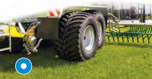
Essieu télescopique (uniquement possible avec le module pendulaire Boogie SB)
