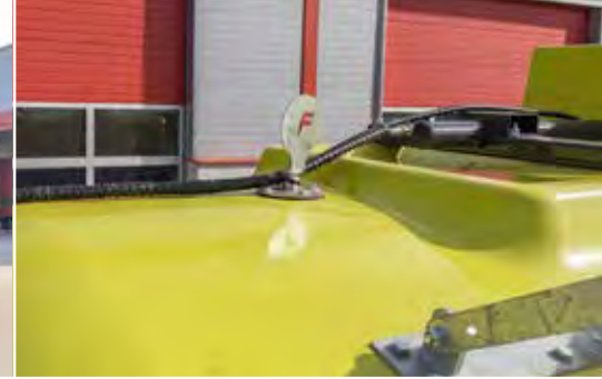
Indicateur du niveau de remplissage en haut
