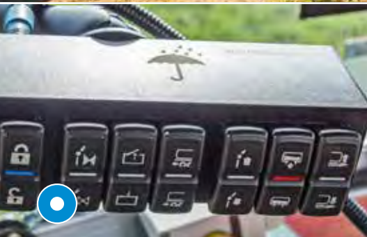
Pupitre de commande pour citerne + répartisseur Illustration : feu clignotant rouge pour protéger la pompe contre la marche à vide
