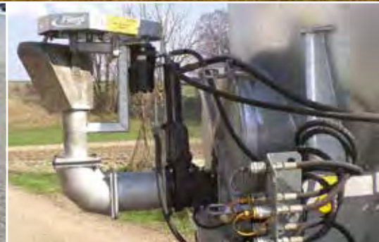
Répartisseur pendulaire hydraulique avec une largeur de travail de 12 à 18 m.
