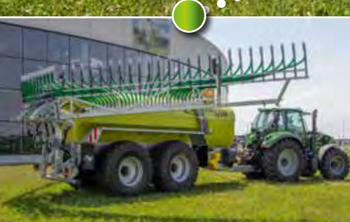
Tuyaux d'écoulement protégés contre les plis par le mécanisme de basculement spécial
