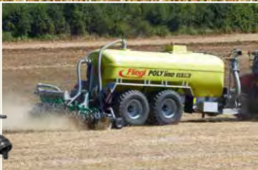
PFW 15 500 avec déchaumeur à disques pour lisier « Maulwurf » 6 m
