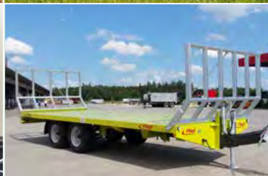
Tandem-Plattformwagen mit Ballensicherungsgitter und Sonderlackierung (optional)
