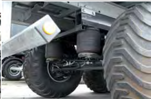
Optional: Luftfederung mit automatischer Kippabsenkung
