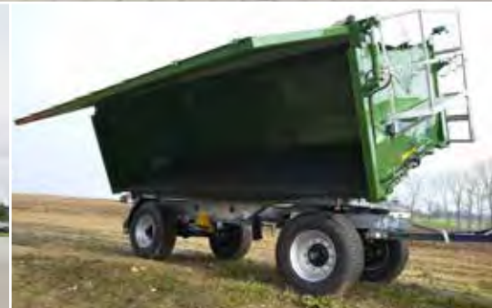
ZDMK 200 Profi mit hydraulischer Seitenwandöffnung
