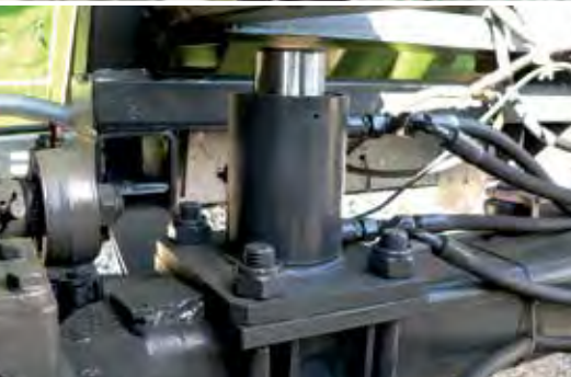
Optional: Hydraulische Abstützung auf die Achse
