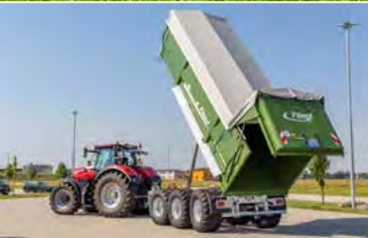
Der TMK 373 Profi mit einer Muldenlänge von 7,30 m
