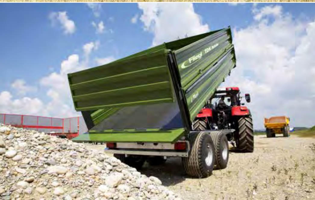
TDK 160 mit Aufbau 1800 mm (3 x 600 mm Bordwand)
