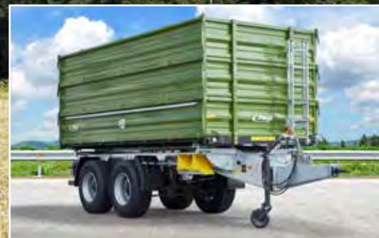
TDK 160 mit Aufbau 1800 mm (3 x 600 mm Bordwand)
