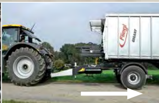
Hydraulische Sattelplattenverschiebung für Einachs- und Tandem-Dolly
