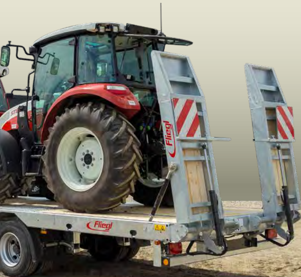
Der TPA 370 Stirnwand 800 mm in Serie Auffahrampen klappbar
