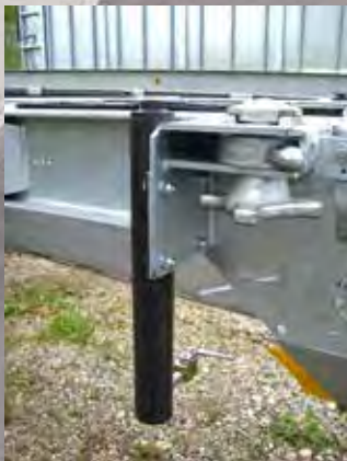
Zylinder für hydraulische Hebeeinrichtung
