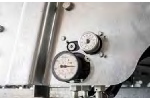
Mechanisches Potentiometer mit einstellbarer Vorschubgeschwindigkeit am Streuwerk
