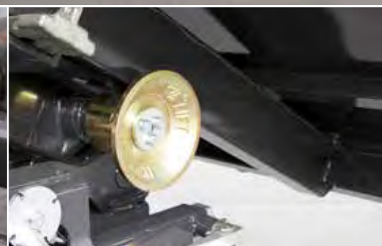
Große Stahlguss-Ablaufrollen (ø 310mm) mit großer Zentrierschräge erleichtern das Aufziehen des Containers.
