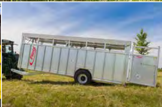
Hydraulische Hebeeinrichtung zum erleichterten Ein- und Ausstieg
