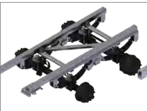
Gigant-Tandemaggregat (TMK 200 ab 5,65 m Muldenlänge)
