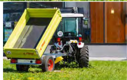
Einachs-Dreiseitenkipper für jede Schleppergröße passend
