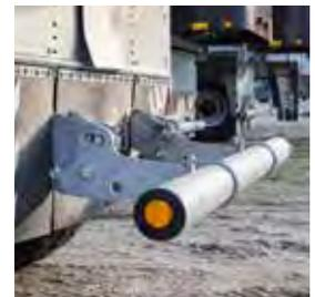
En option : protection anti-encastrément arrière rabattable mécaniquement
