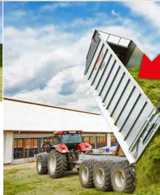
Parois latérales stables en acier galvanisé de haute qualité, conçues à partir de différentes pièces emboîtables à visser. Remplacement facile et peu onéreux en cas d'endommagement.
