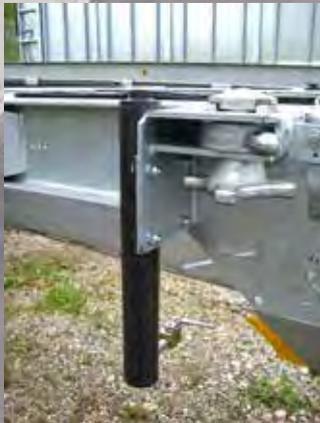
Cylindre pour dispositif de levage hydraulique
