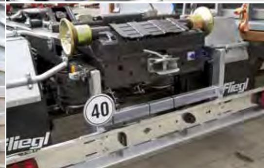
En option : support hydraulique sur l'essieu
