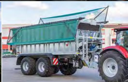
Filet de recouvrement rabattable sur le côté
