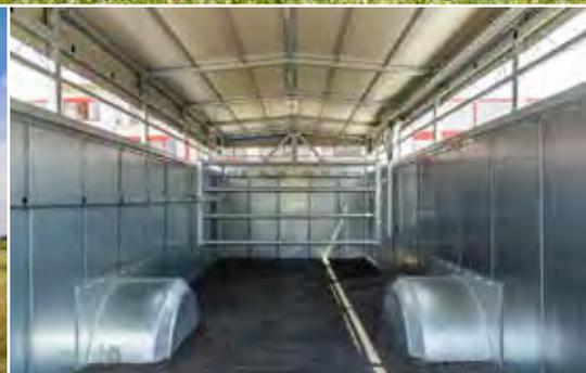
Grille de séparation réglable et fond en tôle gaufrée avec ouverture d'évacuation
