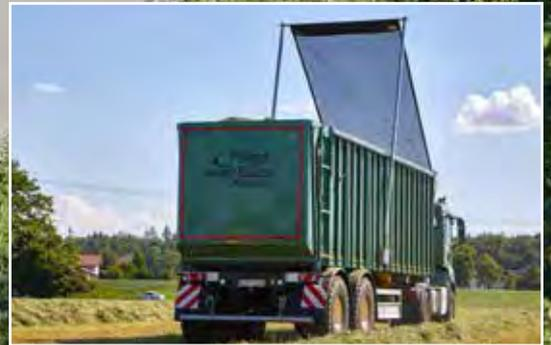
Déploiement par tension de ressort
