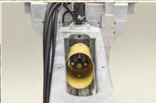
L'épandeur est entraîné mécaniquement par un entraînement par prise de force
