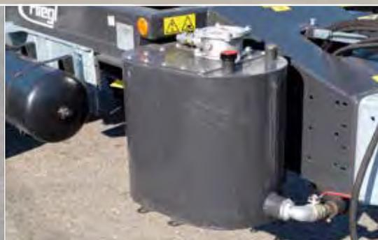
Système hydraulique embarqué à entraînement par arbre de transmission, en option
