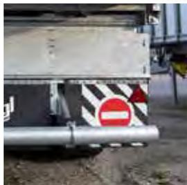
Version 40 km/h (Allemagne) avec protection anti-encastrement rigide
