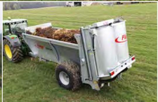
Le coulisseau de stockage entièrement galvanisé est monté de série. Les paliers de l'épandeur sont faciles d'entretien et sont accessibles via une barre de lubrification centrale.
