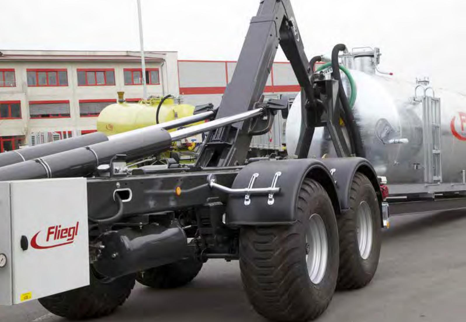
Crochet de montage forgé, pouvant être remplacé facilement
