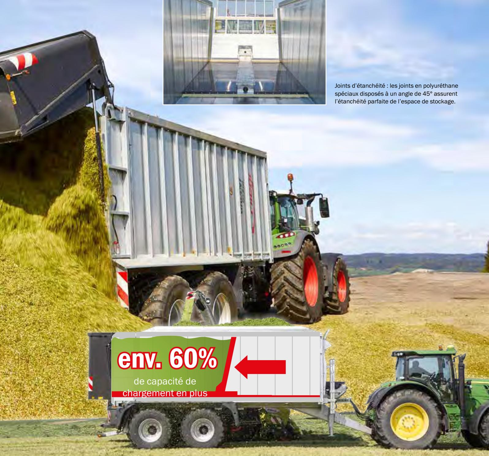
Joint d'étanchéité : les joints en polyuréthane spéciaux disposés à un angle de 45° assurent l'étanchéité parfaite de l'espace de stockage.
