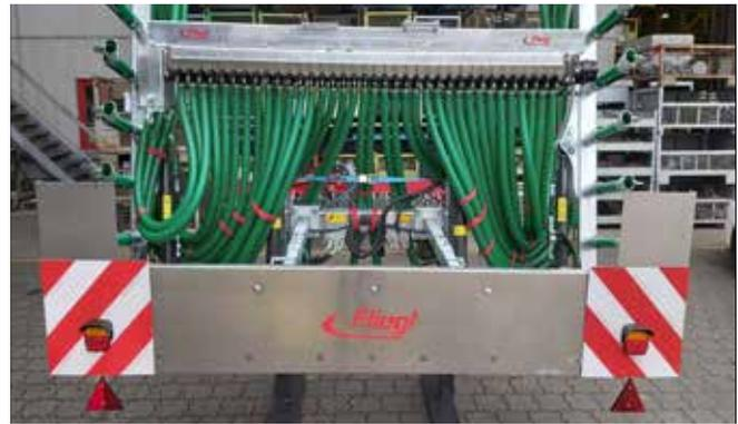
Schleppschuhdüsenschutz mit Beleuchtung und Warntafeln für Strassentransport, optional erhältlich
