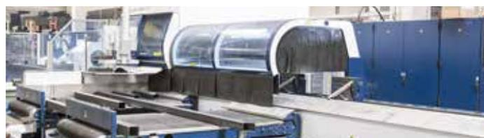
Les installations laser ultra-modernes pour tubes et tôles permettent de fabriquer des éléments complexes rapidement et avec précision.
