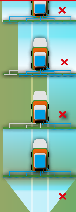
Wettbewerb: Über- und Unterdosierung durch starke Druckschwankungen
