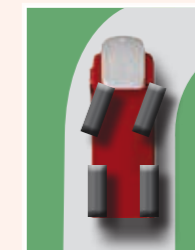
Direction par deux roues
