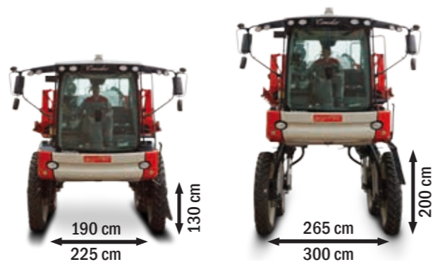
Avec le Condor MountainMasterPlus , les réglages en hauteur de 130 à 200 cm et en largeur de 195 à 270 cm ou de 225 à 300 cm sont possibles.
