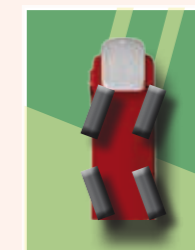
Direction par quatre roues
