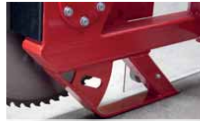
Ein Schutzbügel verhindert eine Berührung des untersten Sägeblattes mit dem Erdbreich.
