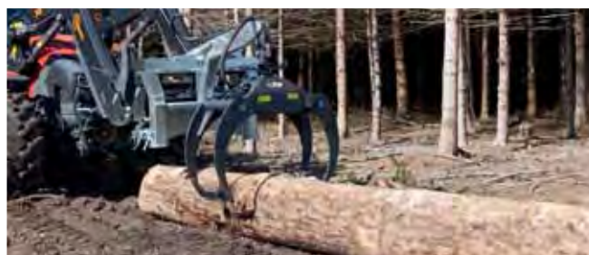
Hydr. Rückezege Combi RZ 185 mit mechanischem Drehgelenk
