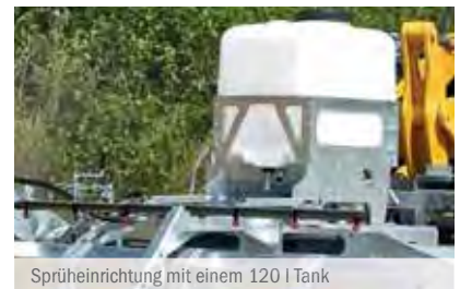
Sprührichtung mit einem 120 l Tank
