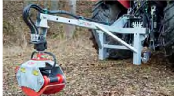
Abb. mit Lasthakenverlängerung (Dreipunkt), Drehmotor mit Verladezange
