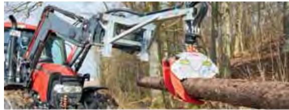
Abb. mit Lasthakenverlängerung (Euronorm-), Drehmotor mit Verladezange
