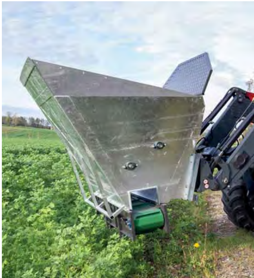
3 Dosierwalzen bestückt mit Messern
