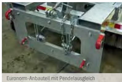
Euronorm-Anbauteil mit Pendelausgleich
