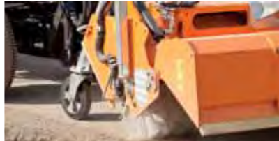
Serienmäßig mit Freikehrmodus: Kehren mit geöffneter Schmutzsammelwanne
