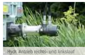
Hydr. Antrieb rechts- und linkslauf
