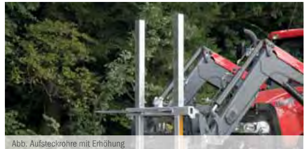
Abb. Aufsteckrohre mit Erhöhung
