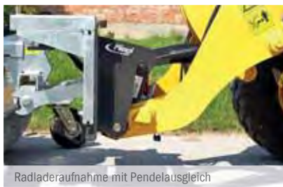
Radladeraufnahme mit Pendelausgleich
