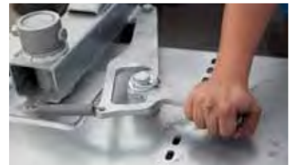
Schwenkbock mechanisch (30° nach links und rechts)
