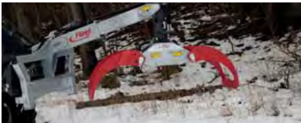
Hydraulische Rückezange LongNeck Combi Plus mit Endlosdrehmotor
