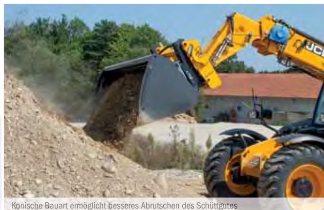
Konische Bauart ermöglicht besseres Abrutschen des Schüttgutes
