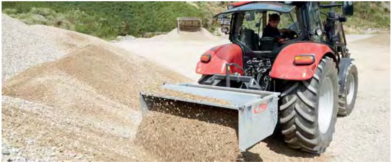
Zum Beladen eines Kippers mit z.B. Getreide, Kunstdünger usw.. Durch die besonders langen Auslegearme wird eine enorme Abkipphöhe erreicht.
