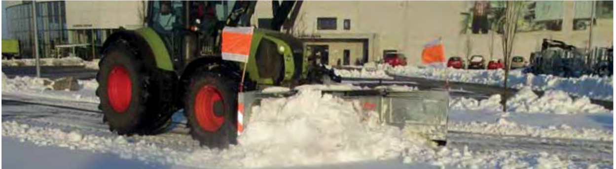
Die Räumbreite lässt sich durch die zwei Seitenflügel im vorgegebenen Bereich stufenlos einstellen.
