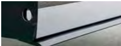
Schürfleiste aus hochfestem Verschleißstahl
