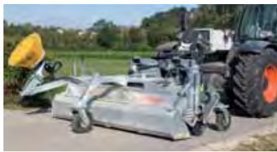
KEH Typ 500 mit Dreipunktaufnahme, hydraulische Schmutzsammelwanne, Seitenbesen und Frontstützrad
