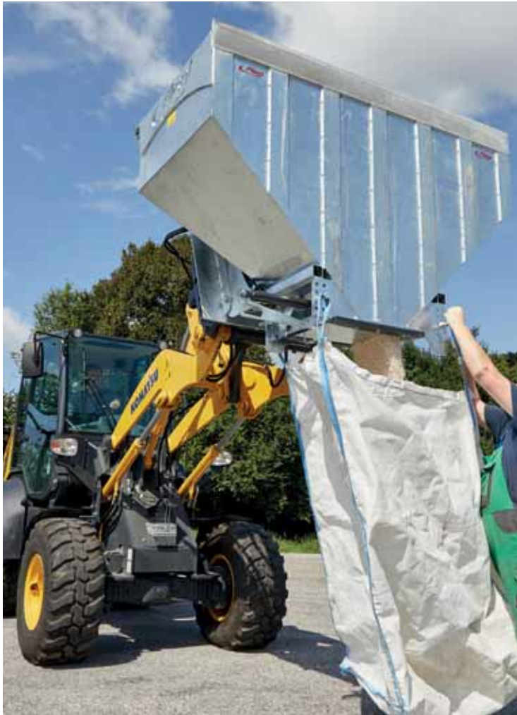
Abb. mit optionalem hydraulischen Schieber
