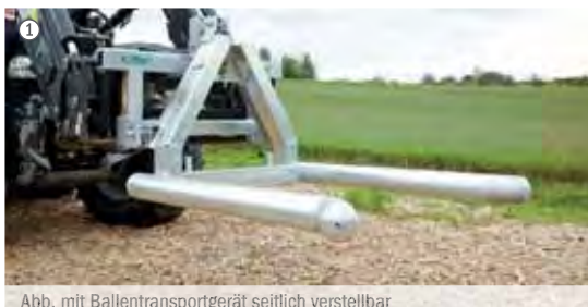
Abb. mit Ballentransportgerät seitlich verstellbar
