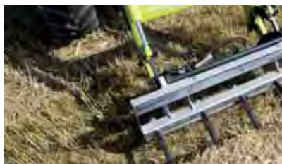
Führungsschiene mit verbauten Rundballenzinken
