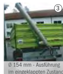
Über Drehgelenk einschiebbar am Fliegl-Kornschieber 400 x 300 mm
