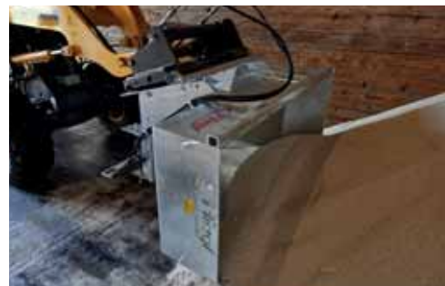
Abb. mit optionalem hydraulischen Schieber
