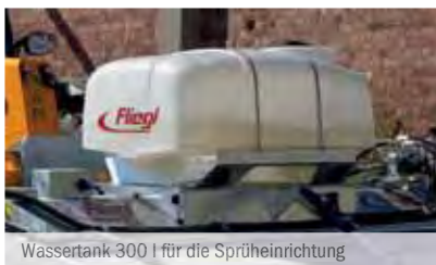
Wassertank 300 l für die Sprüheinrichtung
