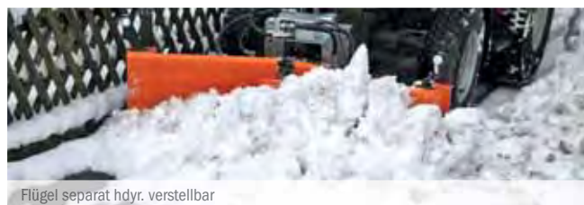
Flügel separat hydr. verstellbar
