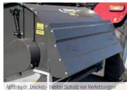
Abb. hydr. Deckel - bester Schutz vor Verletzungen
