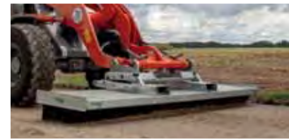
Aufnahme mit Rad- und Teleskoplader
