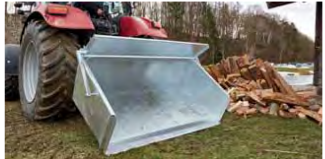
Mechanische Entleerung über Seilzug
