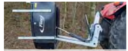
2-Zylinder-System für besten Kippwinkel 111°
