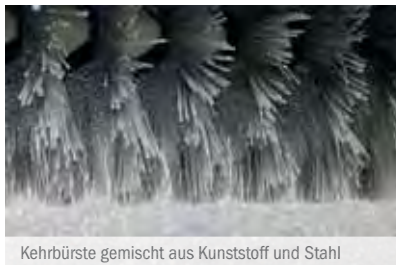
Kehrbürste gemischt aus Kunststoff und Stahl
