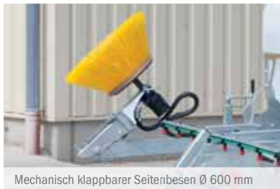
Mechanisch klappbarer Seitenbesen Ø 600 mm
