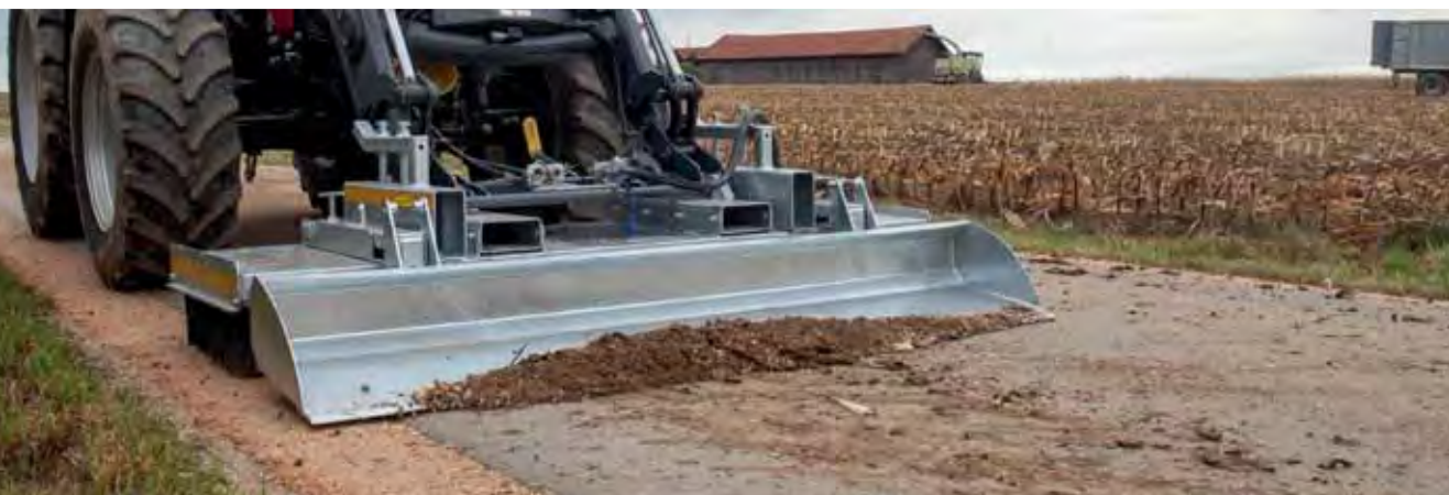
Abb. Mit Euronorm- und Schaufel Aufnahme sowie einer hydraulisch klappbaren Schmutzsammelwanne (optional erhältlich)
