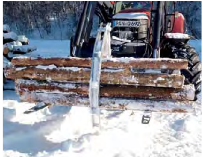
Hydraulischer Greifarm an der Staplergabel Freisicht befestigt
