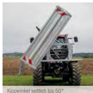
Kippwinkel seitlich bis 50°
