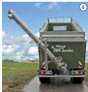
Ø 254 mm - Ausführung im eingeklappten Zustand
