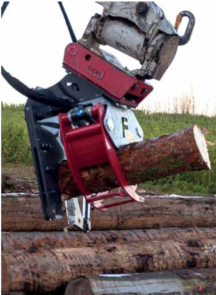
Schneiddurchmesser: bis 300 mm
