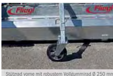
Stützrad vorne mit robustem Vollgummirad Ø 250 mm
