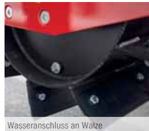
Wasseranschluss an Walze
