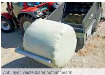
Abb. hydr. verstellbarer Aufnahmeanm
