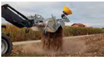
KEH Typ 500 mit Dreipunktaufnahme, hydraulische Schmutzsammelwanne, Seitenbesen und Frontstützrad
