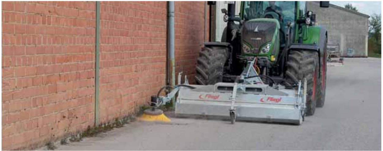
KEH Typ 500 mit Dreipunktaufnahme, hydraulische Schmutzsammelwanne, Seitenbesen und Frontstützrad
