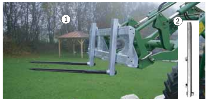
Verstellbare Aufnahme für Rundballenzinken (Schwerlastzinken; M28 x 1,5).
