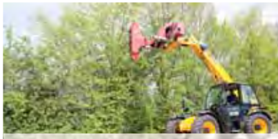
3-Blatt Astsäge am Teleskoplader mit JCB-Aufnahme
