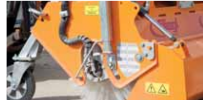
Stufenlose Kehrbesenverstellung durch Stützspindel
