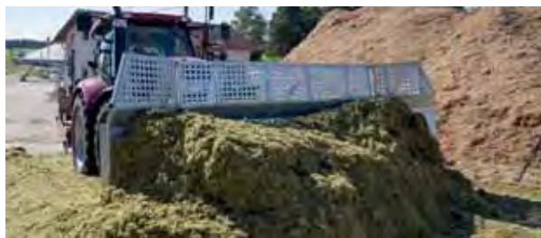
Aufbaugitter: Eine Erhöhung (400 mm) über die gesamte Arbeitsbreite des Planierschildes. Die Erhöhung wird einfach auf das Planierschild aufgeschraubt.
