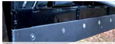
Geschraubte Schürfleiste, keine überstehende Schrauben
