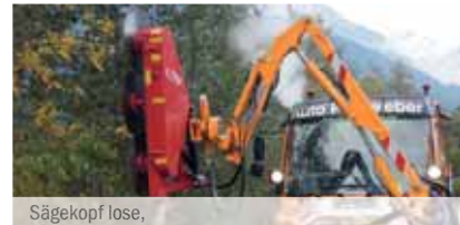
Sägekopf lose, auch für universellen Auslegearm erhältlich
