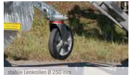
stabile Lenkrollen Ø 250 mm
