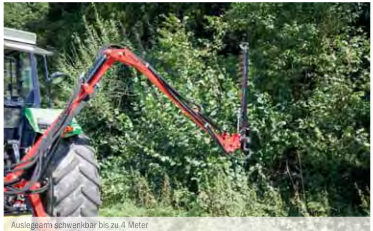
Auslegearm schwenkbar bis zu 4 Meter
