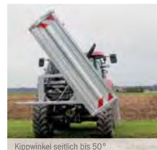
Kippwinkel seitlich bis 50°
