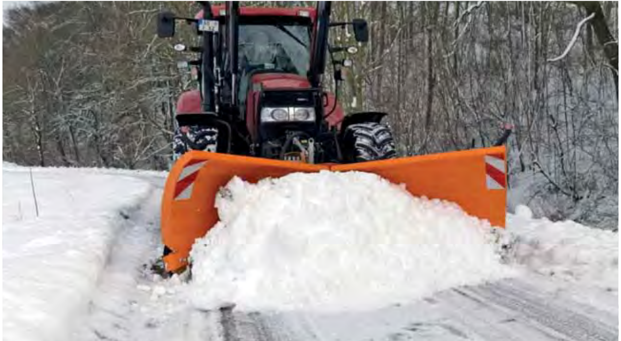
2 hydraulisch schwenkbare Flügel - diese lassen sich separat steuern, sodass individuelle Winkel-, Pflug- oder V-Stellungen gewählt werden können.
