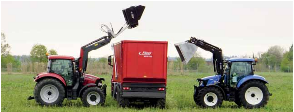
Darstellung der unterschiedlichen Kipphöhen bei gleichem Frontlader
