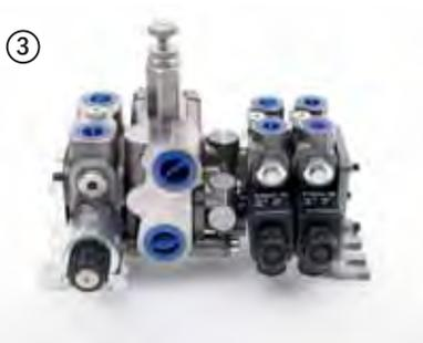
Le bloc de commande à capteur de pression intégré évite le blocage des lames de scie en cas de pression d'huile trop élevée. Ce bloc de commande permet de commander toutes les fonctions en même temps pendant le travail.
