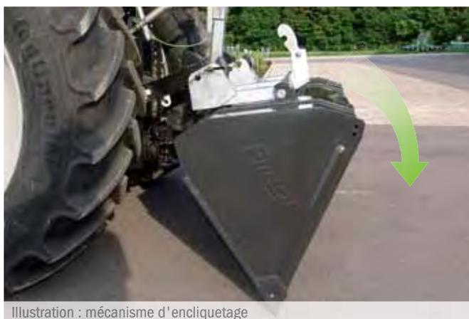
Illustration : mécanisme d'encliquetage
