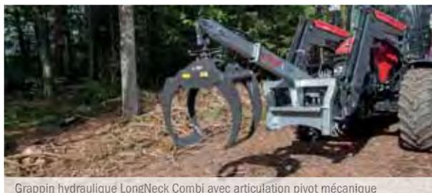
Grappin hydraulique LongNeck Combi avec articulation pivot mécanique
