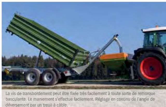
La vis de transbordement peut être fixée très facilement à toute sorte de remorque basculante. Le maniement s'effectue facilement. Réglage en continu de l'angle de déversement par un treuil à câble.
