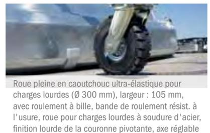
Roue pleine en caoutchouc ultra-élastique pour charges lourdes (Ø 300 mm), largeur : 105 mm, avec roulement à bille, bande de roulement résist. à l'usure, roue pour charges lourdes à soudure d'acier, finition lourde de la couronne pivotante, axe réglable
