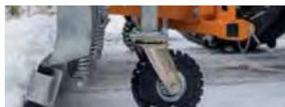
Roue pleine en caoutchouc ultra-élastique pour charges lourdes (Ø 306 mm), largeur : 105 mm, avec roulement à bille, bande de roulement résist. à l'usure, roue pour charges lourdes à soudure d'acier, finition lourde de la couronne pivotante, axe réglable
