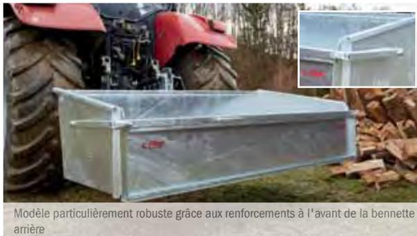
Modèle particulièrement robuste grâce aux renforcements à l'avant de la bennette arrière
