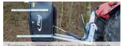
Système à 2 vérins pour un angle de basculement optimal de 111°
