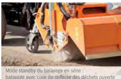
Mode standby du balayage en série : balayage avec cuve de collecte des déchets ouverte
