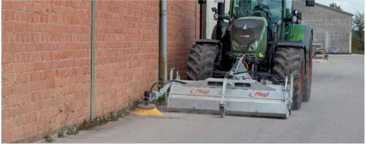
KEH Type 500 avec attelage trois points, cuve de collecte des déchets hydraulique, balai latéral et roue porteuse avant
