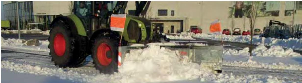
La largeur de déblayage peut être réglée en continu dans la zone définie à l'aide des deux panneaux latéraux.
