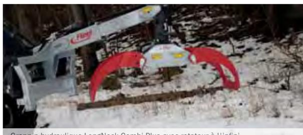
Grappin hydraulique LongNeck Combi Plus avec rotateur à l'infini
