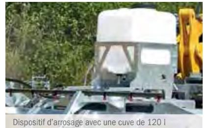
Dispositif d'arrosage avec une cuve de 120 l
