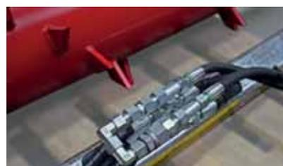
Guidage des tuyaux à l'intérieur, tubes de maintien robustes, donc protection optimale des tuyaux
