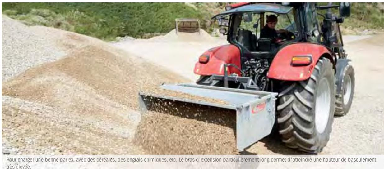
Pour charger une benne par ex. avec des céréales, des engrais chimiques, etc. Le bras d'extension particulièrement long permet d'atteindre une hauteur de basculement très élevée.
