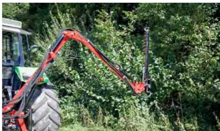
Bras d'extension pivotant jusqu'à 4 mètres
