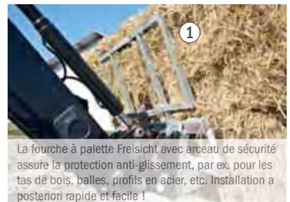
La fourche à palette Freisicht avec arceau de sécurité assure la protection anti-glissement, par ex. pour les tas de bois, balles, profils en acier, etc. Installation a posteriori rapide et facile !
