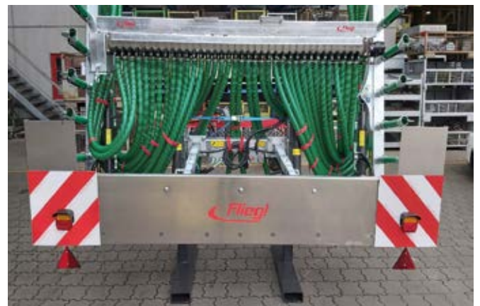
Schleppschuhdüsenchutz mit Beleuchtung und Warntafeln für Strassentransport, optional erhältlich
