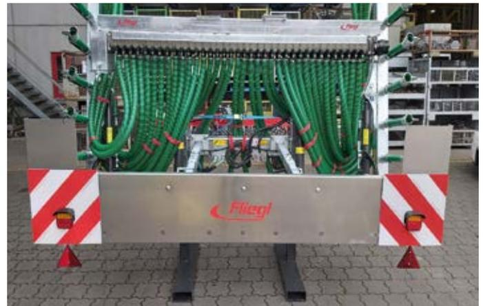
Protection des buses du répartisseur de pendillards avec éclairage et panneau de signalisation pour le transport routier, en option
