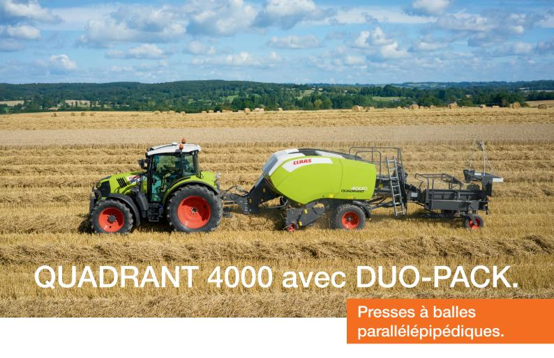
La QUADRANT 4000 a tous les arguments pour vous convaincre : un ramassage toujours homogène du fourrage, une compression maximale et des balles parallélépipédiques au liage à toute épreuve grâce aux noueurs hautes performances CLAAS. Le préfané, le foin et la paille sont pressés avec une forme de balle parfaite. La longueur de balle et la densité de pressage peuvent être adaptées aux besoins de l'utilisateur, le tout dans un format de 80 x 50 cm très facile à manipuler.
