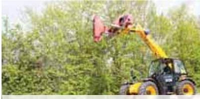
3-Blatt Astsäge am Teleskoplader mit JCB-Aufnahme
