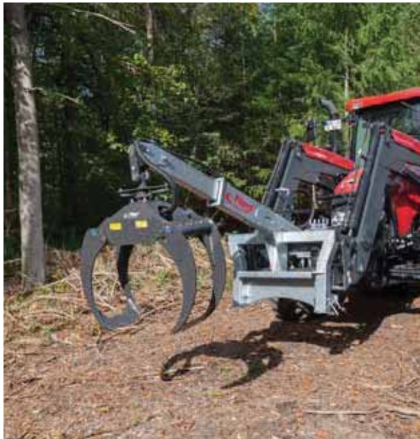
Hydraulische Rückezege LongNeck Combi mit mechanischem Drehgelenk
