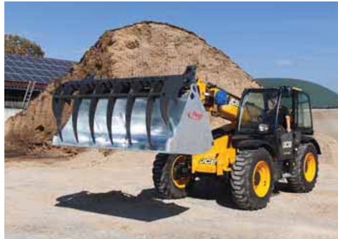
Greifzinken mit 20 mm Stärke, aus hochfestem Verschleißstahl (HB 500)
