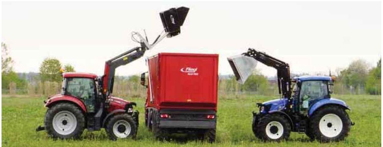
Darstellung der unterschiedlichen Kipphöhen bei gleichem Frontlader
