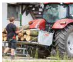
Ausklappbare Pendelwand dient als Muldenverlängerung
