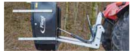
2-Zylinder-System für besten Kippwinkel 111°
