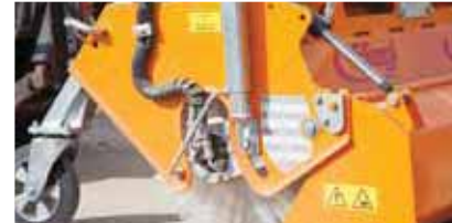
Stufenlose Kehrbesenverstellung durch Stützs spindle
