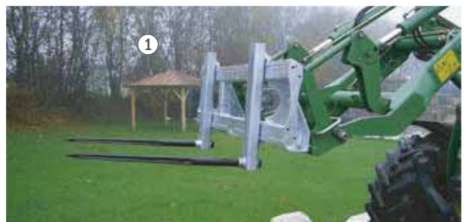
Verstellbare Aufnahme für Rundballenzinken (Schwerlastzinken; M28 x 1,5).
