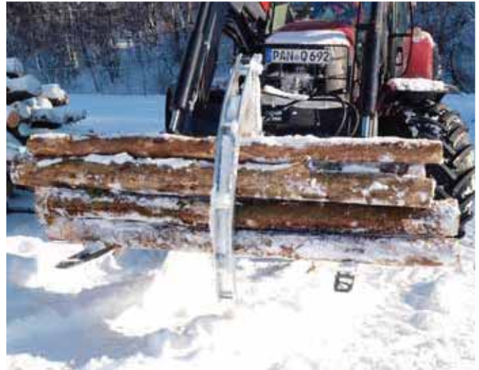
Hydraulischer Greifarm an der Staplergabel »Freisicht« befestigt
