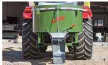
Abb. Auslaufrutsche schwenkbar
