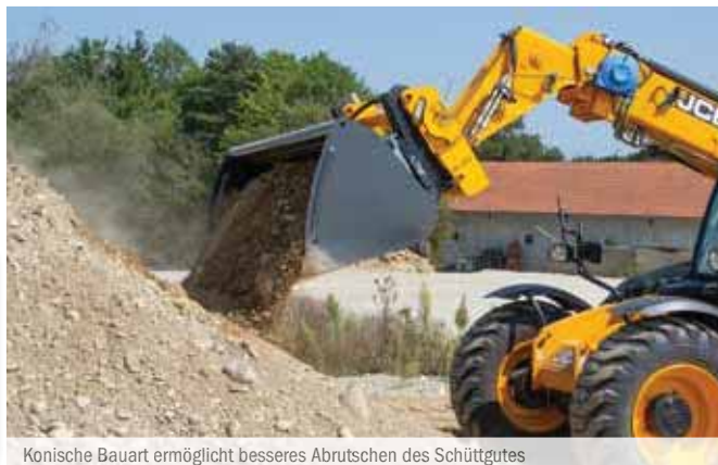
Konische Bauart ermöglicht besseres Abrutschen des Schüttgutes
