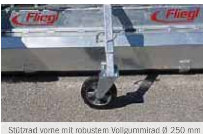
Stützrad vorne mit robustem Vollgummirad Ø 250 mm
