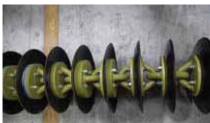
Verschleißfeste Stahlscheiben mit 130 mm Abstand
