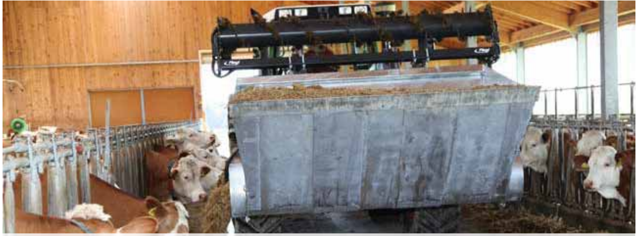
Abb. Einfüterschaufel mit Fräswalze (Fräswalze nicht im Lieferumfang enthalten)
