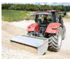
Abb. Pendelwand nach oben geklappt
