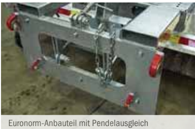
Euronorm-Anbauteil mit Pendelausgleich
