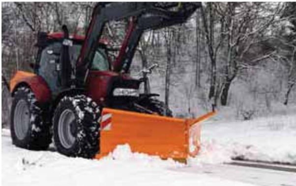
Abb. Verzinkt und zusätzlich Schutzlackiert für besten Rostschutz
