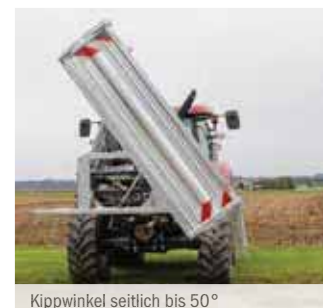
Kippwinkel seitlich bis 50°
