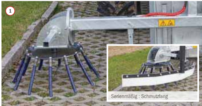
Beste Wildkrautentfernung durch ummantelte Stahlbürsten
