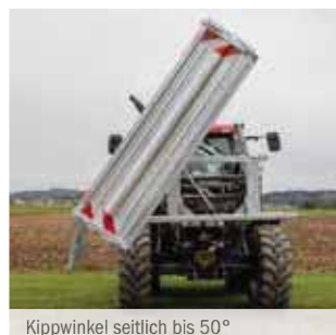
Kippwinkel seitlich bis 50°
