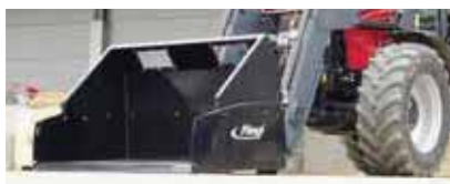
Aufbau mit Sichtausschnitt für maximales Volumen
