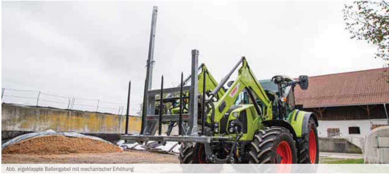
Abb. eigeklappte Ballengabel mit mechanischer Erhöhung
