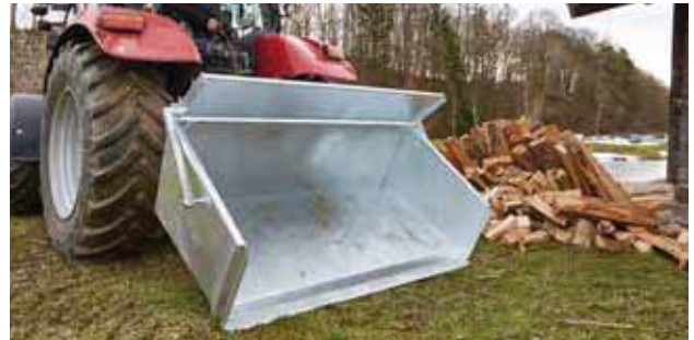
Mechanische Entleerung über Seilzug
