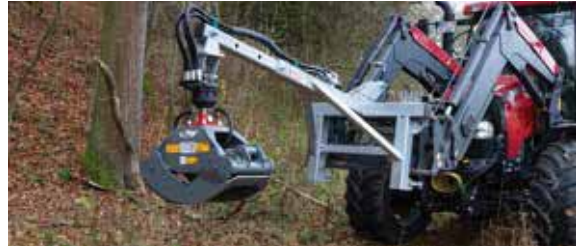
Abb. Verladezange mit Lashakenverlängerung (Euro-Dreipunktaufnahme) und Drehmotor
