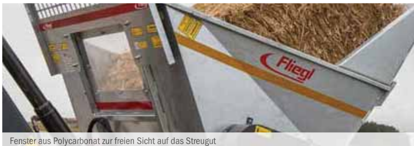
Fenster aus Polycarbonat zur freien Sicht auf das Streugut
