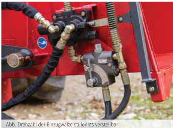
Abb. Drehzahl der Einzugswalze stufenlos verstellbar
