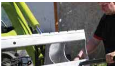
Einfachste Umrüstung bei Verwendung von Rundballenzinken durch vorhandene Konusbuchsen (verschraubbar).
