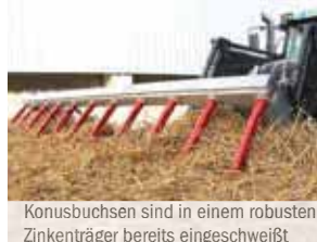
Hochfeste, robuste Schürfleiste schont den Schaufelunterbau
