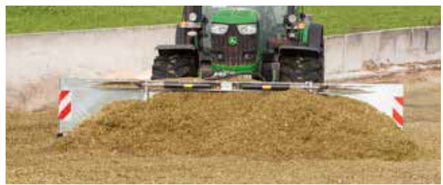
Die Räumbreite lässt sich durch die zwei Seitenflügel im vorgegebenen Bereich stufenlos einstellen. Optimal mit Warnflaggen.
