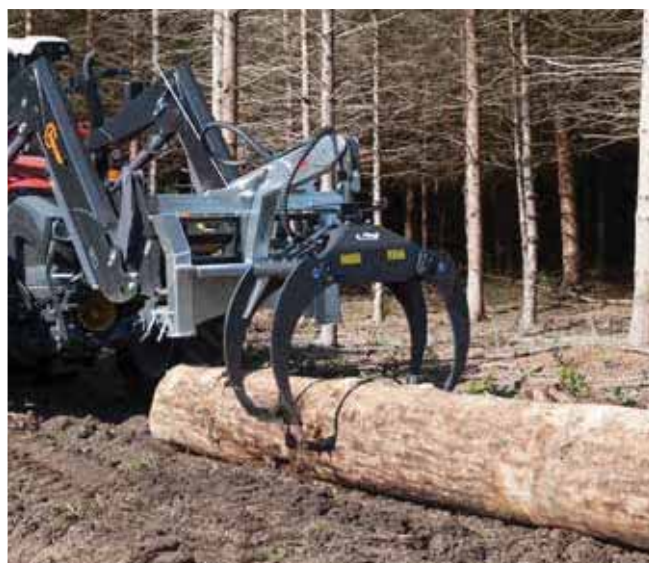
Hydr. Rückezege Combi RZ 185 mit mechanischem Drehgelenk
