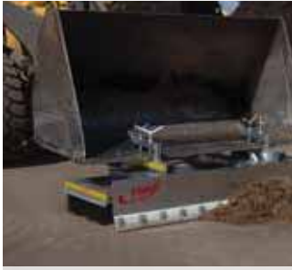
Kehrbesen Löwe mit Planierschild – räumt selbst festgefahrene Verschmutzungen
