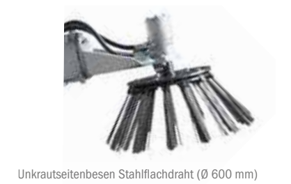
Unkrautseitenbesen Stahlflachdraht (Ø 600 mm)
