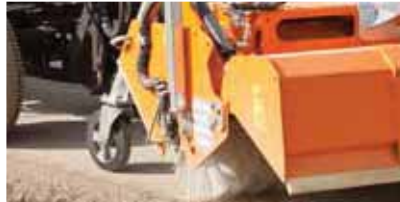
Serienmäßig mit Freikehrmodus: Kehren mit geöffneter Schmutzsammelwanne
