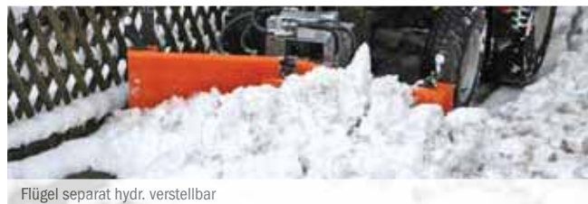
Flügel separat hydr. verstellbar
