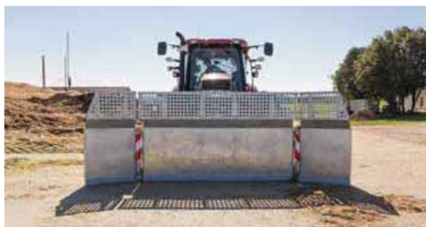
Illustration avec grillage supplémentaire 400 mm
