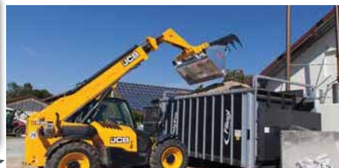
Broches de préhension de 20 mm d'épaisseur, en acier très résistant à l'usure (HB 500)
