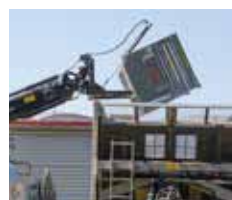
Angle de basculement jusqu'à 71° env. !
