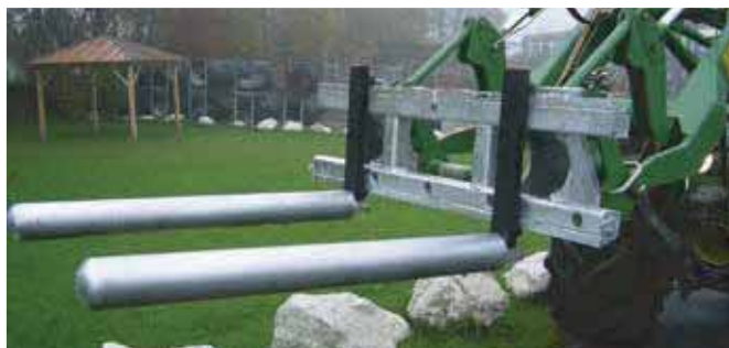
Tubes à emboîter pour le transport de balles rondes
