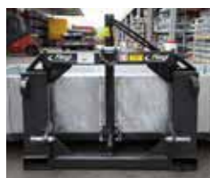
Systèmes d'attelage possibles : attelage aux normes européennes, trois points ou sur chariot élévateur
