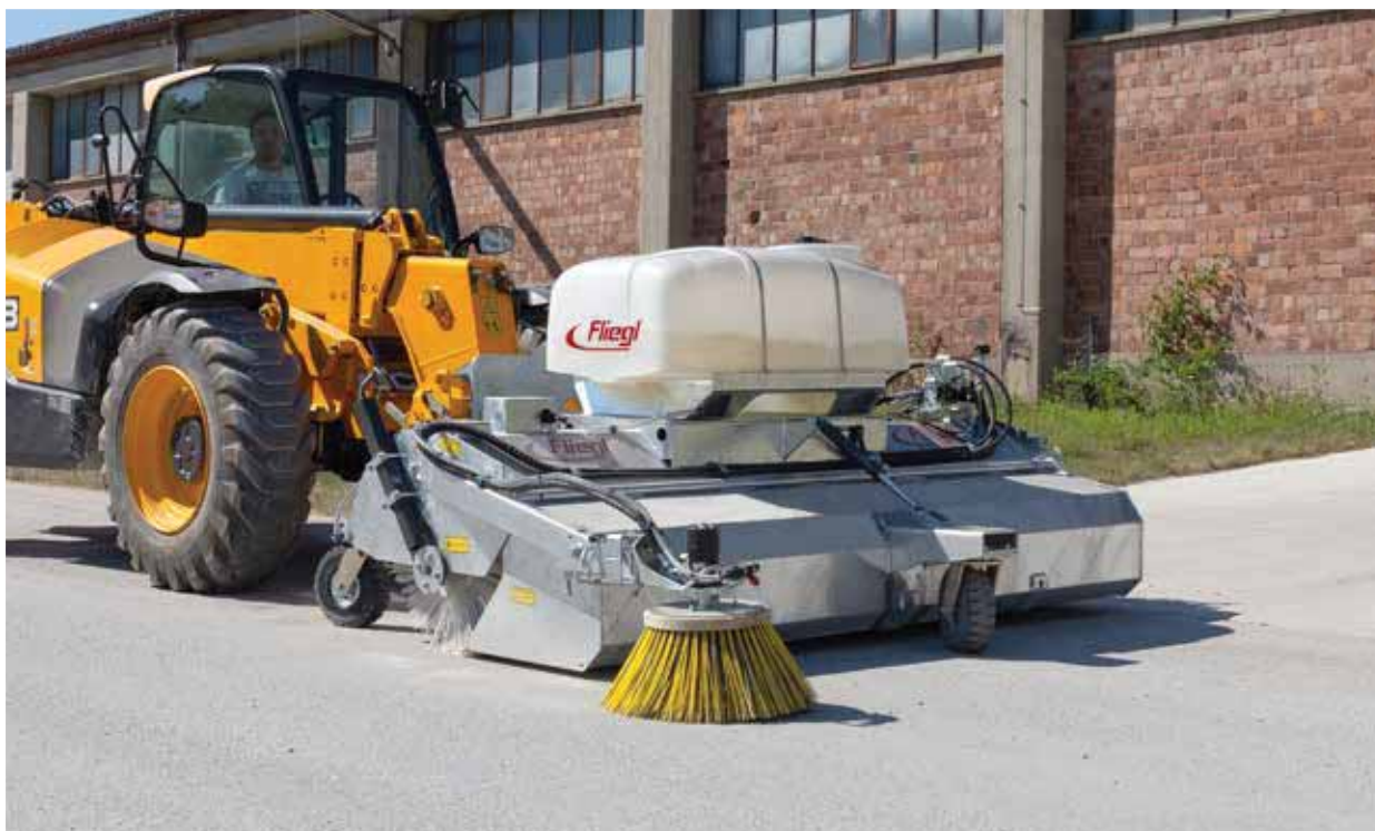
Balai réglable en continu, utilisable jusqu'à usure complète
