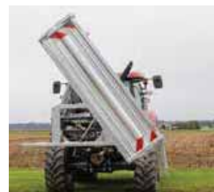
Angle de basculement latéral jusqu'à 50°
