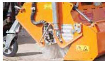
Réglage en continu du balai avec un axe de support
