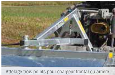
Attelage trois points pour chargeur frontal ou arrière
