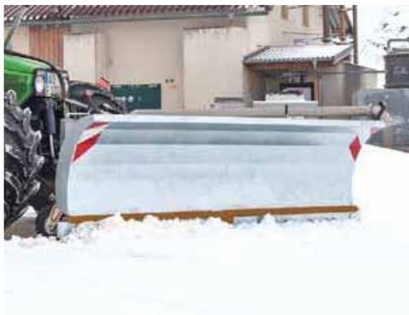
« Mammuth Mono » galvanisée, hauteur de la lame : 955 mm env.
