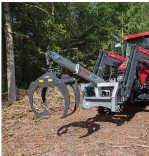
Grappin hydraulique LongNeck Combi avec articulation pivot mécanique
