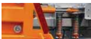
Limiteur de charge par clapets à ressorts garantissant une conduite sans dommages
