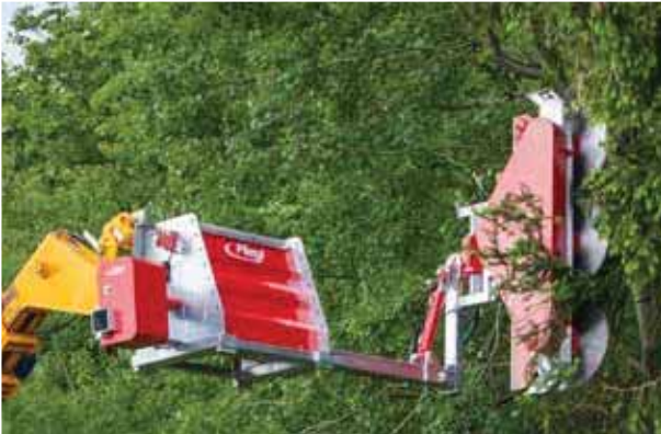
Illustration : utilisation sur chargeur télescopique avec fixation à gauche
