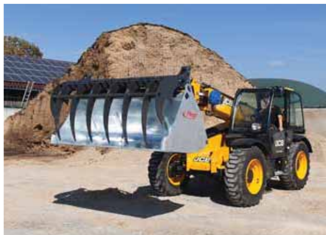
Broches de préhension de 20 mm d'épaisseur, en acier très résistant à l'usure (HB 500)
