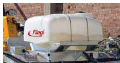
Réservoir d'eau 300 l pour le dispositif d'arrosage
