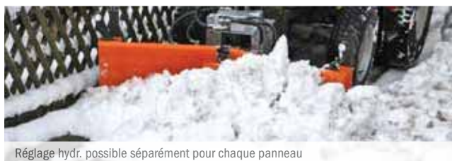
Réglage hydr. possible séparément pour chaque panneau
