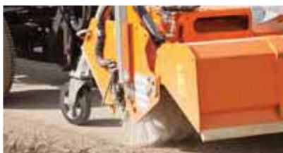
Mode standby du balayage en série : balayage avec cuve de collecte des déchets ouverte
