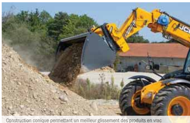
Construction conique permettant un meilleur glissement des produits en vrac
