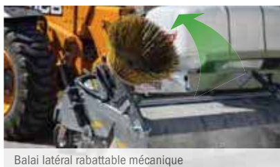
Balai latéral rabattable mécanique
