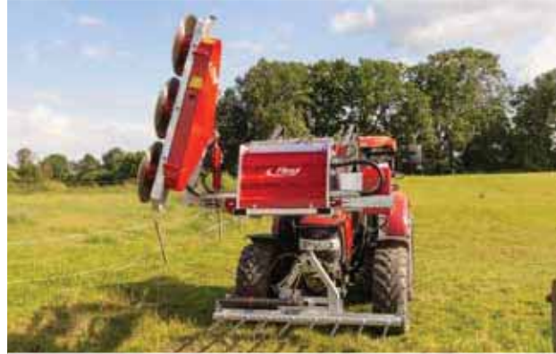
Illustration : utilisation sur tracteur avec fixation à droite
