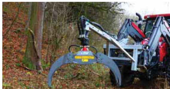
Illustration : pince de transbordement avec rallonge pour crochet de suspension (attelage trois points aux normes européennes) et moteur coupleur
