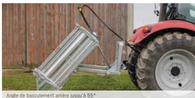
Angle de basculement arrière jusqu'à 55°
