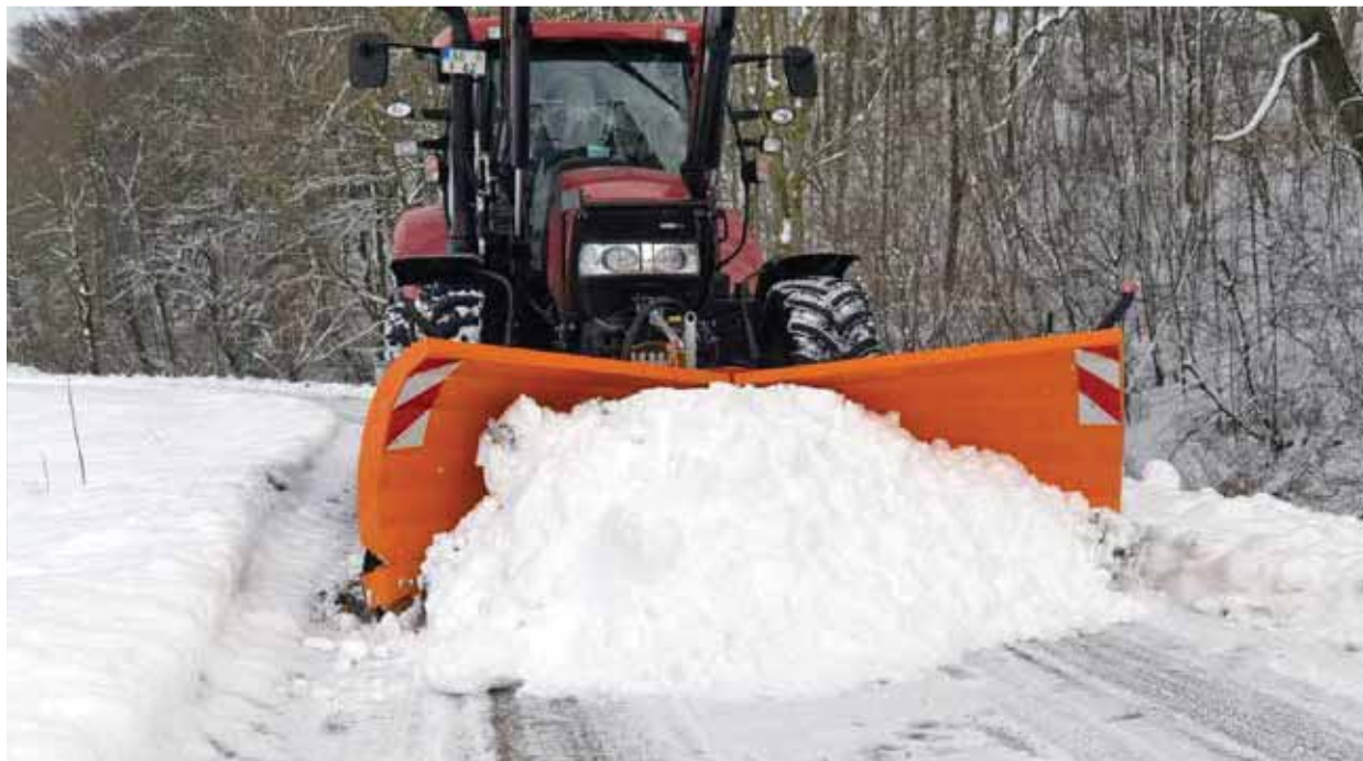
2 panneaux à inclinaison hydraulique - peuvent être commandés séparément pour choisir des positions individuelles en équerre, en chasse-neige ou en V.
