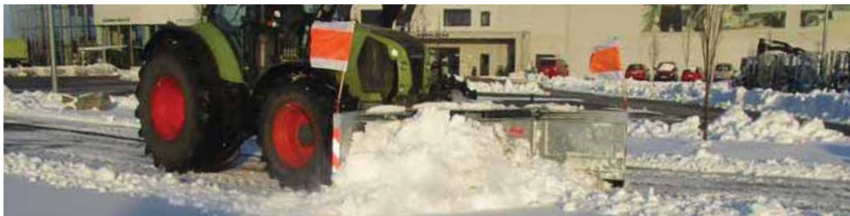
La largeur de déblayage peut être réglée en continu dans la zone définie à l'aide des deux panneaux latéraux. Utilisation optimale avec drapeaux de signalisation.
