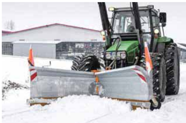
2 panneaux à inclinaison hydraulique - peuvent être commandés séparément pour choisir des positions individuelles en équerre, en chasse-neige ou en V.
