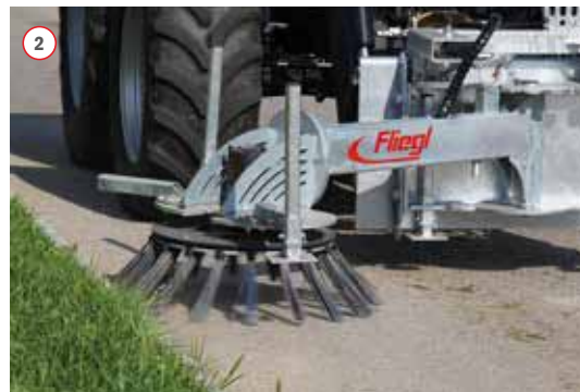
Meilleure élimination des mauvaises herbes grâce aux brosses d'acier gainées
