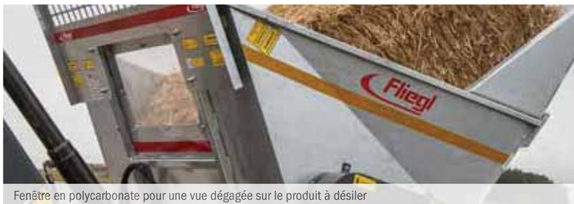
Fenêtre en polycarbonate pour une vue dégagée sur le produit à désiler
