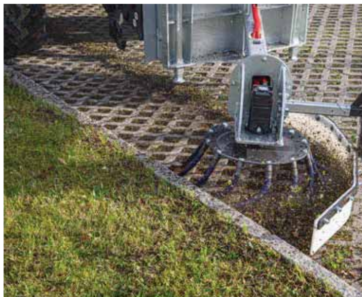
Meilleure élimination des mauvaises herbes grâce aux brosses d'acier gainées
