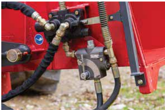
Illustration : vitesse de rotation du rouleau d'entraînement réglable en continu
