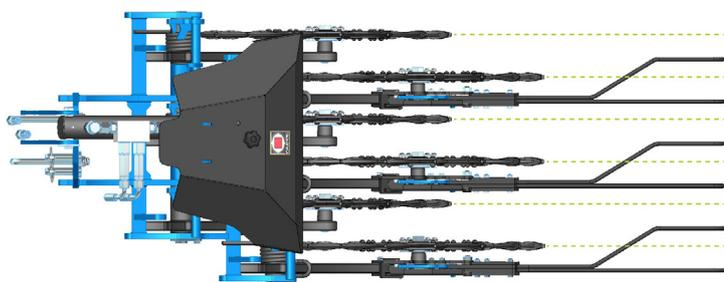
Les dents travaillent entre les roues de hachage en étoile. La fixation sur le bras de la roue bineuse en étoile permet une adaptation optimale au sol.
