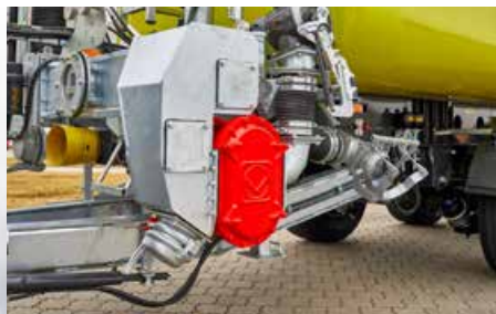
Facilité de maintenance: Entraînement mécanique Pompe à lobes incl. boîtier de réduction
