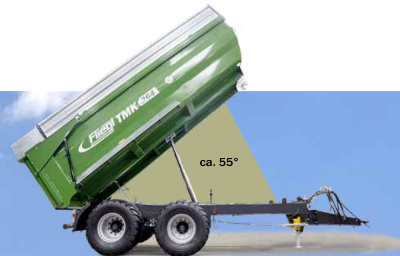
La benne tandem TMK 269 Profi avec une longueur de benne de 6.90 m et un angle de basculement d'environ 55°
