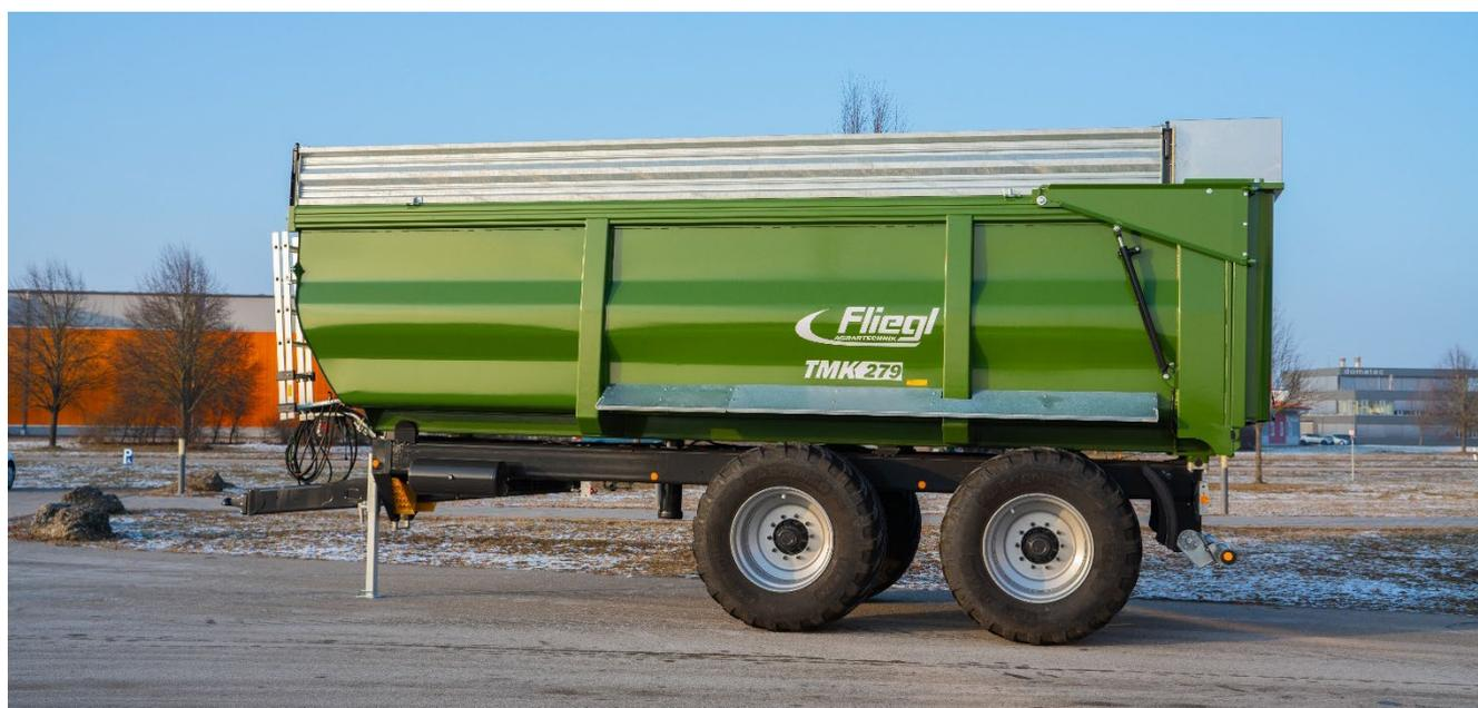
Mit einem Volumen von ca. 31 m<sup>3</sup> ohne Aufbau und beeindruckenden 40 m<sup>3</sup> mit einem 500 mm Aufbau bietet der Muldenkipper TMK 279 eine hohe Flexibilität beim Transport von unterschiedlichen Materialien. Die Möglichkeit zur Erweiterung des Volumens macht ihn zu einem vielseitigen Begleiter für die Landwirtschaft.
