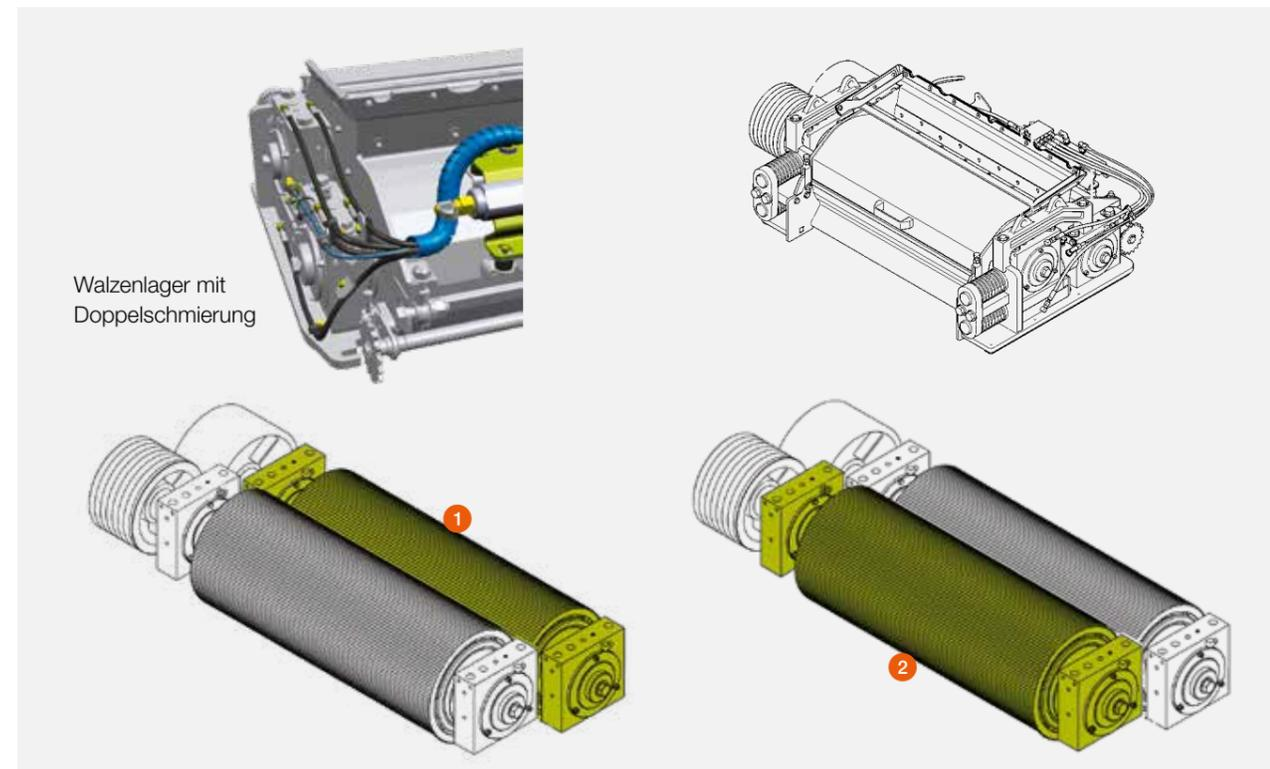
Walzenlager mit Doppelschmierung
