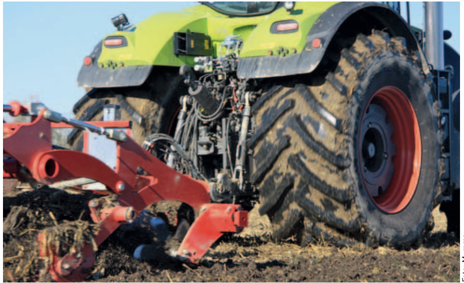
11 t Hubkraft im Heck sind stattlich. Dafür ist die serienmäßige Hydraulikleistung eher mager. Für 1.061 Euro Aufpreis gibt es statt der 150 l/min auch 220 l/min – dann passt's.
