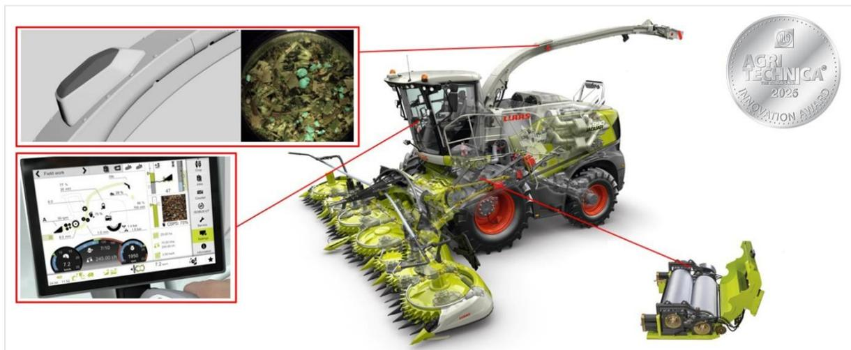
*CEMOS AUTO CHOPPING für den JAGUAR 900 als Assistenzsystem für die automatische Steuerung der Kornaufbereitung (CSPS Wert) auf Basis einer KI-gestützten Häckselgutanalyse erhält ebenfalls eine Silbermedaille der DLG Neuheitenkommission.*
