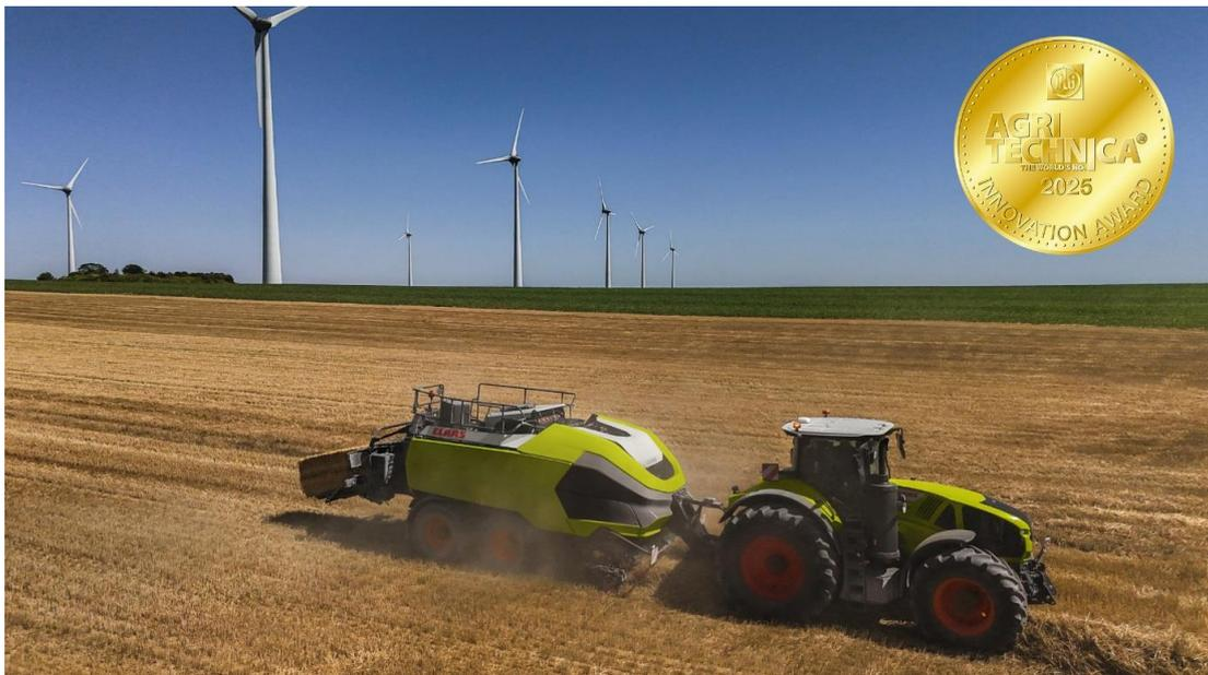
*70 Tonnen Durchsatz pro Stunde bei konstant hohen Pressdichten bis 235 kg/m<sup>3</sup> in Stroh, ermöglicht durch ein neuartiges Antriebskonzept, KI-unterstützte Pressdichteregulierung, einen neuen Vorkammerraffer und einen neuen Doppelschlaufenknoter – dafür verlieh die Neuheitenkommission der DLG der Quaderballenpresse nächster Generation einen Agritechnica Innovation Award in Gold.*
