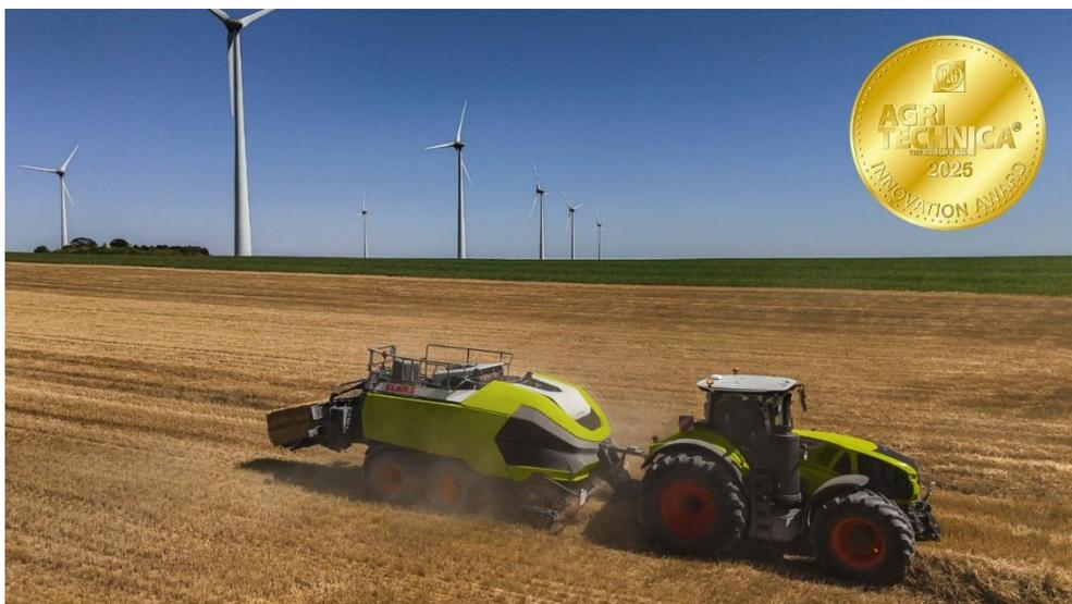
*70 tonnes par heure avec des densités constantes allant jusqu'à 235 kg/m<sup>3</sup> dans la paille – grâce à un concept d'entraînement novateur, un réglage de densité assisté par IA, un ameneur de préchambre et un noueur à double boucle – valent à la presse de nouvelle génération une médaille d'or de la commission des nouveautés de la DLG.*
