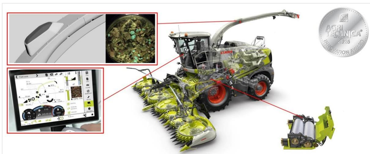
*CEMOS AUTO CHOPPING pour le JAGUAR 900, comme système d'assistance pour le contrôle automatique du traitement des grains (valeur CSPS) basé sur une analyse fourragère assistée par IA, reçoit également une médaille d'argent de la DLG.*
