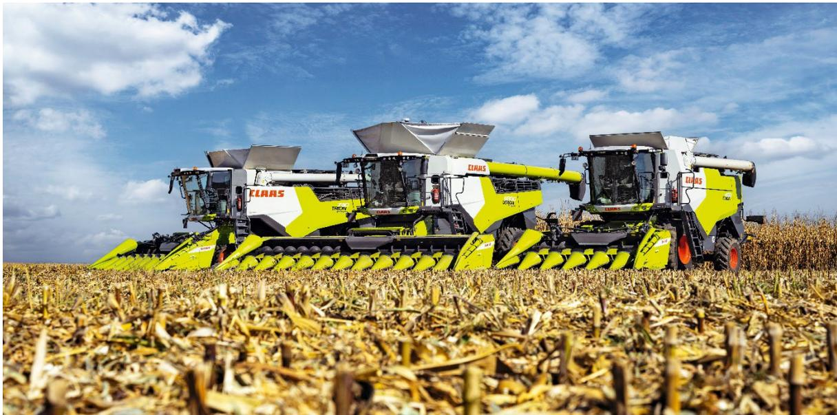
*Die ROVIO 4 Baureihe umfasst insgesamt acht Ausführungen mit 6, 8 und 12 Reihen sowie 70, 75 und 80 cm Reihenabstand.*
