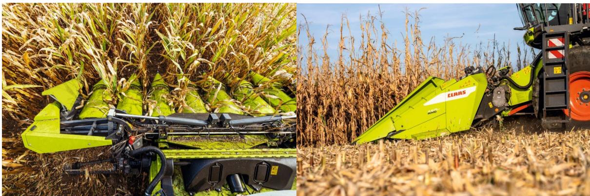
*AUTO CONTOUR und AUTO PILOT entlasten den Fahrer, die Horizontalhäcksler arbeiten dank Neupositionierung noch effektiver.*
