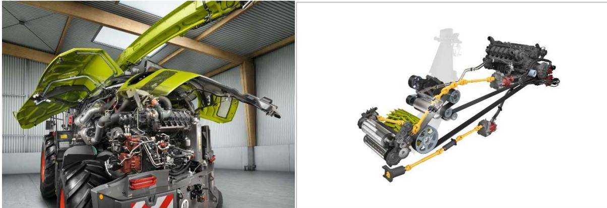
*Les modèles JAGUAR 1080, 1090, 1100 et 1200 sont entraînés par un moteur V12 économique et performant de marque MAN implanté transversalement, de 24 l de cylindrée. Le tout nouveau système d'entraînement est intégré dans l'architecture générale de la machine pour occuper le moins d'espace possible et conférer aux modèles JAGUAR série 1000 une largeur hors tout identique à celle des JAGUAR 800 et 900 ainsi qu'une excellente visibilité vers l'arrière.*
