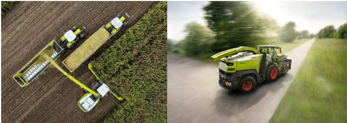
*La configuration de la goulotte d'éjection peut être adaptée de manière optimale à tous les modèles de PICK UP et de bec ORBIS, quelle que soit leur largeur de travail. Pour les récoltes avec le nouveau bec ORBIS 10500 et une goulotte de longueur maximale, l'extrémité peut être rabattue par commande hydraulique pour garantir la sécurité lors des déplacements sur route.*
