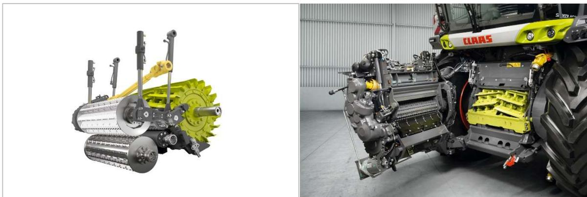
*Grâce à leur nouveau système de commande tout hydraulique, les rouleaux de précompression garantissent un flux de récolte homogène quel que soit le volume de produit. Le module de précompression peut être pivoté de 80° pour faciliter les travaux d'entretien.*
