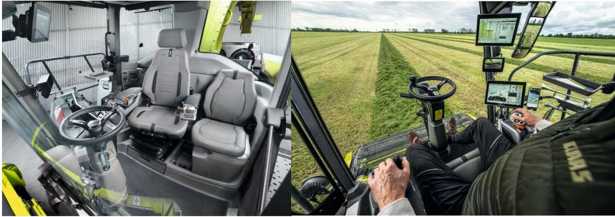
*La nouvelle cabine redéfinit la donne en termes de visibilité panoramique et d'insonorisation. Pour la première fois sur des machines de récolte CLAAS, les ensileuses peuvent être équipées d'une direction par joystick avec deux modes de conduite et des degrés d'intensité réglables.*
