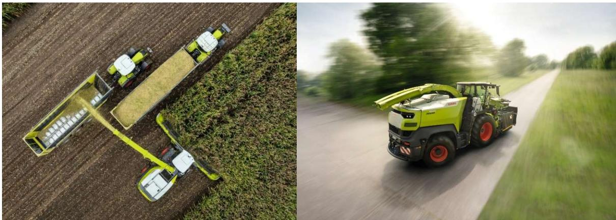
*Der Auswurfkrümmer kann für alle PICK UP und ORBIS Arbeitsbreiten optimal angepasst werden. Für die Ernte mit dem neuen ORBIS 10500 mit maximaler Krümmerlänge ist das Endstück für den sicheren Straßentransport hydraulisch klappbar.*
