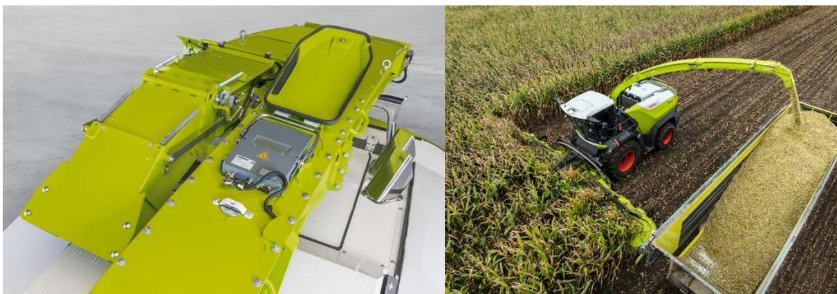
*Mit dem JAGUAR 1000 führt CLAAS das neue NUTRIMETER für die Echtzeit-Bestimmung von TS-Gehalt sowie Inhaltsstoffen und teilflächengenaue Ertragserfassung und Ertragskartierung ein.*
