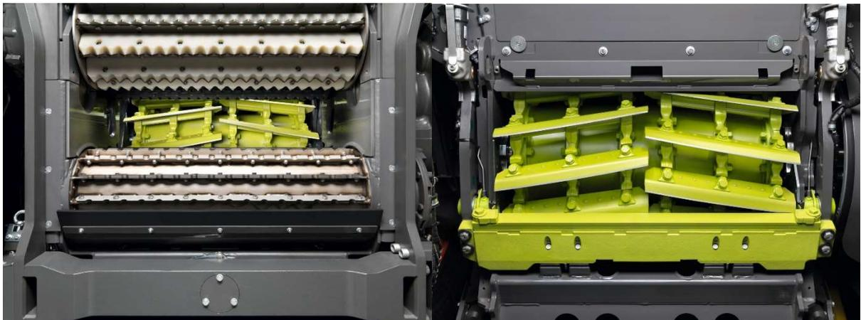
*Mit 910 mm Breite steht die V-FLEX Messertrommel für höchsten sowie kontinuierlichen und verstopfungsfreien Gutfluss auch bei höchsten Schwadstärken und schwierigen Erntebedingungen.*
