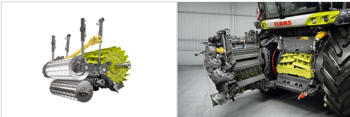
*Die Vorpresswalzen gewährleisten durch die neue, vollhydraulische Vorpressung einen gleichmäßigen sowie schichtdickenunabhängigen Gutfluss. Für Wartungsarbeiten lässt sich das Vorpressaggregat um 80 Grad aufschwenken.*
