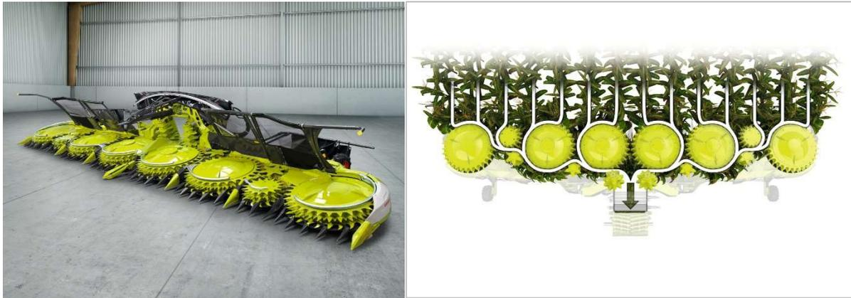
*ORBIS 9000 und 10500 wurden speziell für den JAGUAR 1000 entwickelt. Der unabhängige variable Antrieb der Messer- und Transportscheiben sowie der Einspeisetrommeln erlaubt eine optimale Anpassung an die Erntebedingungen.*
