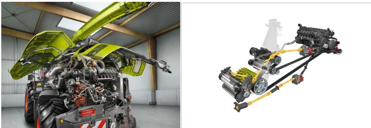
*JAGUAR 1080, 1090, 1100 und 1200 werden von einem effizienten, quer eingebautem MAN V12 mit 24 l Hubraum angetrieben. Das innovative Antriebskonzept für die Antriebe wurde platzsparend in das Gesamtkonzept integriert, wodurch eine identische Außenbreite wie JAGUAR 800 und 900 erreicht und eine hervorragende Sicht nach hinten ermöglicht wird.*
