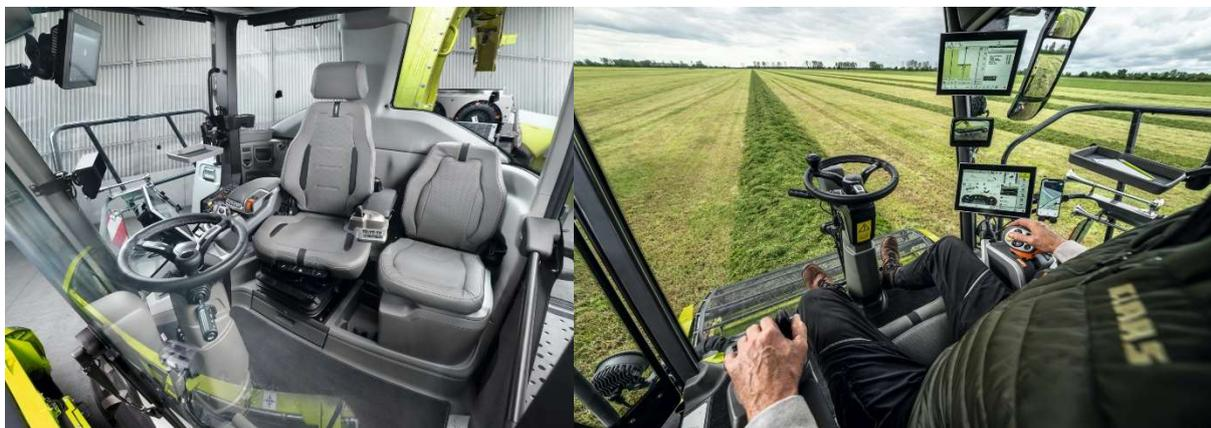
*Die neue Kabine setzt Maßstäbe bei Rundumsicht und Geräuschlevel. Erstmals bei CLAAS Erntemaschinen ist eine Joystick-Lenkung mit zwei Lenkmodi und einstellbaren Intensitätsstufen verfügbar.*
