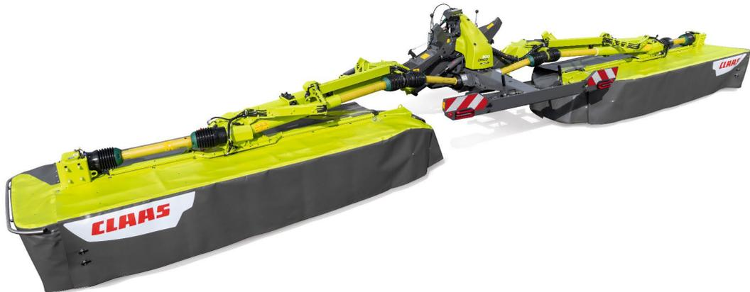
*In einigen Ländern ergänzt das neue DISCO 1100 COMFORT mit 10,90 m Arbeitsbreite das DISCO Programm.*
