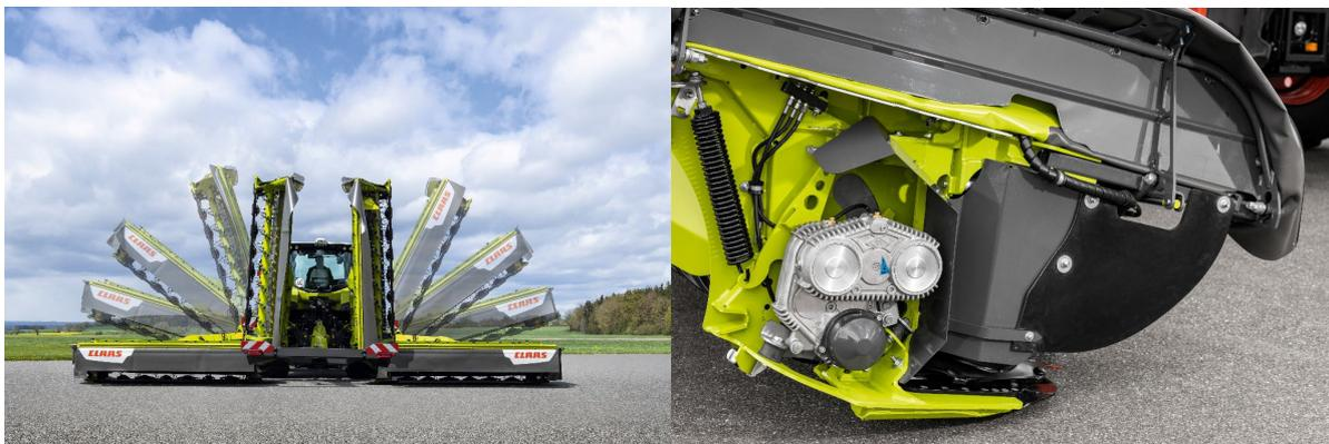
*Das neue DISCO 9300 C / RC COMFORT bietet einen hohen Bedienerkomfort speziell in Hinblick auf Hydraulikfunktionen. Die RC Variante ist optional mit dem innovativen doppelten Walzenantrieb mit Scherengetriebe erhältlich.*
