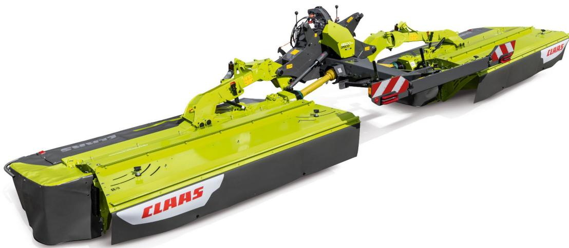
*La nouvelle DISCO 8500 C TREND a été spécialement développée pour les tracteurs de la catégorie moyenne inférieure et optimisée à ce titre au niveau de l'entraînement et du centre de gravité.*
