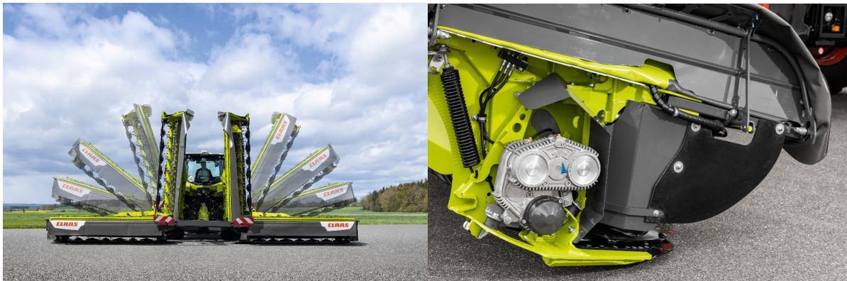
*La nouvelle DISCO 9300 C / RC COMFORT offre un grand confort d'utilisation, notamment en matière de fonctions hydrauliques. La variante RC est disponible en option avec le double entraînement innovant des rouleaux avec engrenage à ciseaux.*
