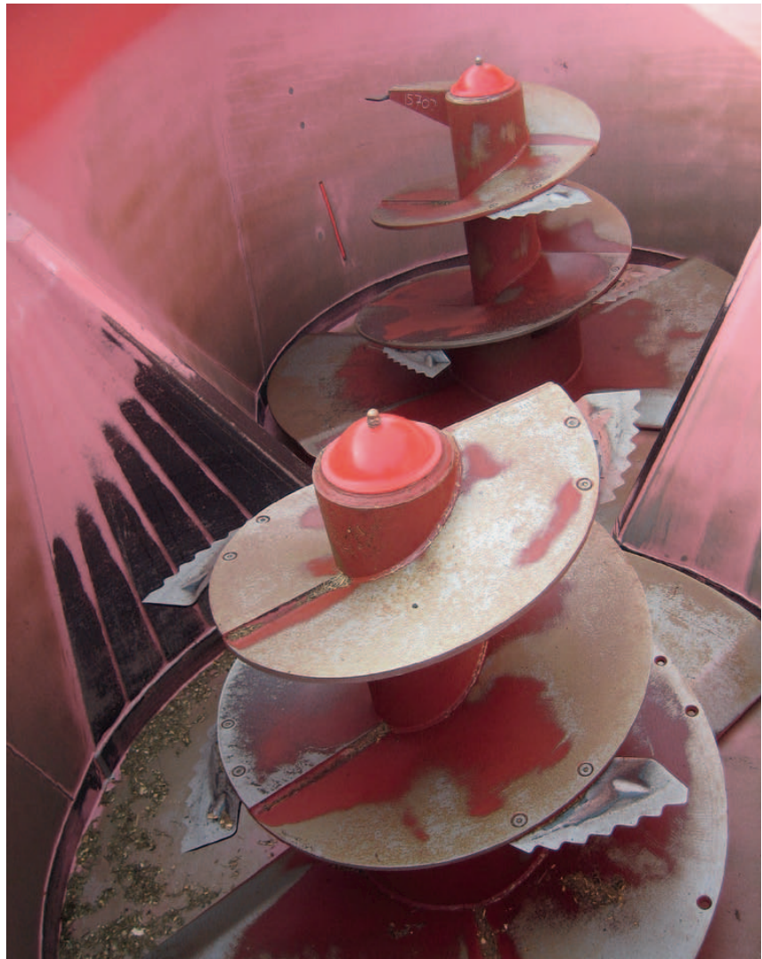
Bild 3: Die senkrechten Mischschnecken des Trioliet Futtermischwagen Solomix 2-2000 VLH-B
