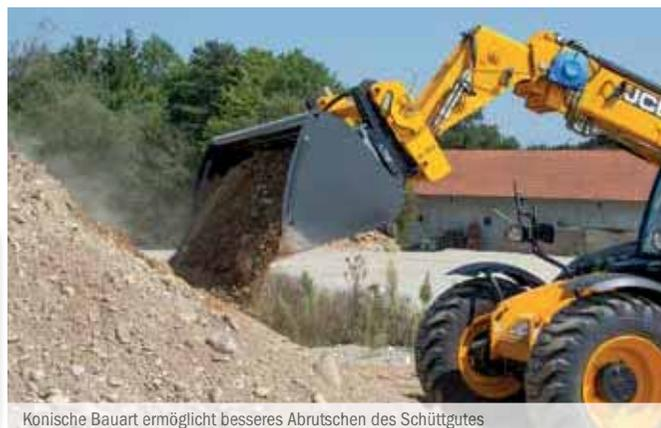
Konische Bauart ermöglicht besseres Abrutschen des Schüttgutes
