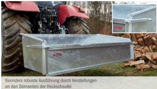
Beonders robuste Ausführung durch Versteifungen an den Stirnseiten der Heckschaufel
