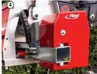
Seitliches Kontergewicht - dadurch minimale Belastung der Schwinde des Trägerfahrzeugs.
