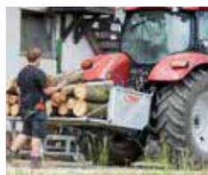
Ausklappbare Pendelwand dient als Muldenverlängerung
