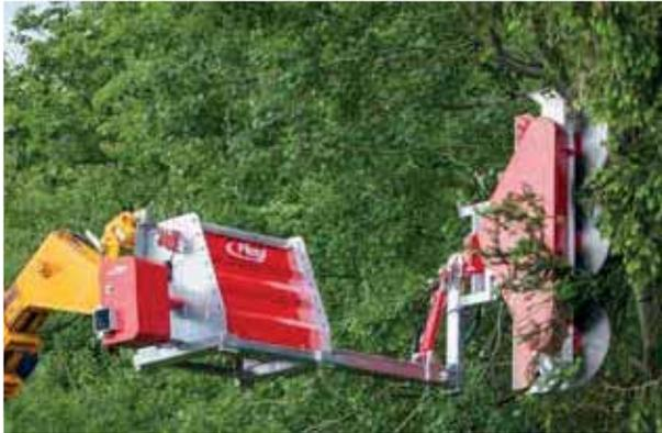
Abb.: Verwendung bei Teleskoplader mit Linksanbau
