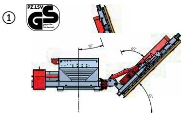
GS-Zertifizierung: Neigevorrichtung 45° - Das geprüfte Baumuster entspricht den im Produktsicherheitsgesetz (ProdSG) genannten Anforderungen sowie dem derzeitigen Erfahrungsstand der Unfallverhütung.
