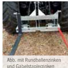
Abb. mit Rundballenzinken und Gabelstaplerzinken
