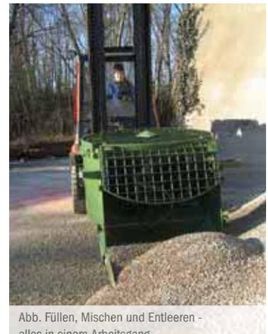
Abb. Füllen, Mischen und Entleeren - alles in einem Arbeitsgang
