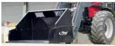
Aufbau mit Sichtausschnitt für maximales Volumen
