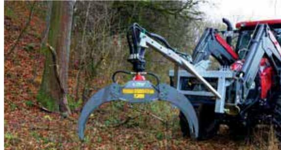
Abb. Verladezange mit Lashakenverlängerung (Euro-Dreipunktaufnahme) und Drehmotor
