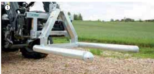
Abb. mit Ballentransportgerät seitlich verstellbar
