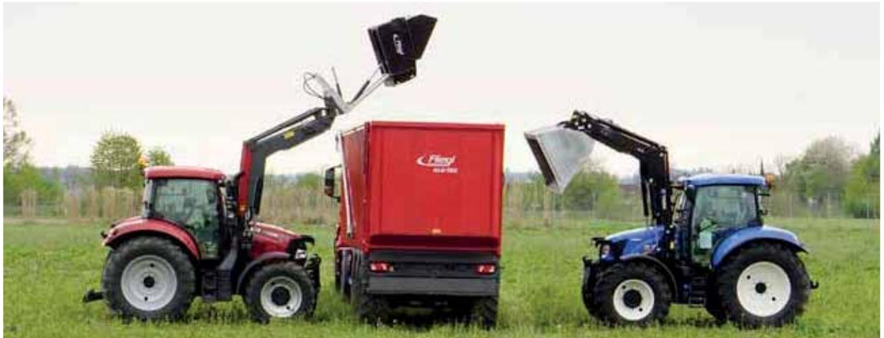
Darstellung der unterschiedlichen Kipphöhen bei gleichem Frontlader
