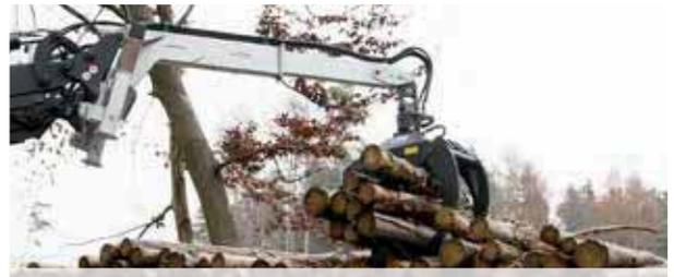
Hydraulische Rückezege LongNeck Combi Plus mit Endlosdrehmotor
