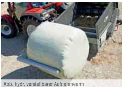
Abb. hydr. verstellbarer Aufnahmearm
