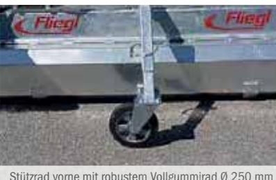
Stützrad vorne mit robustem Vollgummireifen Ø 250 mm
