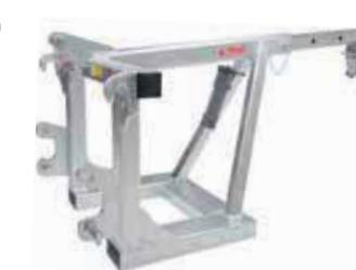
Abb. zeigt Euronorm- und Dreipunktaufnahme, Stapleraufnahme
