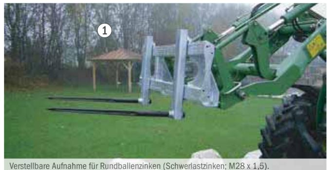
Verstellbare Aufnahme für Rundballenzinken (Schwerlastzinken; M28 x 1,5).
