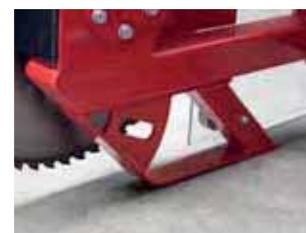
Ein Schutzbügel verhindert eine Berührung des untersten Sägeblattes mit dem Erdreich.
