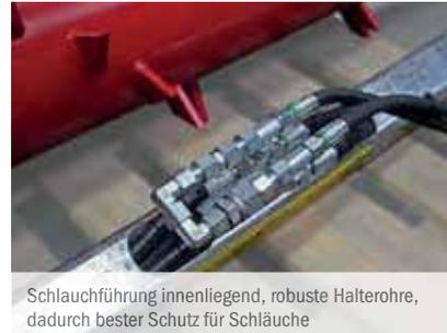
Schlauchführung innenliegend, robuste Halterohre, dadurch bester Schutz für Schläuche
