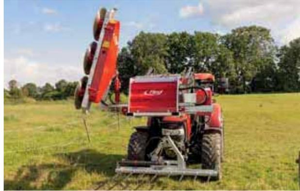
Abb.: Verwendung bei Schlepper mit Rechtsanbau
