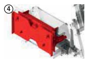
Überlastsicherung als Dämpfadapter: Bei zu hohem Anpressdruck neigt sich der Kopf nach hinten zum Schutz vor Blockieren der Sägeblätter.
