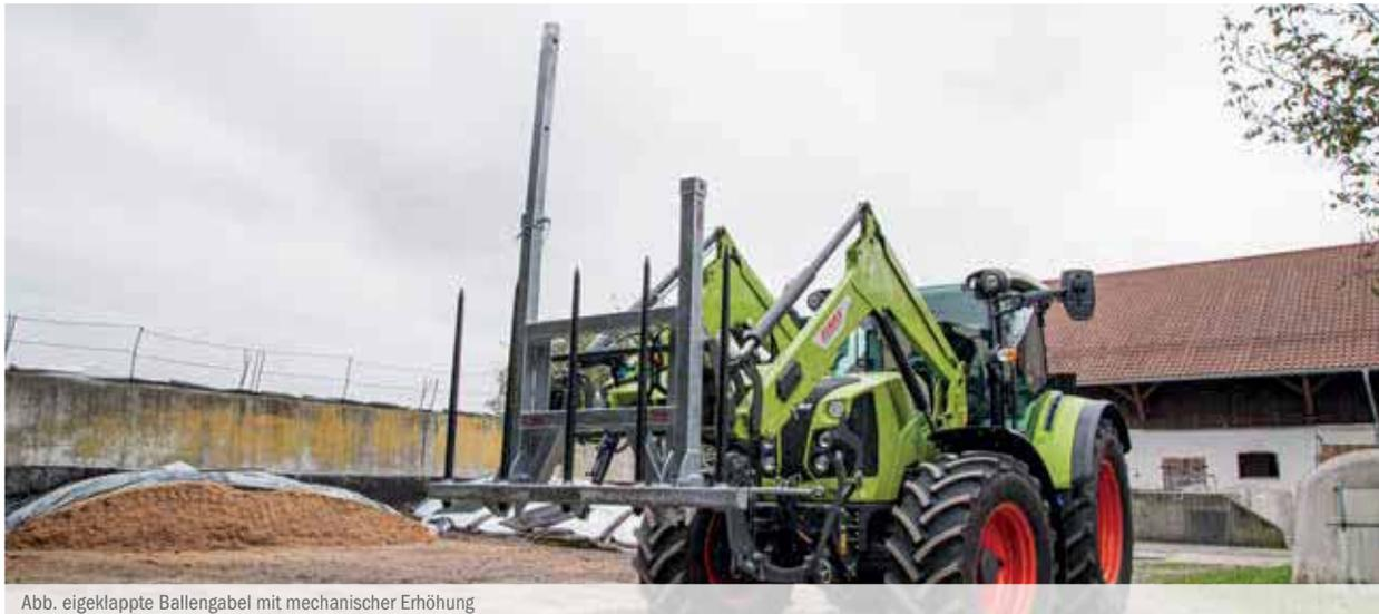
Abb. eigeklappte Ballengabel mit mechanischer Erhöhung
