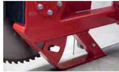
Ein Schutzbügel verhindert eine Berührung des untersten Sägeblattes mit dem Erdrich.
