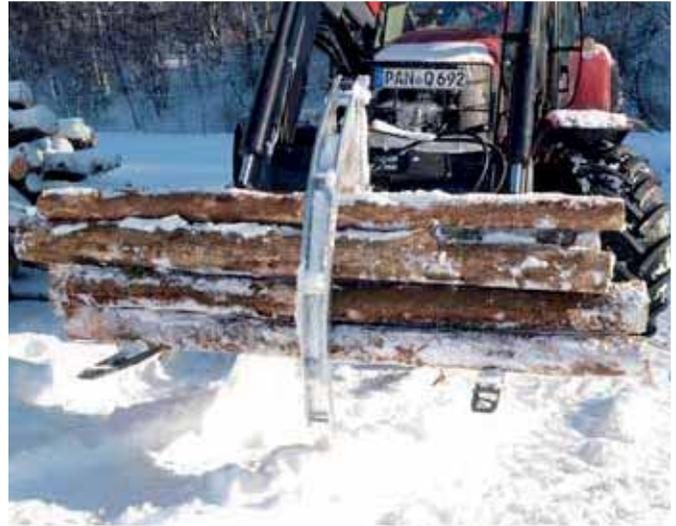
Hydraulischer Greifarm an der Staplergabel »Freisicht« befestigt
