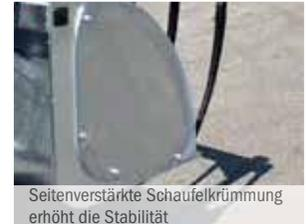
Seitenverstärkte Schaufelkrümmung erhöht die Stabilität
