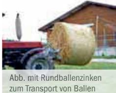
Abb. mit Rundballenzinken zum Transport von Ballen
