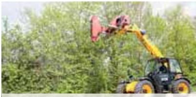
3-Blatt Astsäge am Teleskoplader mit JCB-Aufnahme
