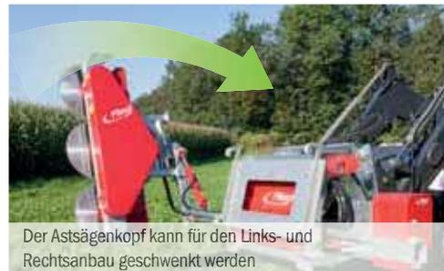
Der Astsägenkopf kann für den Links- und Rechtsanbau geschwenkt werden
