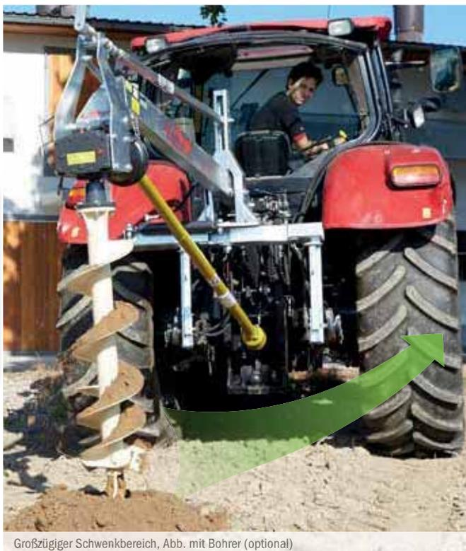
Großzügiger Schwenkbereich, Abb. mit Bohrer (optional)
