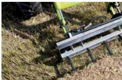
Führungsschiene mit verbauten Rundballenzinken
