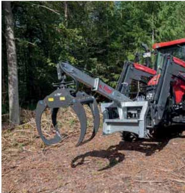
Hydraulische Rückezege LongNeck Combi mit mechanischem Drehgelenk
