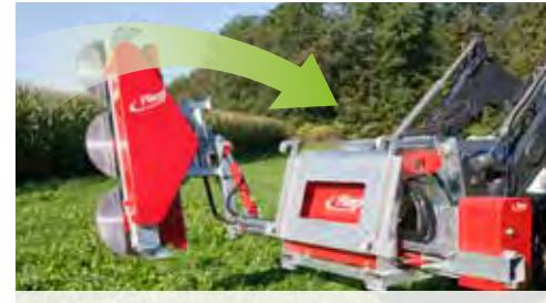
Astsägenkopf für Anbau links und rechts schwenkbar
