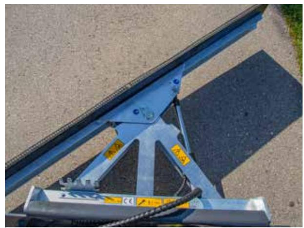
Abb. Gummileiste mit einvulkanisierten Stahldrähten (optional)
