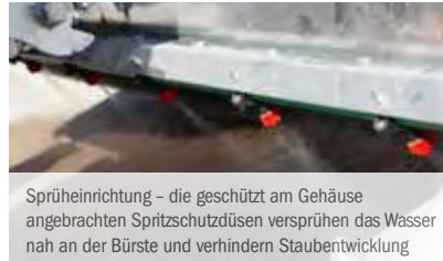
Sprühseinrichtung – die geschützt am Gehäuse angebrachten Spritzschutzdüsen versprühen das Wasser nah an der Bürste und verhindern Staubentwicklung
