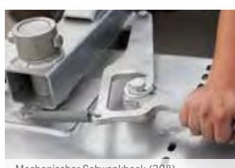
Mechanischer Schwenkbock (30°), optional mit hydraulischem Schwenkbock
