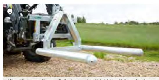
Mit seitlich verstellbarem Ballentransportgerät (nicht im Lieferumfang)
