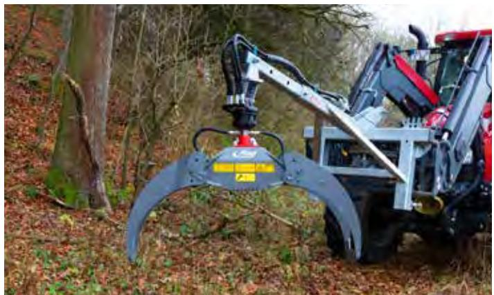
Verladezange mit Lasthakenverlängerung, Drehmotor, Euronorm- und Dreipunktaufnahme
