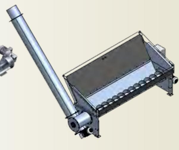
Montagebeispiel: Seitlicher Annahmetrog mit Seilsicherheitsschaltung, Schneckenverlängerung, Rohrknoten 90° (Rohr in Rohr)
