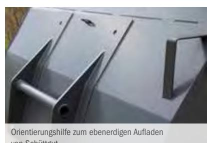
Orientierungshilfe zum ebenerdigem Aufladen von Schüttgut
