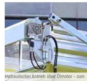
Hydraulischer Antrieb über Ölmotor - zum Einziehen des Netzes
