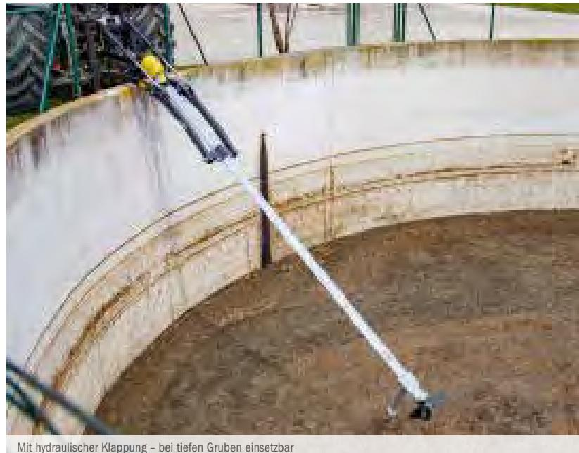
Mit hydraulischer Klappung – bei tiefen Gruben einsetzbar
