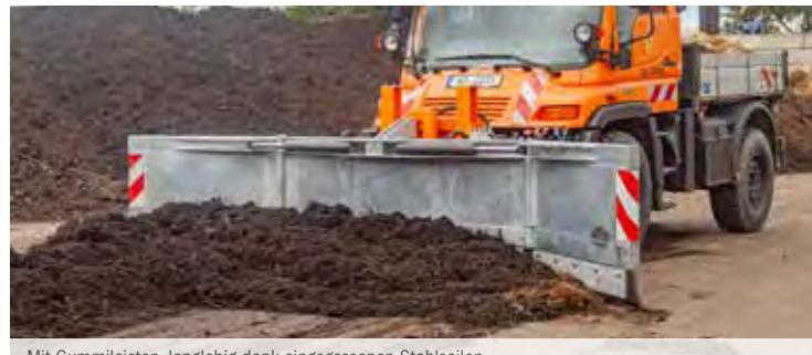
Mit Gummileisten, langlebig dank eingegossenen Stahlseilen
