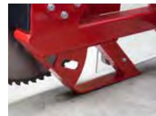
Schutzbügel verhindert Bodenkontakt des untersten Sägeblatts.
