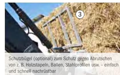
Schutzbügel (optional) zum Schutz gegen Abrutschen von z. B. Holzstapeln, Ballen, Stahlprofilen usw. – einfach und schnell nachrüstbar
