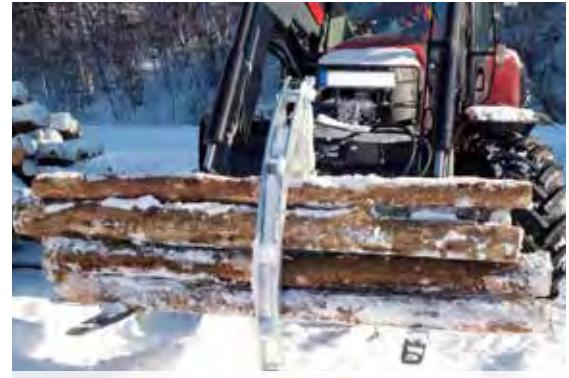
Hydraulischer Greifarm an der Kombi-Staplergabel »Freisicht« befestigt
