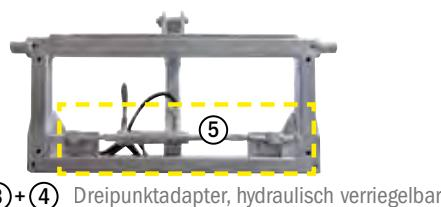
③+④ Dreipunktadapter, hydraulisch verriegelbar
