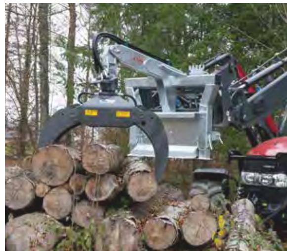
Hydraulische Rückezange »RZ 185 Combi-Plus« mit Polderschild (optional)
