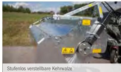
Stufenlos verstellbare Kehrwalze
