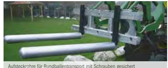
Aufsteckrohre für Rundballentransport mit Schrauben gesichert
