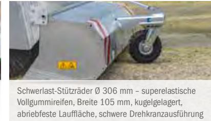
Schwerlast-Stützräder Ø 306 mm – superelastische Vollgummireifen, Breite 105 mm, kugellagert, abriebfeste Lauffläche, schwere Drehkranausführung
