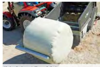
Hydraulisch verstellbarer Aufnahmearm
