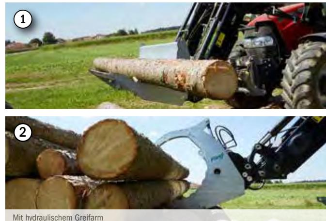
Mit hydraulischem Greifarm
