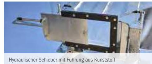
Hydraulischer Schieber mit Führung aus Kunststoff
