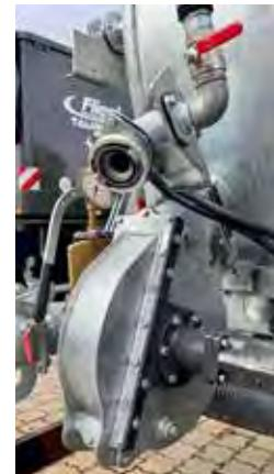
ACHTUNG: (Turbobefüller 6" oder 8") Schieberseitig immer 8" Anschluss. Bitte bei Bedarf passenden Übergang bestellen.
