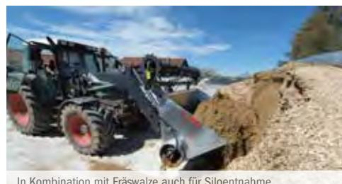
In Kombination mit Fräswalze auch für Siloentnahme
