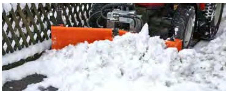
2 hydraulisch schwenkbare Flügel mit separater Ansteuerung
