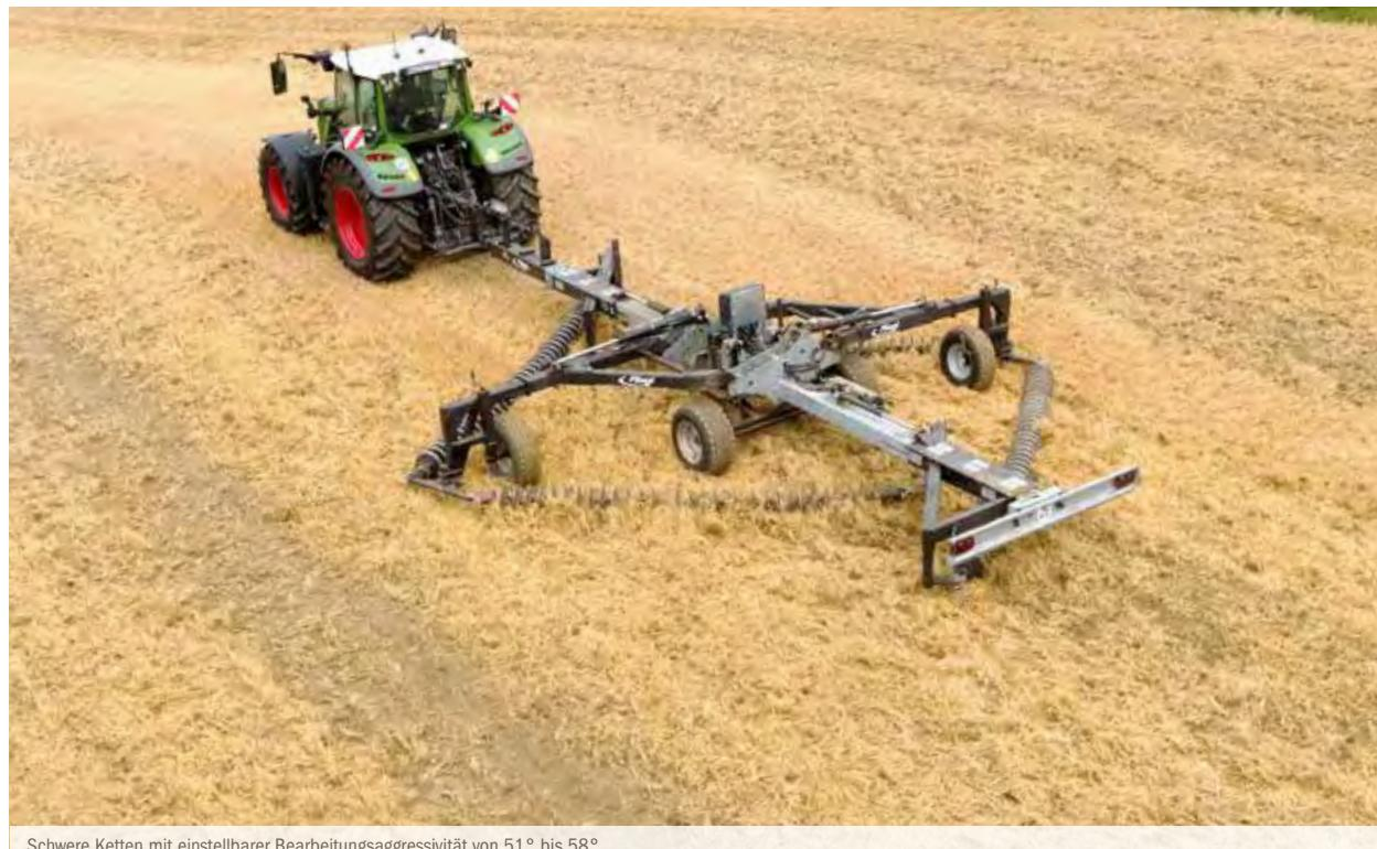
Schwere Ketten mit einstellbarer Bearbeitungsaggressivität von 51° bis 58°
