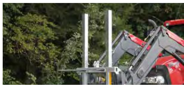
Aufsteckrohre für Ballengabel »Combi« mit Erhöhung
