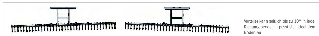
Verteiler kann seitlich bis zu 10° in jede Richtung pendeln – passt sich ideal dem Boden an
