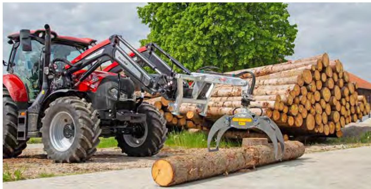
Verladezange mit Lasthakenverlängerung, Drehmotor, Euronorm- und Dreipunktaufnahme
