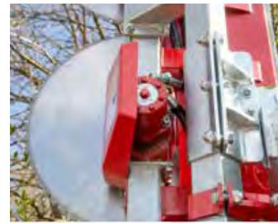
Antrieb der Sägeblätter über Ölmotore
