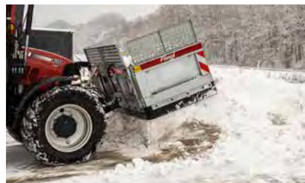
Räumbreite über die 2 Seitenflügel stufenlos einstellbar, Aufsatzgitter (optional)
