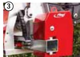
Seitliches Kontergewicht – dadurch minimale Belastung der Schwinge des Trägerfahrzeugs.
