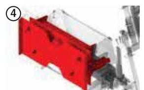
Überlastsicherung als Dämpfadapter: Bei zu hohem Anpressdruck neigt sich der Kopf nach hinten zum Schutz vor Blockieren der Sägeblätter.
