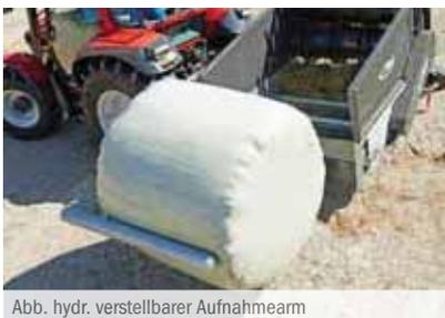
Abb. hydr. verstellbarer Aufnahmearm
