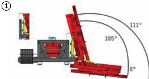
Neigevorrichtung 111° - zum Senkrecht- und Waagrechtsschneiden. Der Winkel kann dabei stufenlos eingestellt werden.
