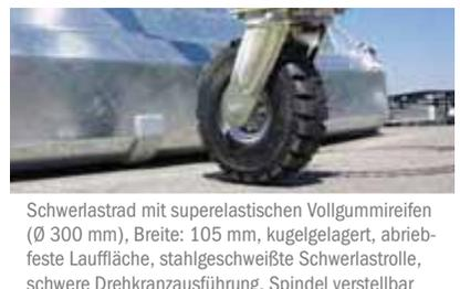
Schwerlastrad mit superelastischen Vollgummireifen (Ø 300 mm), Breite: 105 mm, kugelgelagert, abriebfeste Lauffläche, stahlgeschweißte Schwerlastrolle, schwere Drehkranzausführung, Spindel verstellbar
