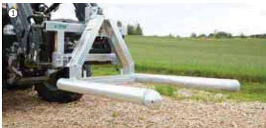
Abb. mit Ballentransportgerät seitlich verstellbar
