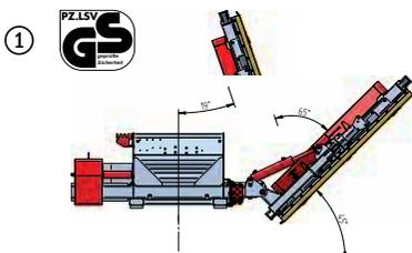
GS-Zertifizierung: Neigevorrichtung 45° – Das geprüfte Baumuster entspricht den im Produktsicherheitsgesetz (ProdSG) genannten Anforderungen sowie dem derzeitigen Erfahrungsstand der Unfallverhütung.
