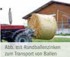
Abb. mit Rundballenzinken zum Transport von Ballen
