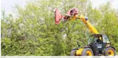
3-Blatt Astsäge am Teleskoplader mit JCB-Aufnahme
