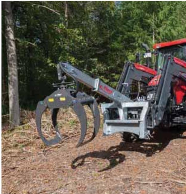
Hydraulische Rückezege LongNeck Combi mit mechanischem Drehgelenk
