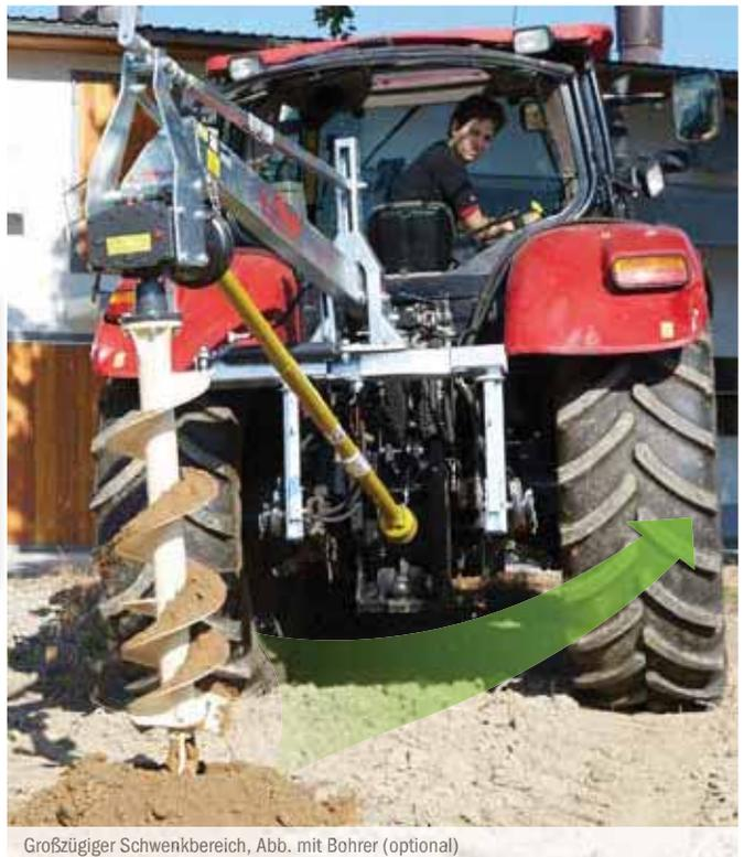
Großzügiger Schwenkbereich, Abb. mit Bohrer (optional)
