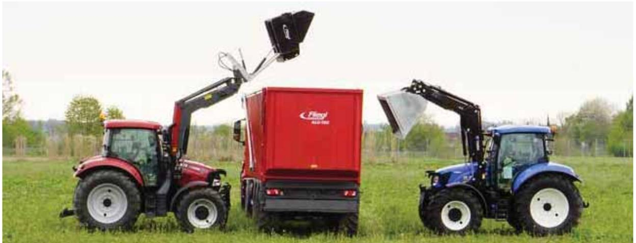
Darstellung der unterschiedlichen Kipphöhen bei gleichem Frontlader
