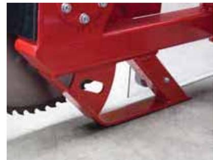
Ein Schutzbügel verhindert eine Berührung des untersten Sägeblattes mit dem Erdbreich.
