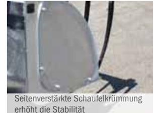
Seitenverstärkte Schaufelkrümmung erhöht die Stabilität
