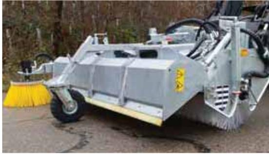
Steuerbarer Freikehrmodus durch hydr. Steuerblock
