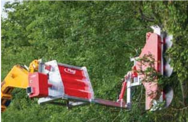
Abb.: Verwendung bei Teleskoplader mit Linksanbau
