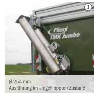
Ø 254 mm - Ausführung im eingeklappten Zustand
