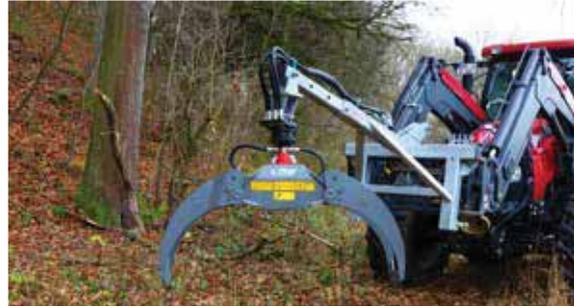
Abb. Verladezange mit Lashakenverlängerung (Euro-Dreipunktaufnahme) und Drehmotor
