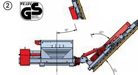
GS-Zertifizierung: Neigevorrichtung 45° - Das geprüfte Baumuster entspricht den im Produktsicherheitsgesetz (ProdSG) genannten Anforderungen sowie dem derzeitigen Erfahrungsstand der Unfallverhütung.
