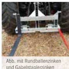
Abb. mit Rundballenzinken und Gabelstaplerzinken
