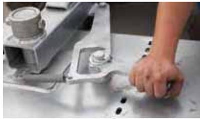
Schwenkbock mechanisch (30° nach links und rechts)
