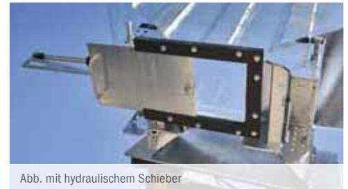
Abb. mit hydraulischem Schieber
