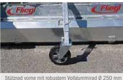
Stützrad vorne mit robustem Vollgummirad Ø 250 mm
