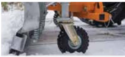
Schwerlastrad mit superelastischen Vollgummireifen (Ø 306 mm), Breite: 105 mm, kugelgelagert, abriebfeste Lauffläche, stahlgeschweißte Schwerlastrolle, schwere Drehkranausführung, Spindel verstellbar
