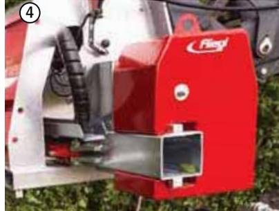
Seitliches Kontergewicht - dadurch minimale Belastung der Schwinde des Trägerfahrzeugs.
