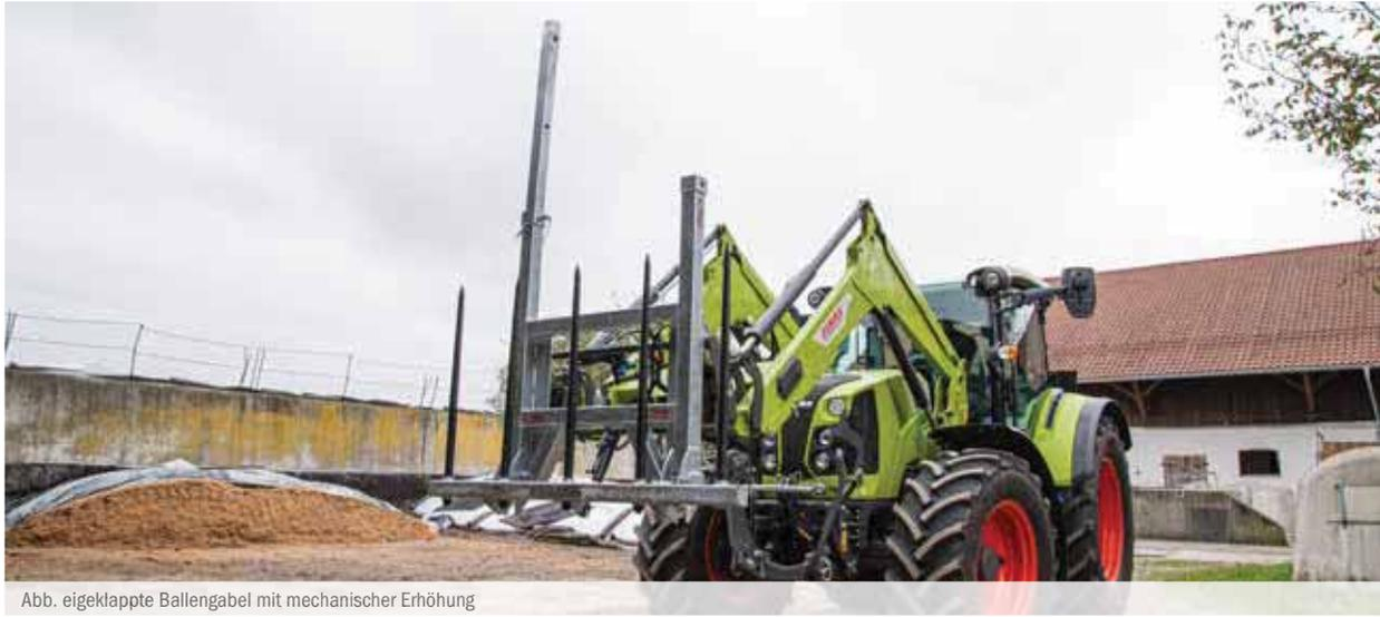
Abb. eigeklappte Ballengabel mit mechanischer Erhöhung
