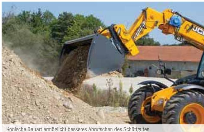
Konische Bauart ermöglicht besseres Abrutschen des Schüttgutes
