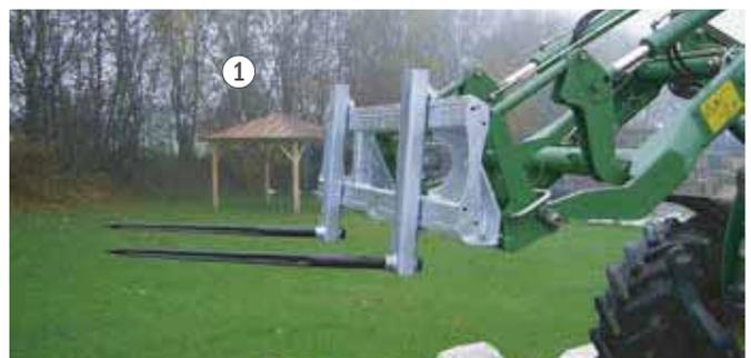
Verstellbare Aufnahme für Rundballenzinken (Schwerlastzinken; M28 x 1,5).
