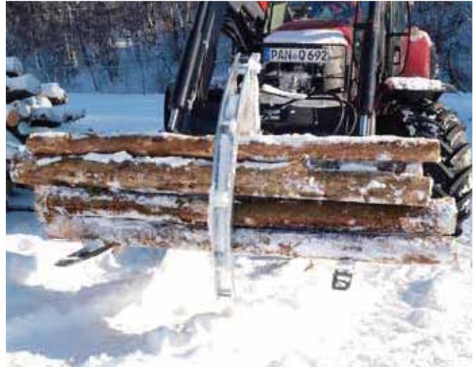
Hydraulischer Greifarm an der Staplergabel »Freisicht« befestigt
