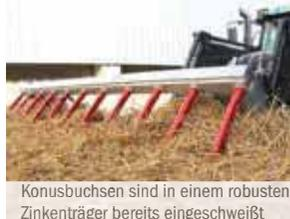
Konusbuchsen sind in einem robusten Zinkenträger bereits eingeschweißt
