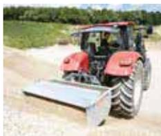
Abb. Pendelwand nach oben geklappt
