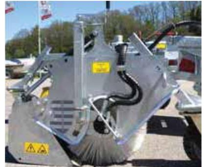
Durch eine Spindel ist der Kehrbesen stufenlos verstellbar und bis zur äußersten Verschleißgrenze abnutzbar.
