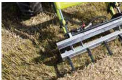
Führungsschiene mit verbauten Rundballenzinken
