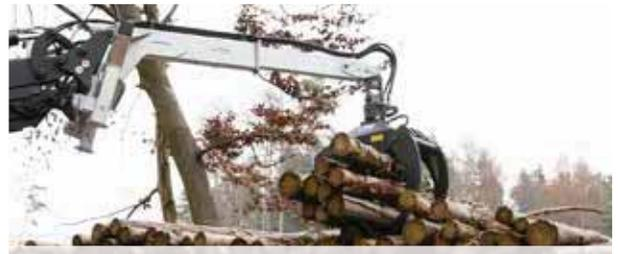
Hydraulische Rückezege LongNeck Combi Plus mit Endlosdrehmotor
