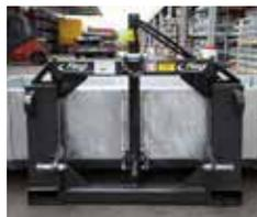
Aufnahmemöglichkeiten: Euronorm- und Dreipunkt- sowie Stapleraufnahme
