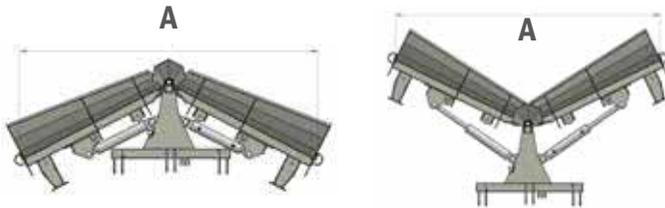
Mit integriertem Umschaltventil zur einzelnen Ansteuerung der Zylinder.
