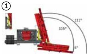
Neigevorrichtung 111° – zum Senkrecht- und Waagrechtsschneiden. Passen Sie den Winkel stufenlos den Gegebenheiten an.
