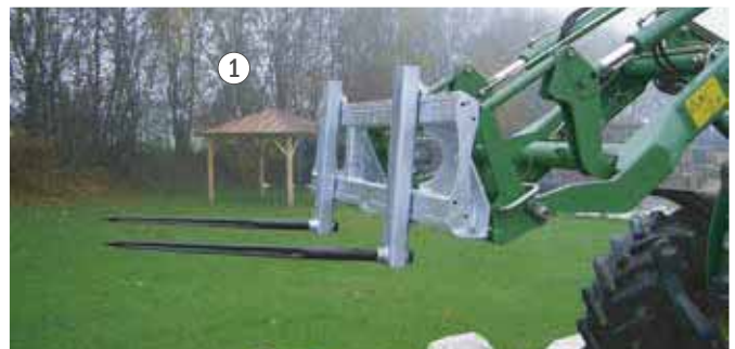
Verstellbare Aufnahme für Rundballenzinken (Schwerlastzinken; M28 x 1,5).
