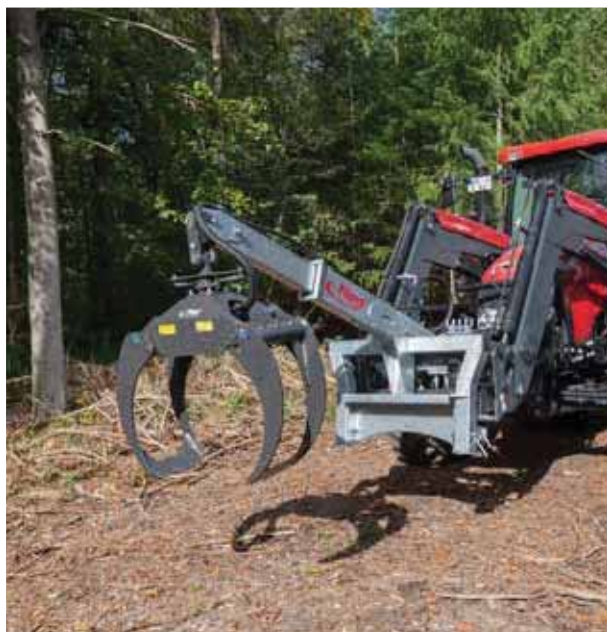
Hydraulische Rückezange LongNeck Combi mit mechanischem Drehgelenk
