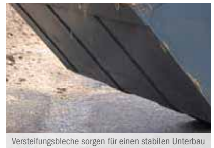
Versteifungsbleche sorgen für einen stabilen Unterbau
