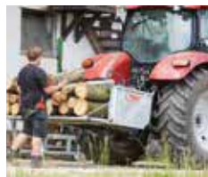
Ausklappbare Pendelwand dient als Muldenverlängerung
