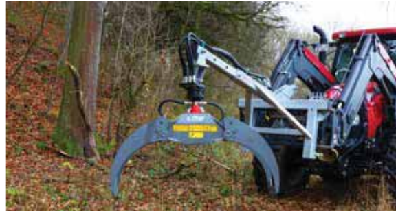
Abb. Verladezange mit Lashakenverlängerung (Euro-Dreipunktaufnahme) und Drehmotor
