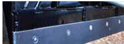
Geschraubte Schürfleiste, keine überstehende Schrauben
