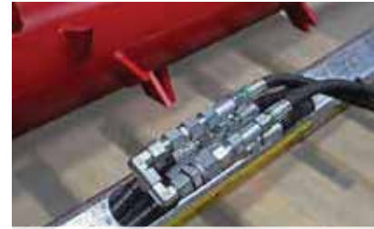
Schlauchführung innenliegend, robuste Halterohre, dadurch bester Schutz für Schläuche
