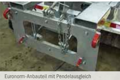
Euronorm-Anbauteil mit Pendelausgleich
