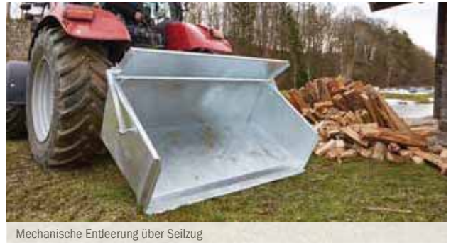
Mechanische Entleerung über Seilzug
