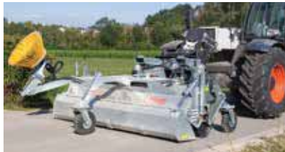
KEH Typ 500 mit Dreipunktaufnahme, hydraulische Schmutzsammelwanne, Seitenbesen und Frontstützrad
