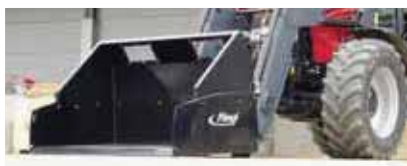
Aufbau mit Sichtausschnitt für maximales Volumen
