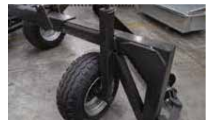
Massives Stützrad verstellbar
