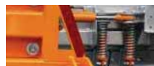
Überlastsicherung durch Federklappen gewährleistet beschadigungsfreies Fahren
