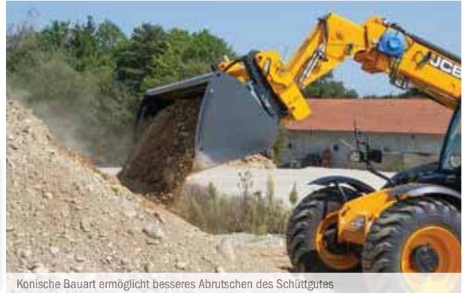
Konische Bauart ermöglicht besseres Abrutschen des Schüttgutes
