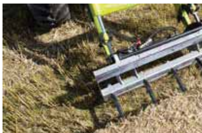
Führungsschiene mit verbauten Rundballenzinken
