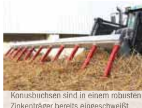
Hochfeste, robuste Schürfleiste schont den Schaufelunterbau
