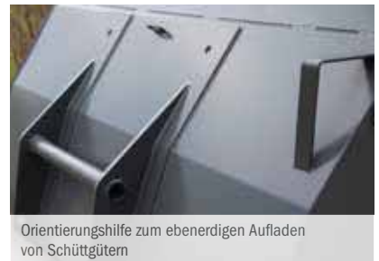
Versteifungsbleche sorgen für einen stabilen Unterbau
