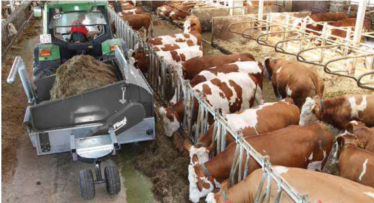
Abb. mit Fahrwerk dadurch optimale Gewichtsverteilung und Entlastung der Schlepperhydraulik
