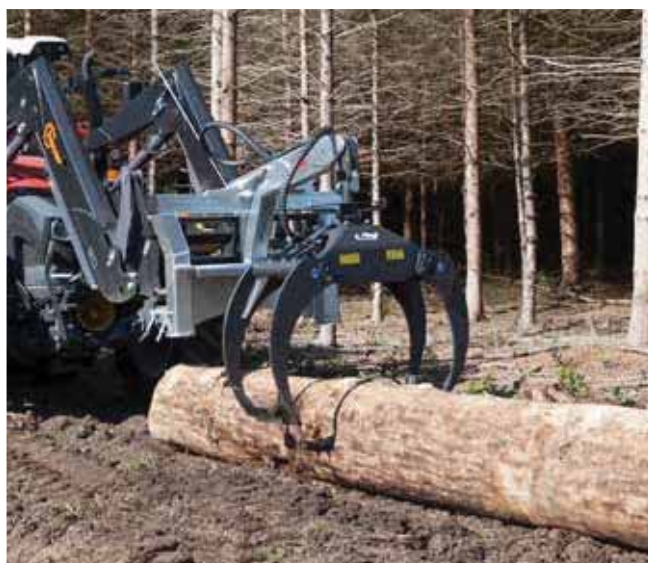
Hydr. Rückezege Combi RZ 185 mit mechanischem Drehgelenk
