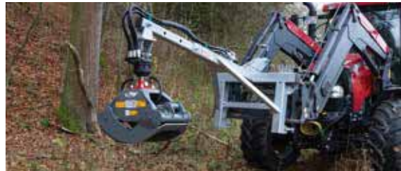
Abb. Verladezange mit Lashakenverlängerung (Euro-Dreipunktaufnahme) und Drehmotor
