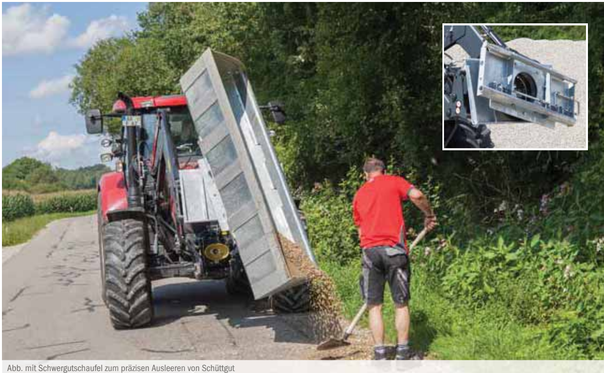
Abb. mit Schwergutschaufel zum präzisen Ausleeren von Schüttgut
