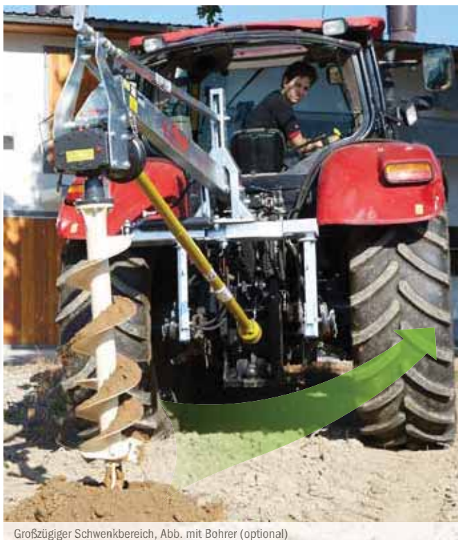
Großzügiger Schwenkbereich, Abb. mit Bohrer (optional)
