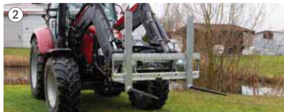
Verstellbare Aufnahme für Rundballenzinken (Schwerlastzinken; M28 x 1,5).
