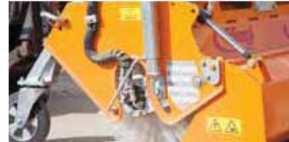
Stufenlose Kehrbesenverstellung durch Stützspindel
