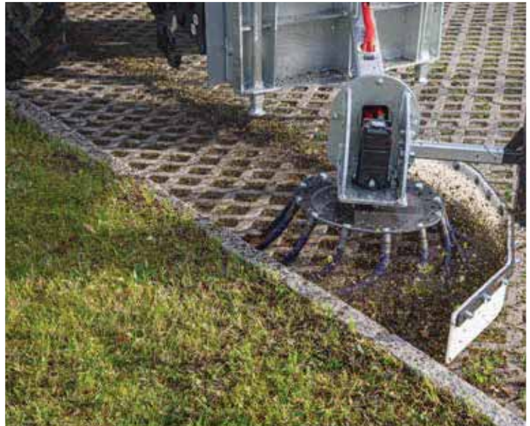
Beste Wildkrautentfernung durch ummantelte Stahlbürsten
