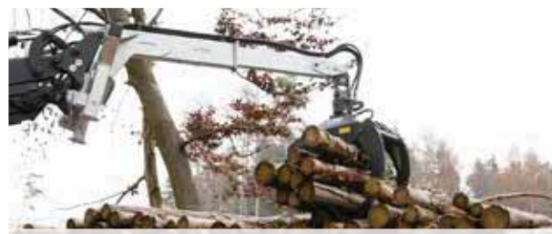
Hydraulische Rückezange LongNeck Combi Plus mit Endlosdrehmotor
