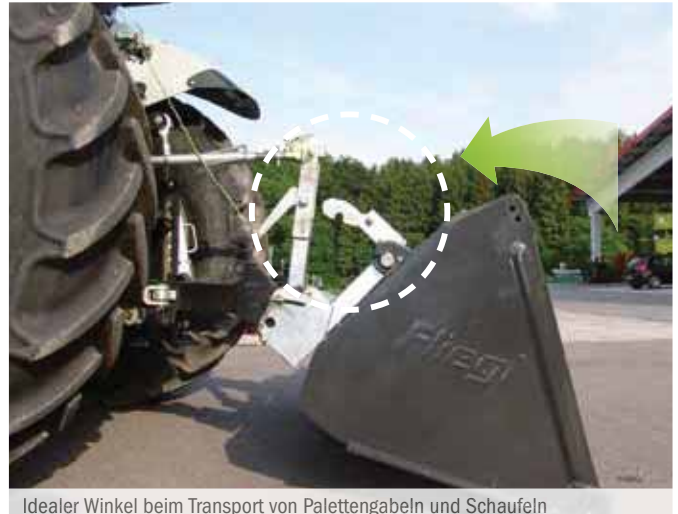
Idealer Winkel beim Transport von Palettengabeln und Schaufeln
