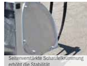
Hochfeste, robuste Schürfleiste schont den Schaufelunterbau
