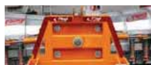
Innovativer Dreipunktbock - gleicht Bodenunebenheiten aus
