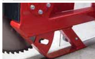
Un arceau de sécurité empêche tout contact de la lame de scies inférieure avec le sol.
