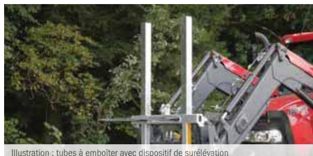
Illustration : tubes à emboîter avec dispositif de surélévation
