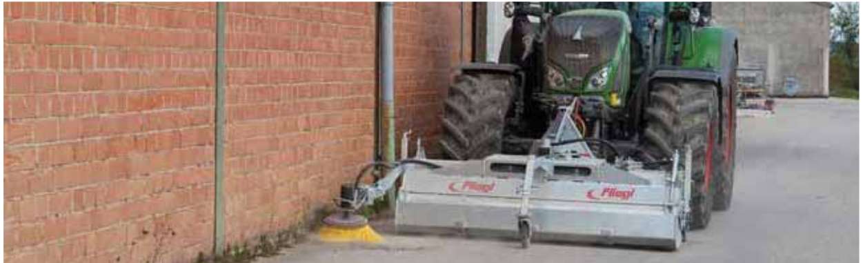
KEH Type 500 avec attelage trois points, cuve de collecte des déchets hydraulique, balai latéral et roue porteuse avant
