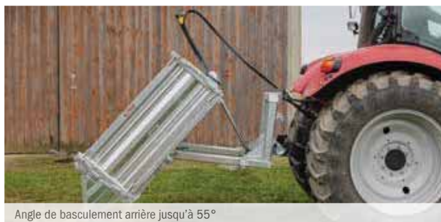
Angle de basculement arrière jusqu'à 55°
