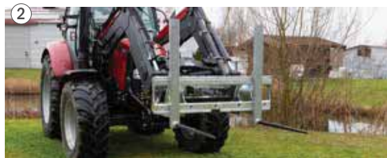
Système de fixation ajustable pour broches pour balles rondes (broches lourdes charges ; M28 x 1,5).
