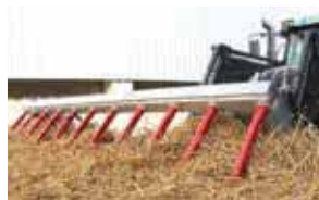
Les douilles coniques sont présoudées dans un support pour broches solide
