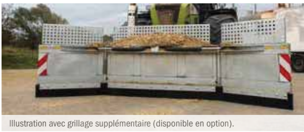
La largeur de déblayage peut être réglée en continu dans la zone définie à l'aide des deux panneaux latéraux. Utilisation optimale avec drapeaux de signalisation.
