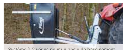
Système à 2 vérins pour un angle de basculement optimal de 111°
