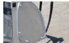
La courbure de la bennette renforcée latéralement augmente la stabilité
