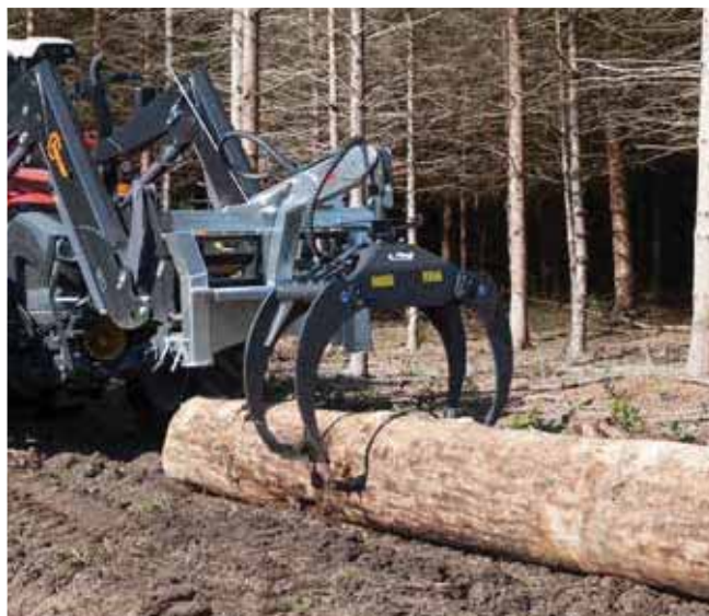
Grappin hydr. Combi RZ 185 avec articulation pivot mécanique
