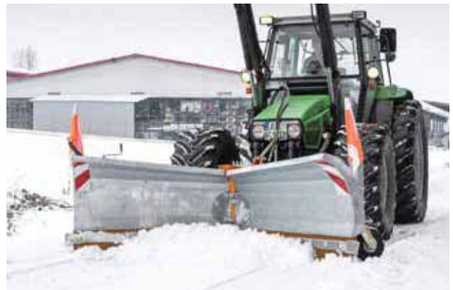
2 panneaux à inclinaison hydraulique - peuvent être commandés séparément pour choisir des positions individuelles en équerre, en chasse-neige ou en V.
