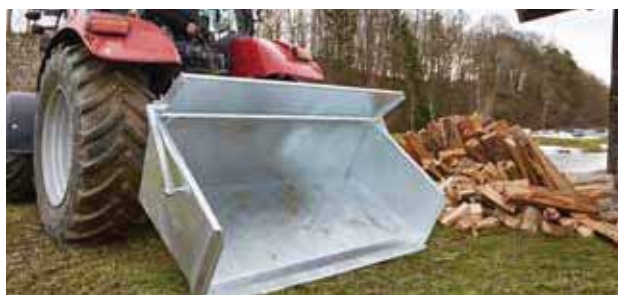
Déversement mécanique par câble de commande
