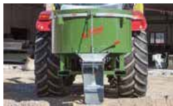
Illustration : glissière de décharge pivotante
