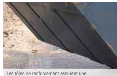
Les tôles de renforcement assurent une sous-structure stable
