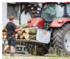
La paroi pendulaire rabattable peut servir de rallonge à la benne
