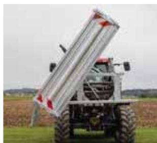
Angle de basculement latéral jusqu'à 50°
