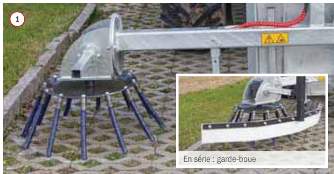
Meilleure élimination des mauvaises herbes grâce aux brosses d'acier gainées
