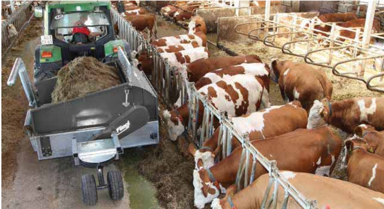
Illustration avec châssis permettant d'optimiser la répartition du poids et de décharger le système hydraulique du tracteur
