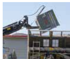
Angle de basculement jusqu'à 71° env. !
