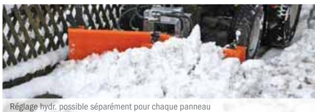
Réglage hydr. possible séparément pour chaque panneau
