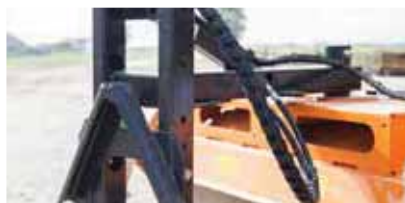
Illustration : Cat. communale : attelage universel et réglable en hauteur pour Cat. communale, Cat. 0 et Cat. I
