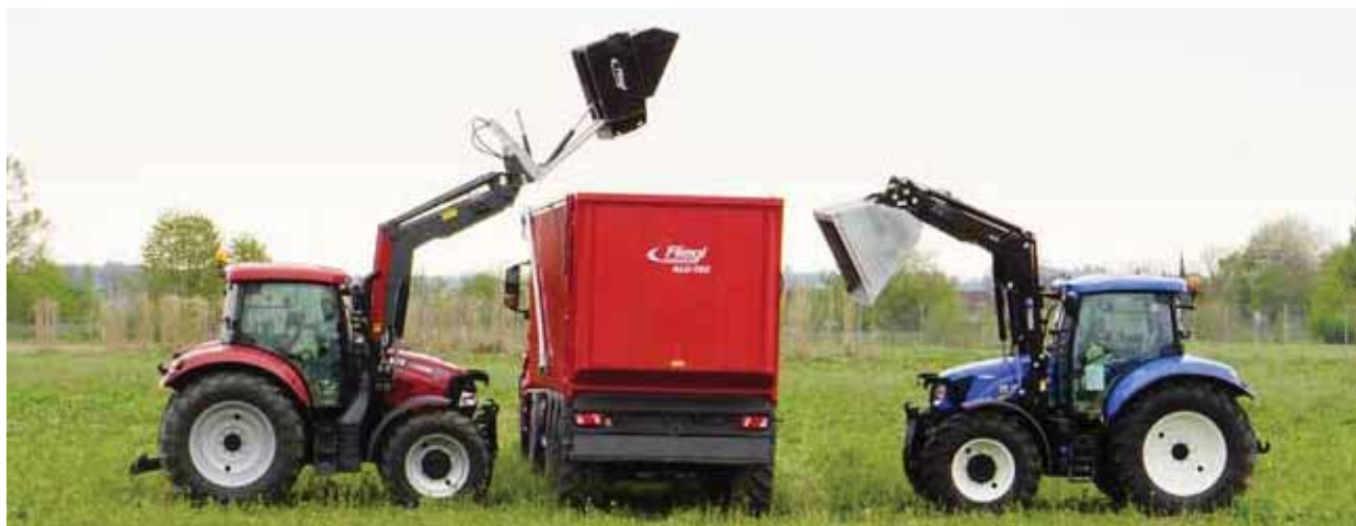
Représentation des différentes hauteurs de basculement avec le même chargeur frontal
