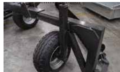
Roue porteuse massive réglable
