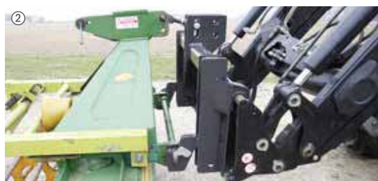
Illustration avec pique botte élévateur réglable latéralement
