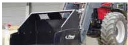
Structure avec découpe de visibilité pour volume maximum
