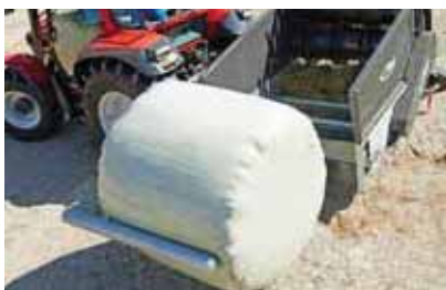
Illustration : bras de chargement à réglage hydr.
