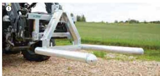
Illustration avec pique botte élévateur réglable latéralement
