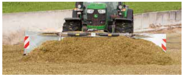
La largeur de déblayage peut être réglée en continu dans la zone définie à l'aide des deux panneaux latéraux. Utilisation optimale avec drapeaux de signalisation.
