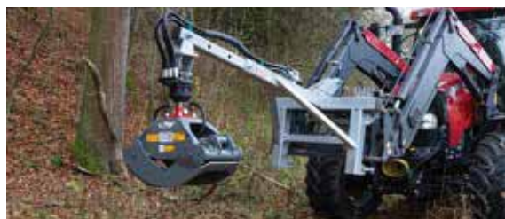
Illustration : pince de transbordement avec rallonge pour crochet de suspension (attelage trois points aux normes européennes) et moteur coupleur
