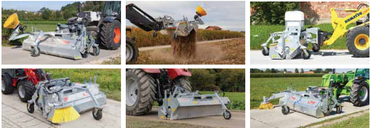
KEH Type 500 avec attelage trois points, cuve de collecte des déchets hydraulique, balai latéral et roue porteuse avant
