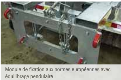
Module de fixation à un chariot élévateur avec équilibrage pendulaire
