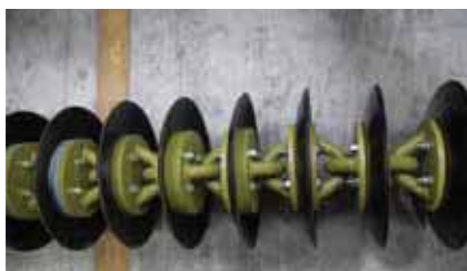
Disques en acier résistants à l'usure écartés de 130 mm
