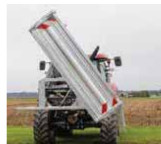
Angle de basculement latéral jusqu'à 50°
