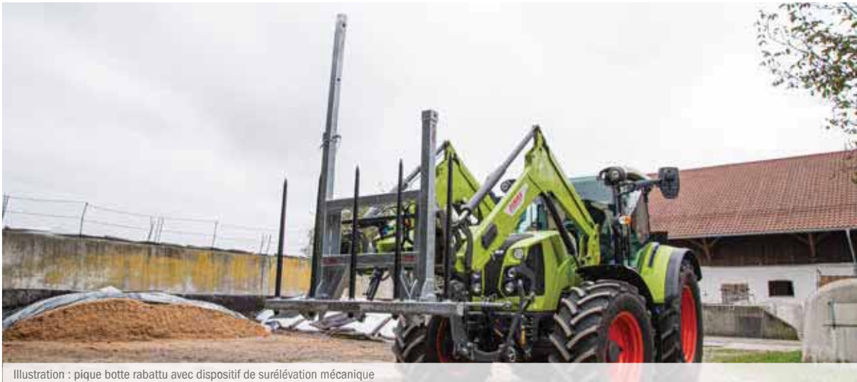
Illustration : pique botte rabattu avec dispositif de surélévation mécanique
