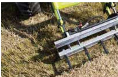
Rail de guidage avec broches pour balle ronde montées
