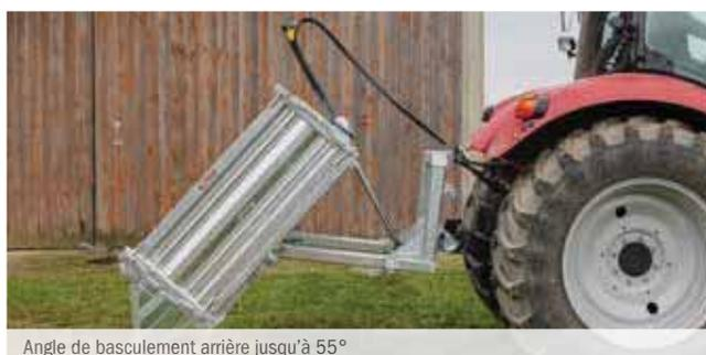
Angle de basculement arrière jusqu'à 55°
