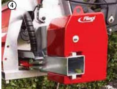
Contrepoids latéral - charge minimisée sur le balancier du véhicule porteur.
