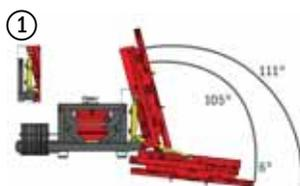
Dispositif d'inclinaison à 111° - pour coupes verticales et horizontales. Ajustez l'angle progressivement en fonction de la situation.
