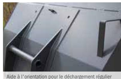
Aide à l'orientation pour le déchargement régulier sur le sol des matériaux en vrac
