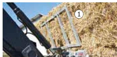
La fourche à palette « Freisicht » avec arceau de sécurité assure la protection anti-glissement, par ex. pour les tas de bois, balles, profils en acier, etc. Installation a posteriori rapide et facile !
