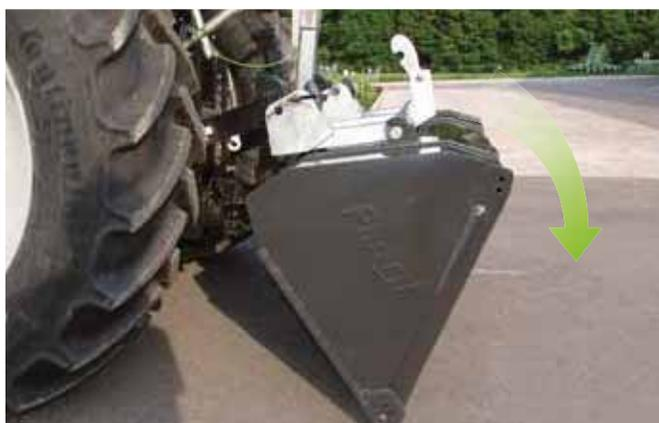
Illustration : mécanisme d'encliquetage
