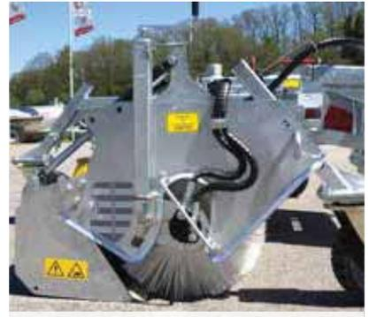
Grâce à une broche, le balai est réglable en continu et utilisable jusqu'à usure complète.
