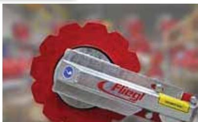
Couvercle de protection du moteur hydraulique
