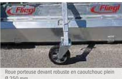
Roue porteuse devant robuste en caoutchouc plein Ø 250 mm
