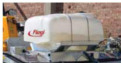
Réservoir d'eau 300 l pour le dispositif d'arrosage
