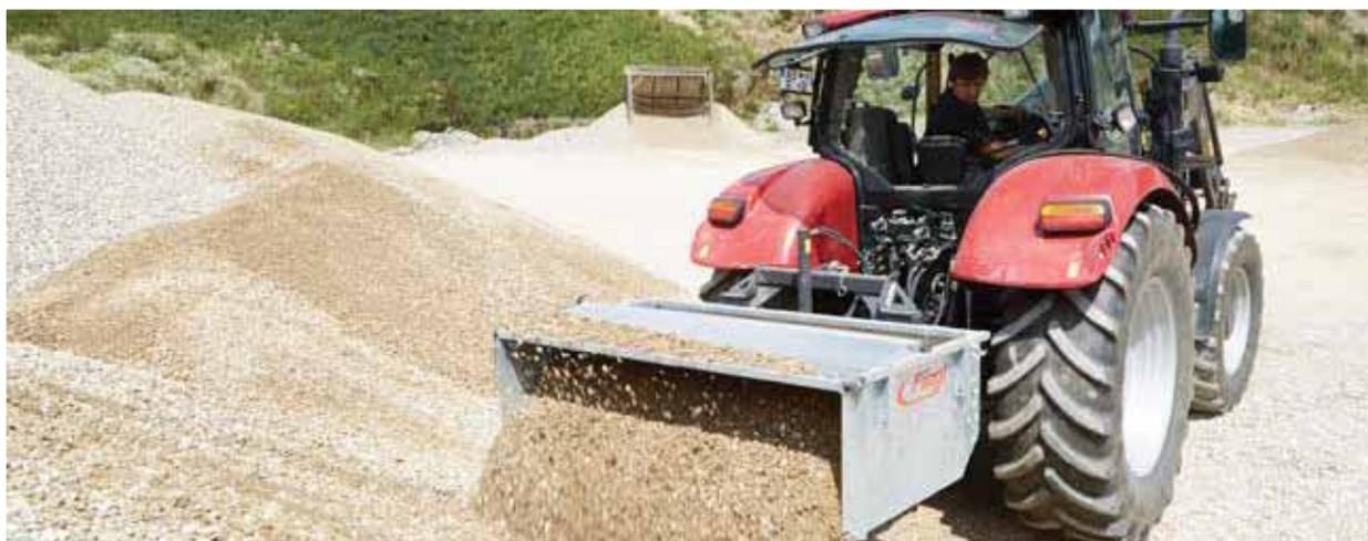
Pour charger une benne par ex. avec des céréales, des engrais chimiques, etc. Le bras d'extension particulièrement long permet d'atteindre une hauteur de basculement très élevée.
